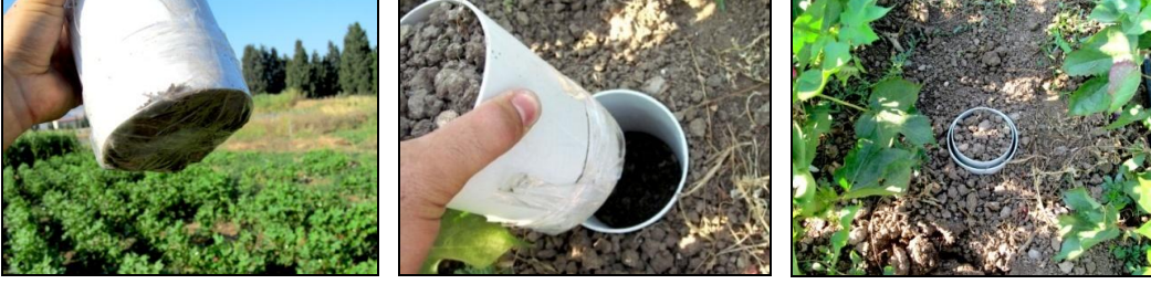
Şekil 3.7. Evaporasyon miktarının ölçülmesinde kullanılan mikro-lisimetrelere ait bazı görüntüler.
