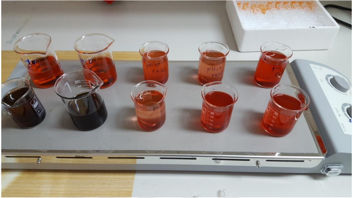
Şekil 3.2. Deneysel çalışmalarda kullanılan Mika marka çok noktalı manyetik karıştırıcı.
