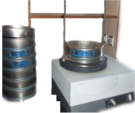
Şekil 3.5. Çalışmada kullanılan elek ve sarsma sistemi
