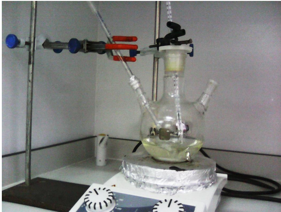
Şekil 3.5. P-(AN-ko-VA) polimerinin hidrojenasyonu düzeneği
