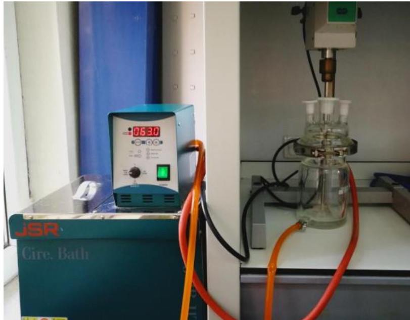
Şekil 3.4. Polimer sentezi için kurulan düzenek
