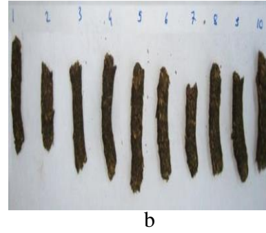
Şekil 4.17. P3 peleti sıkıştırma direnci test öncesi (a) ve sonrası (b) görünümleri
