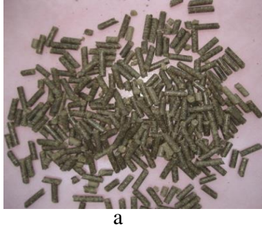
Şekil 4.5. S2 peleti dayanıklılık direnci test öncesi (a) ve sonrası (b) görünüşleri
