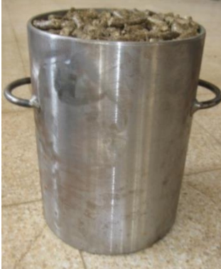
Şekil 3.20. Pelet hacim yoğunluğunun belirlenmesi
