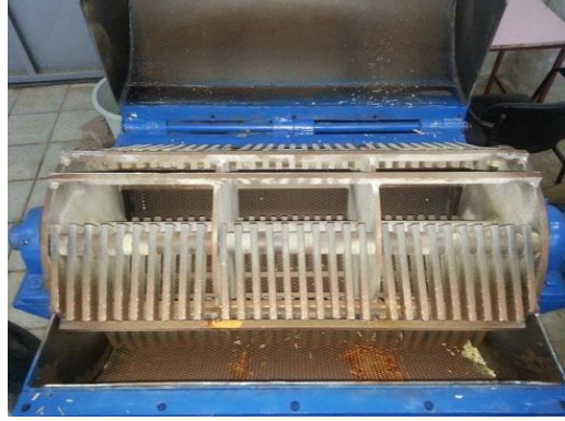
Şekil 3.3. Çekiçli değirmen genel görünüşü ve öğütme ünitesi
