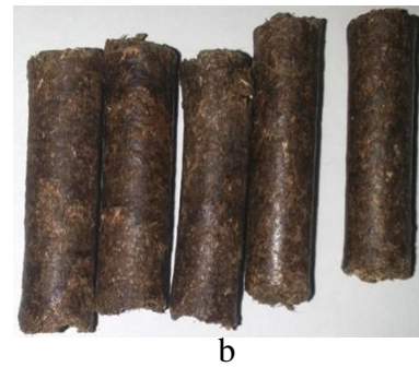
Şekil 4.30. P1 peleti nem alma direnci test öncesi (a) ve sonrası (b) görünüşleri
