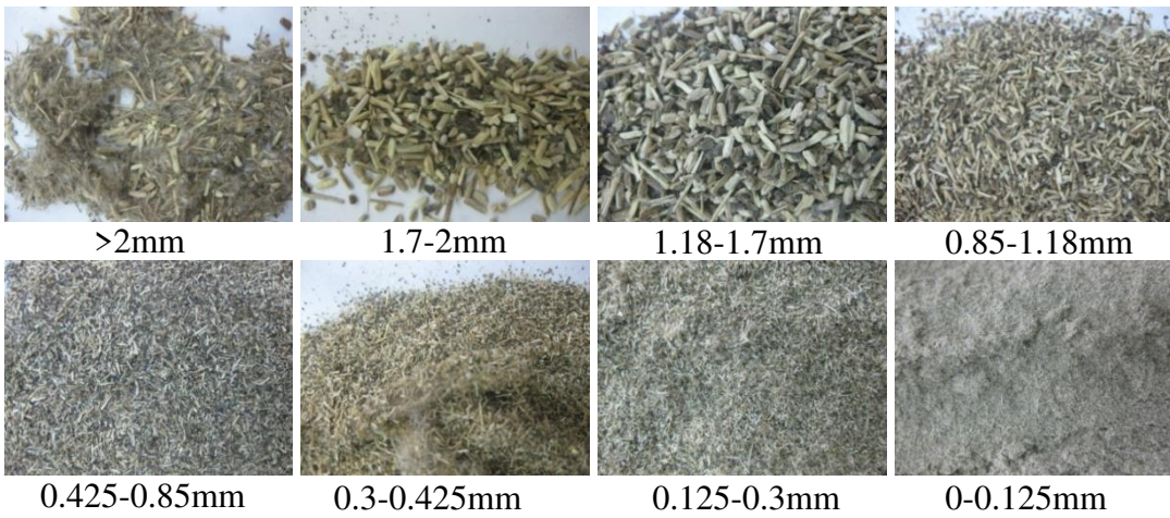
Şekil 3.18. Elek analizi sonrası öğütülmüş pamuk saplarının boyut dağılımı
