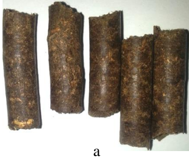
Şekil 4.31. P2 peleti nem alma direnci test öncesi (a) ve sonrası (b) görünümüleri
