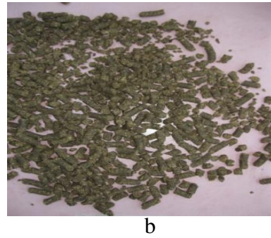
Şekil 4.3. P3 peleti dayanıklılık direnci test öncesi (a) ve sonrası (b) görünümü
