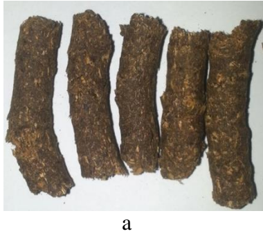
Şekil 4.32. P3 peleti nem alma direnci test öncesi (a) ve sonrası (b) görünümüleri
