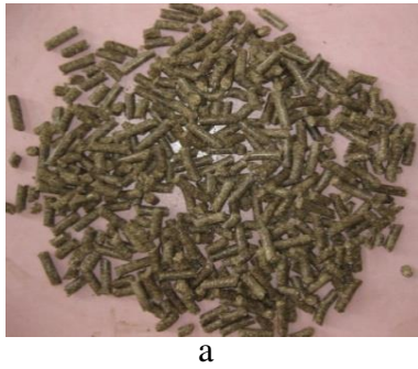
Şekil 4.6. S3 peleti dayanıklılık direnci test öncesi (a) ve sonrası (b) görünüşleri
