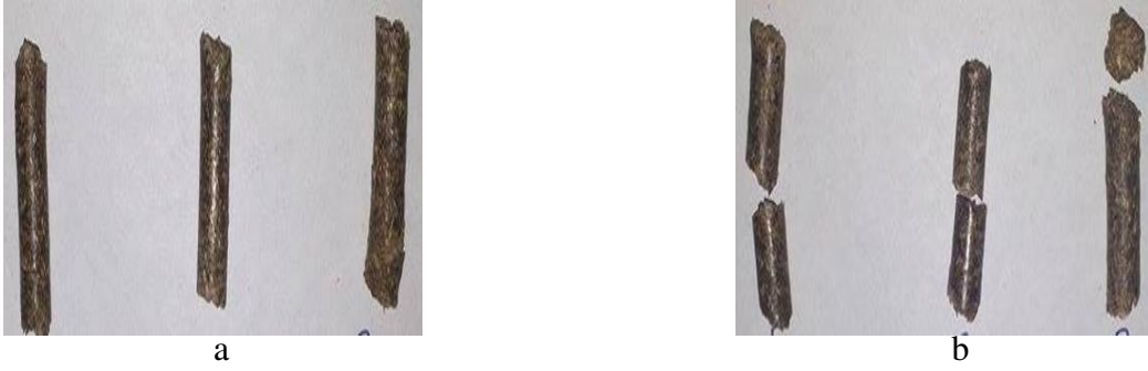
Şekil 4.14. S3 peleti kırılma direnci test öncesi (a) ve test sonrası (b) görünümüleri
