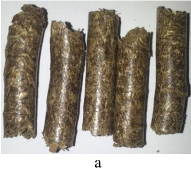
Şekil 4.35. S3 peleti nem alma direnci test öncesi (a) ve sonrası (b) görünüşleri
