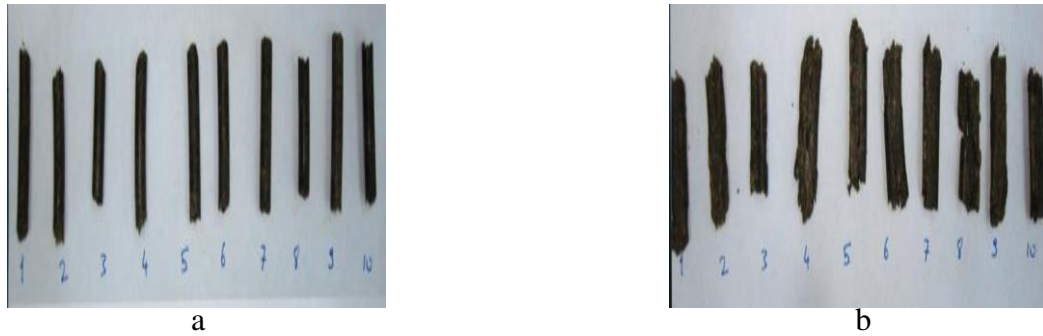
Şekil 4.15. P1 peleti sıkıştırma direnci test öncesi (a) ve sonrası (b) görünümleri
