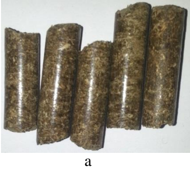
Şekil 4.34. S2 peleti nem alma direnci test öncesi (a) ve sonrası (b) görünüşleri
