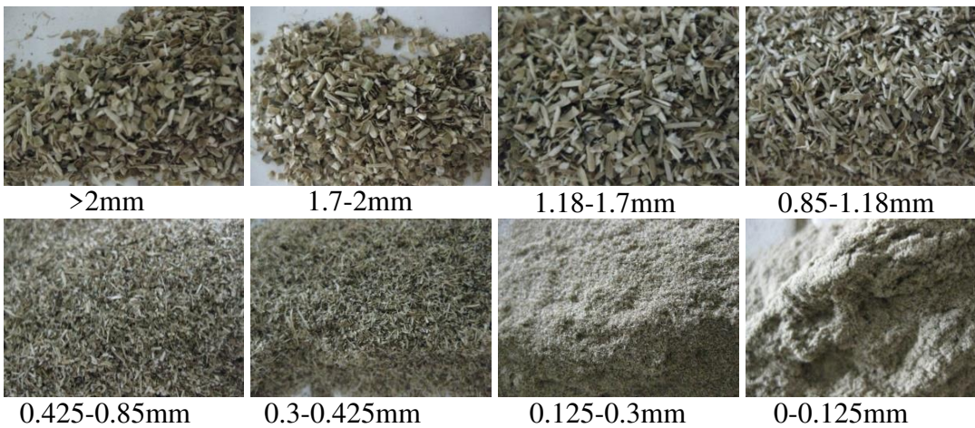
Şekil 3.19. Elek analizi sonrası öğütülmüş susam saplarının boyut dağılımı
