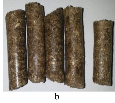
Şekil 4.34. S2 peleti nem alma direnci test öncesi (a) ve sonrası (b) görünüşleri
