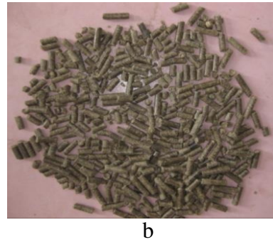
Şekil 4.4. S1 peleti dayanıklılık direnci test öncesi (a) ve sonrası (b) görünümü
