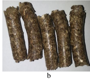
Şekil 4.35. S3 peleti nem alma direnci test öncesi (a) ve sonrası (b) görünüşleri
