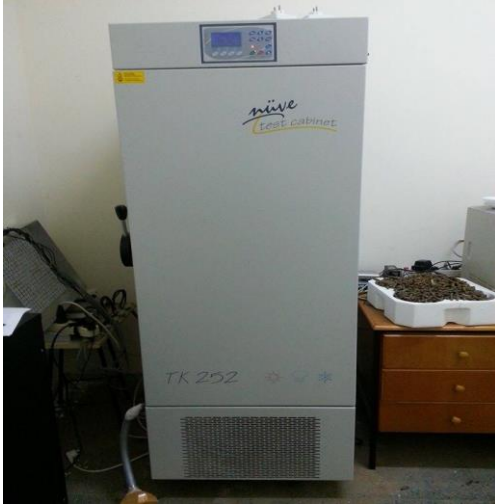
Şekil 3.10. İklimlendirme test kabini
