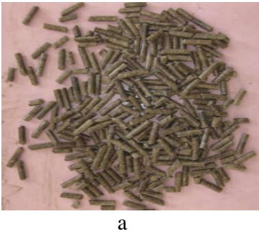
Şekil 4.4. S1 peleti dayanıklılık direnci test öncesi (a) ve sonrası (b) görünümü
