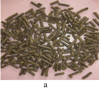
Şekil 4.2. P2 peleti dayanıklılık direnci test öncesi (a) ve sonrası (b) görünümü
