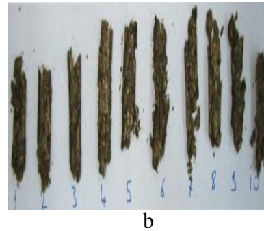
Şekil 4.18. S1 peleti sıkıştırma direnci test öncesi (a) ve sonrası (b) görünümleri
