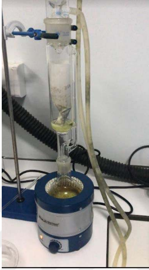
Şekil 3.1. Ekstraksiyonu yapılan bitkilerin soxhlet cihazındaki görüntüsü
