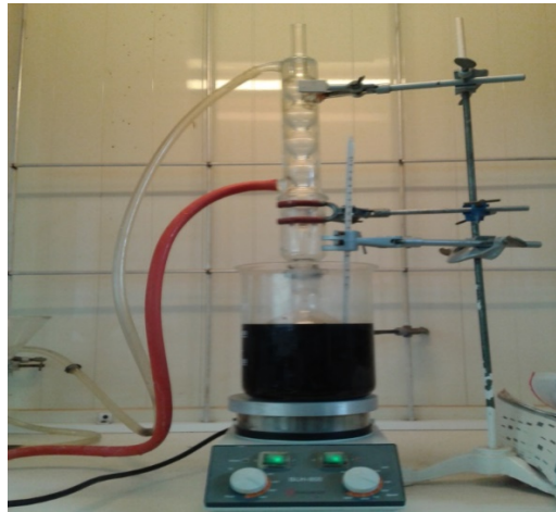
Şekil 3.2. Reflux yöntemle S-TiO 2 'nin sentez şeması
