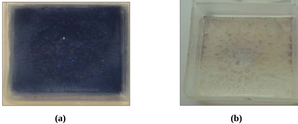
Şekil 4.11. a) Işınlama öncesi, b) 60 dk fotokatalitik parçalanma sonrası RB 5 çözeltilerinin görüntüsü
