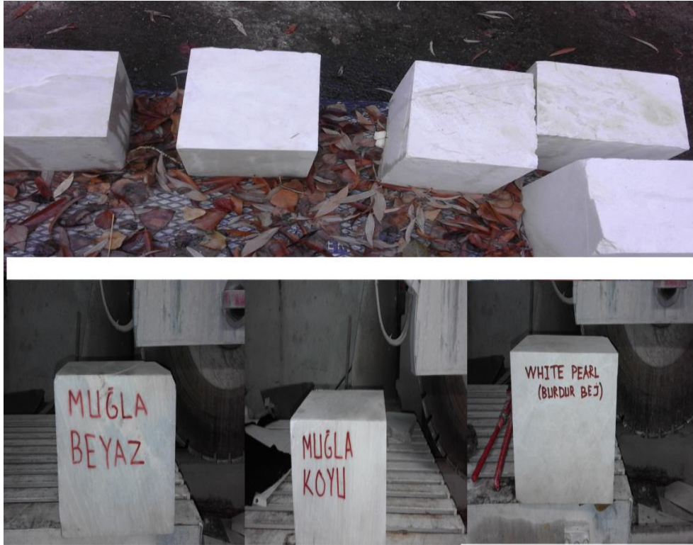
Şekil 4. 2 20cm*20cm*25cm ebatlarında boyutlandırılmış numunelerin bazılarının görünümü
