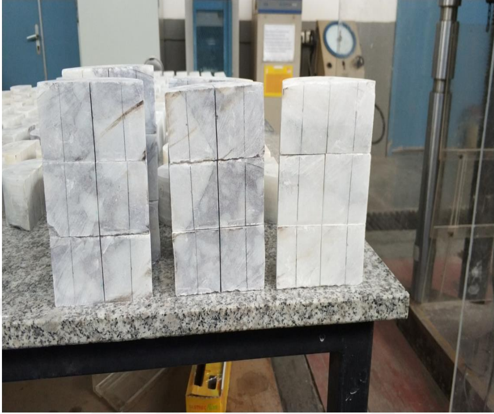
Şekil 4. 9 Yükleme noktalarının işaretlenmesi
