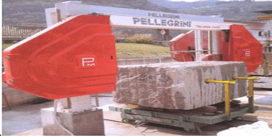
Şekil 2. 4 Doğal taş işletmeciliğinde kullanılan tek telli kesme makinesi (monotel) [27]
