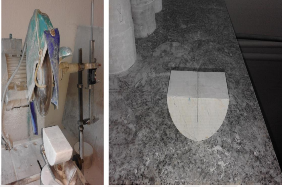
Şekil 4. 7 Dairesel testere ve çentikli numune
