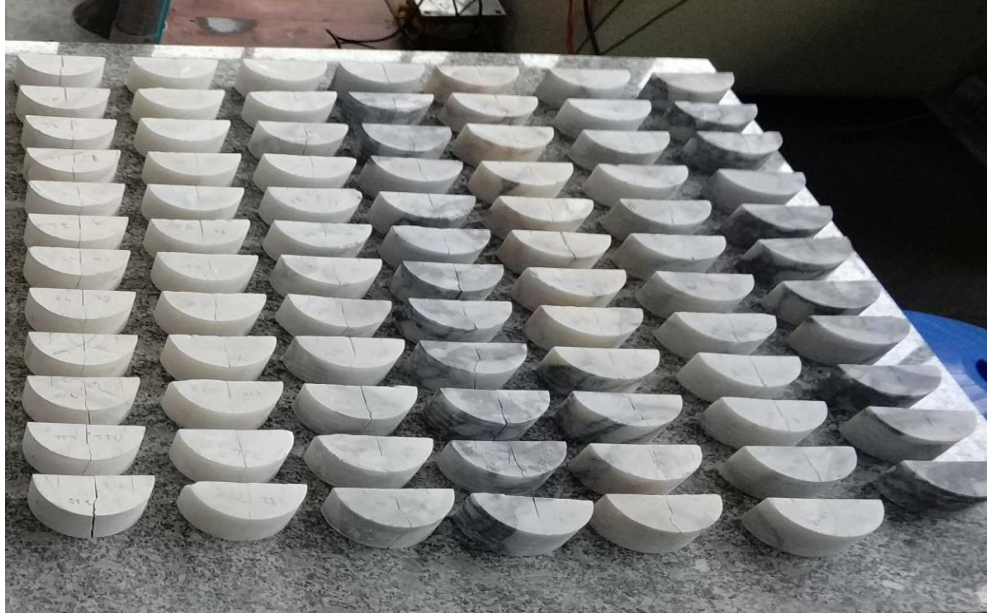
Şekil 4. 15 SCB numunelerinin kırıldıktan sonraki görünüşleri
