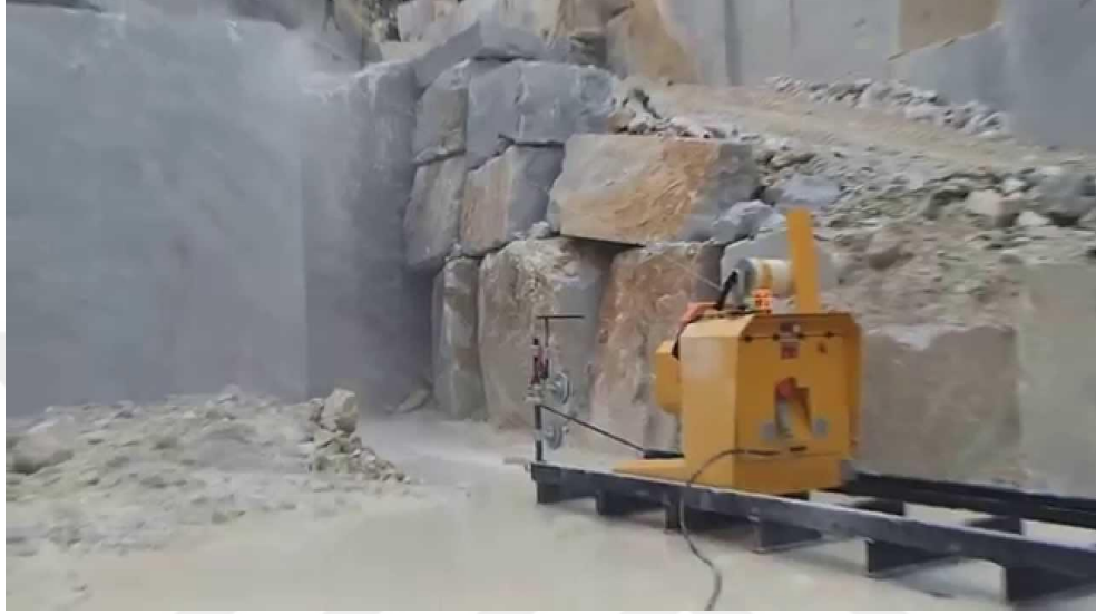
Şekil 2. 6 Raylı elmas telli kesme makinesi
