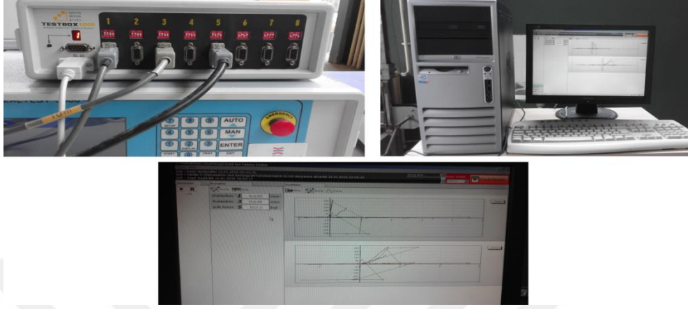
Şekil 4. 12 Veri toplama modülü, sisteme bağlı bilgisayar ve genel amaçlı statik veri toplama yazılımı
