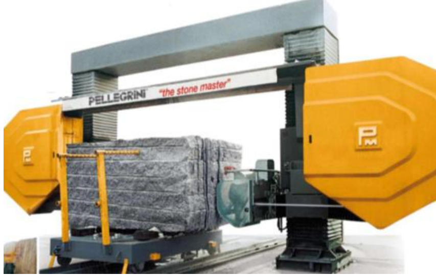
Şekil 2. 5 Çoklu elmas telli kesme makinesi [28]
