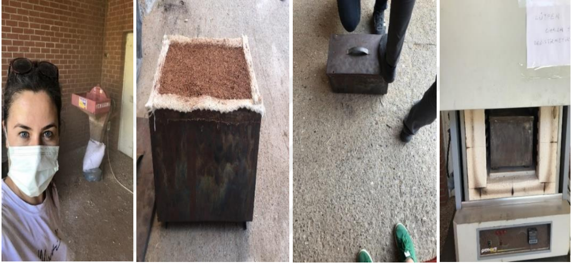
Şekil 7. Biyoçar üretim aşamaları
