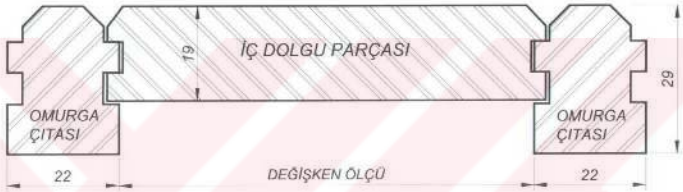
Şekil 2.2. İç dolgu parçası-omurga çitası ilişkisi (ölçüler mm)
