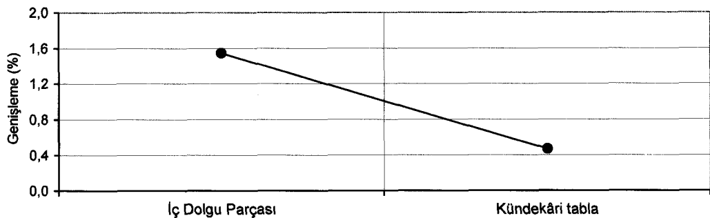
Şekil 5.35. Örnek tipine göre yüzeysel genişleme miktarları
