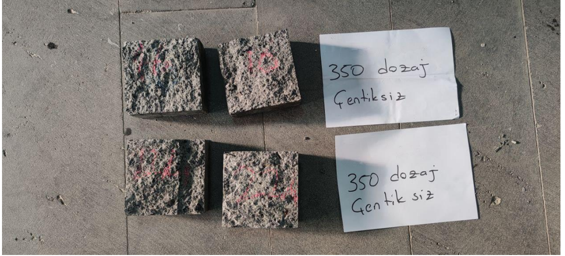
Şekil 6.22 350 dozaj numunelerin yakından kırılmış halleri
