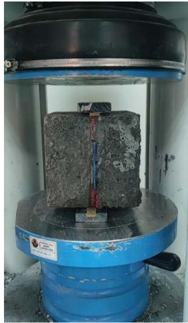
Şekil 6.14 Yarmada-çekme deneyine tabii tutulan numune
