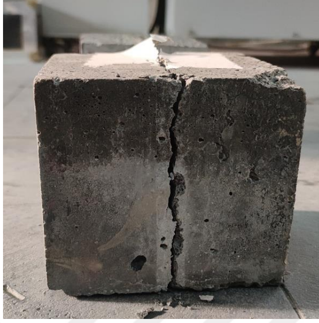
Şekil 6.21 350 dozaj numunenin kırıldıktan sonra yakından birleştirilmiş hali
