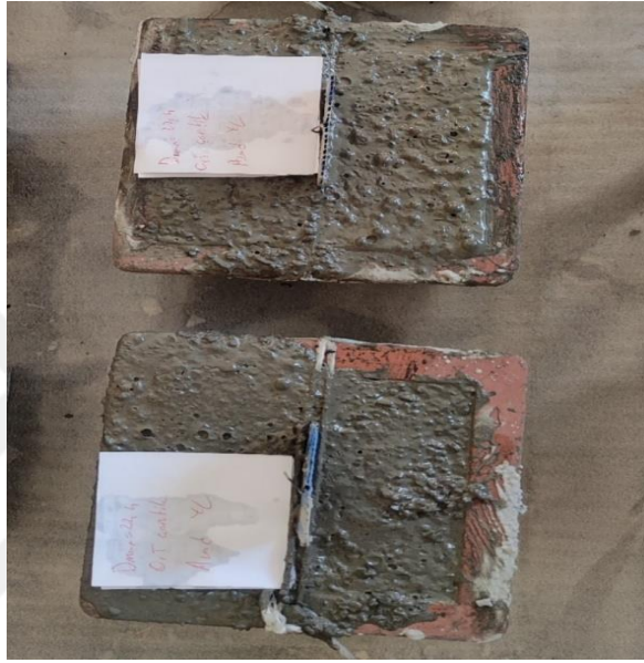
Şekil 6.13 Çentikli numunelerin kalıba alınmış görüntüleri
