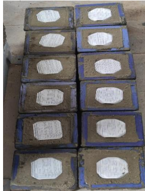
Şekil 6.11 Beton hamurunun kalıplara alındıktan sonraki görüntüsü
