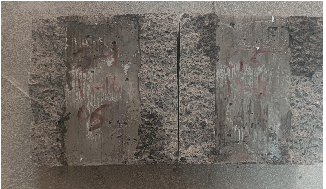
Şekil 6.18 300 dozaj numunenin yakından kırılmış hali
