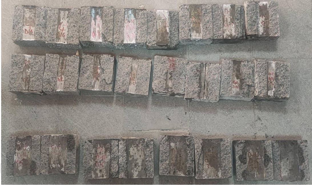
Şekil 6.15 300 dozaj ortadan ikiye ayrılmış numunelerin görüntüsü
