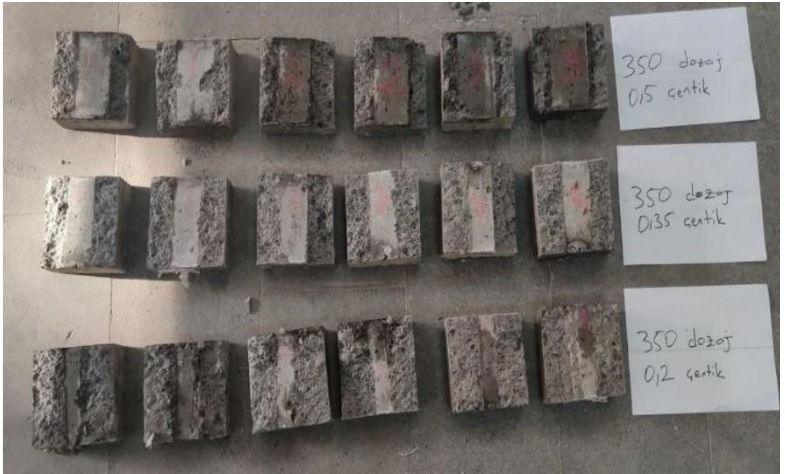
Şekil 6.20 350 dozaj 19 mm ortadan ikiye ayrılmış numunelerin görüntüsü
