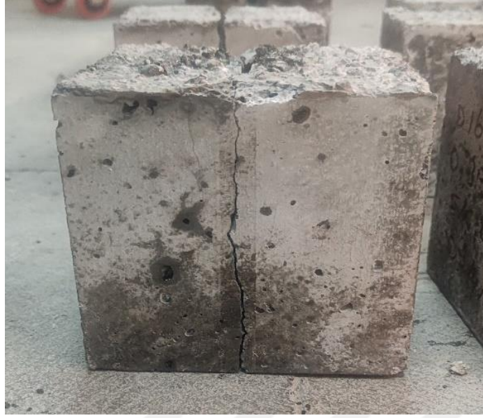
Şekil 6.17 300 dozaj numunenin kırıldıktan sonra yakından birleştirilmiş hali
