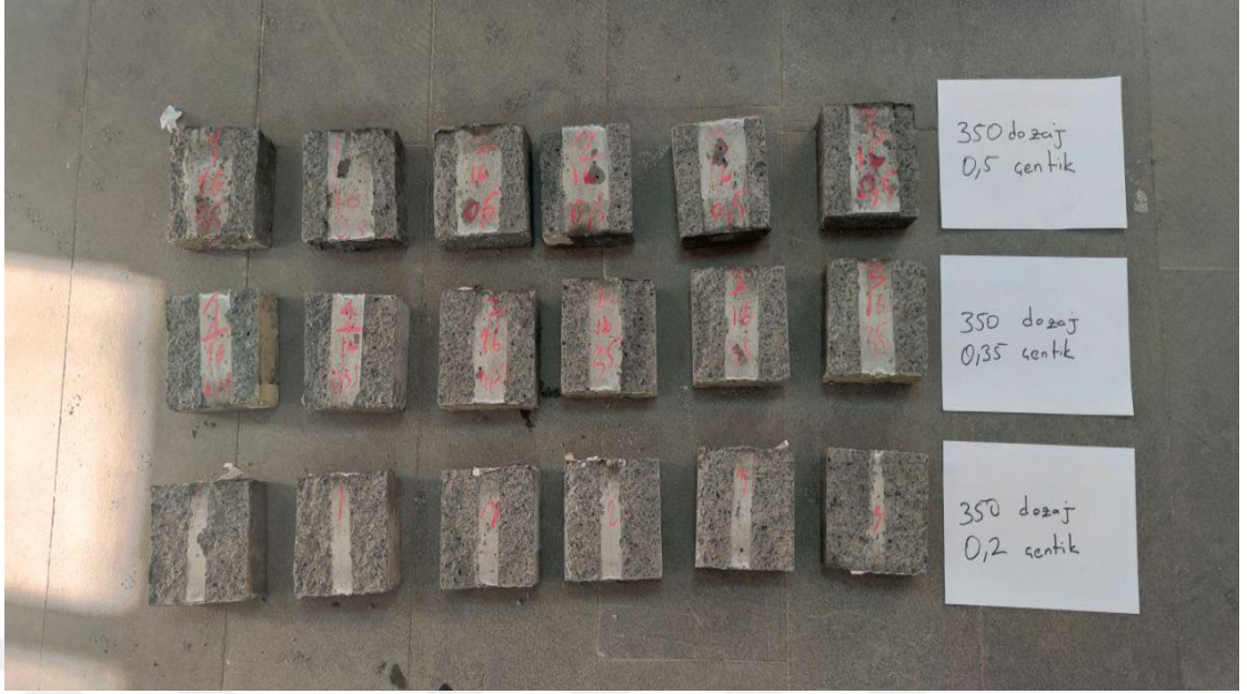
Şekil 6.19 350 dozaj 12mm ortadan ikiye ayrılmış numunelerin görüntüsü
