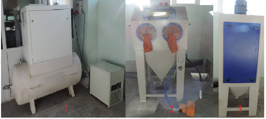
Şekil 5.4. Sakarya Üniversitesi, Mühendislik Fakültesi, Metalurji ve Malzeme Mühendisliği Bölümü laboratuvarında bulunan eroziyon aşınma test ünitesi.
