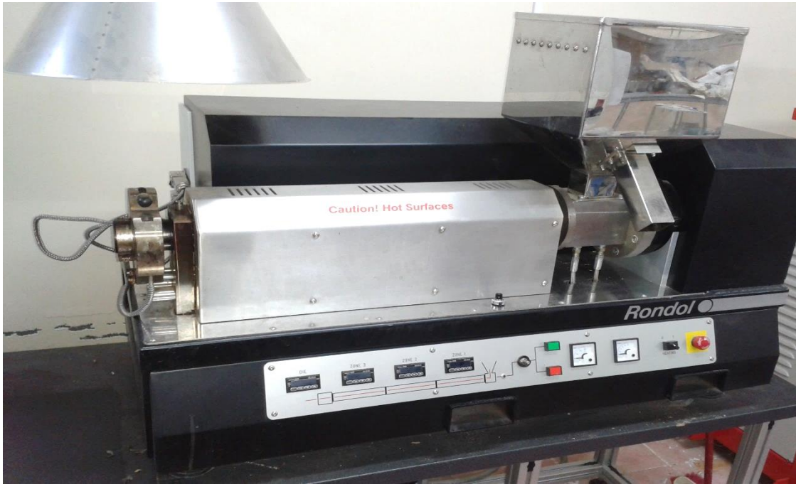
Şekil 12. Çalışmada kullanılan Rondol marka tek vidalı ekstrüder
