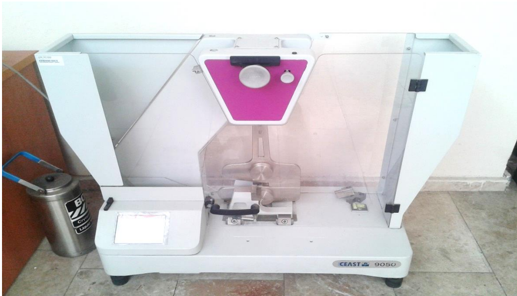
Şekil 20. Darbe testinin yapıldığı Instron marka Charpy darbe testi cihazı
