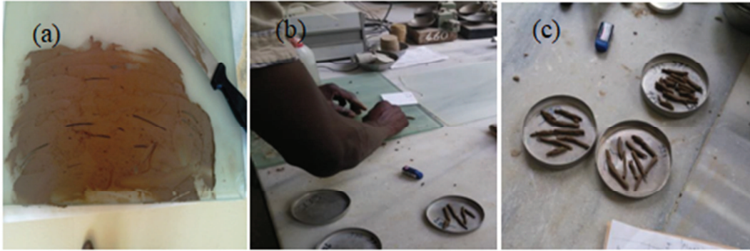
Şekil 4.6. Plastik limit deneyi, (a) numune, (b) yuvarlama işlemi, (c) 3 mm çapında çatlayan numune
