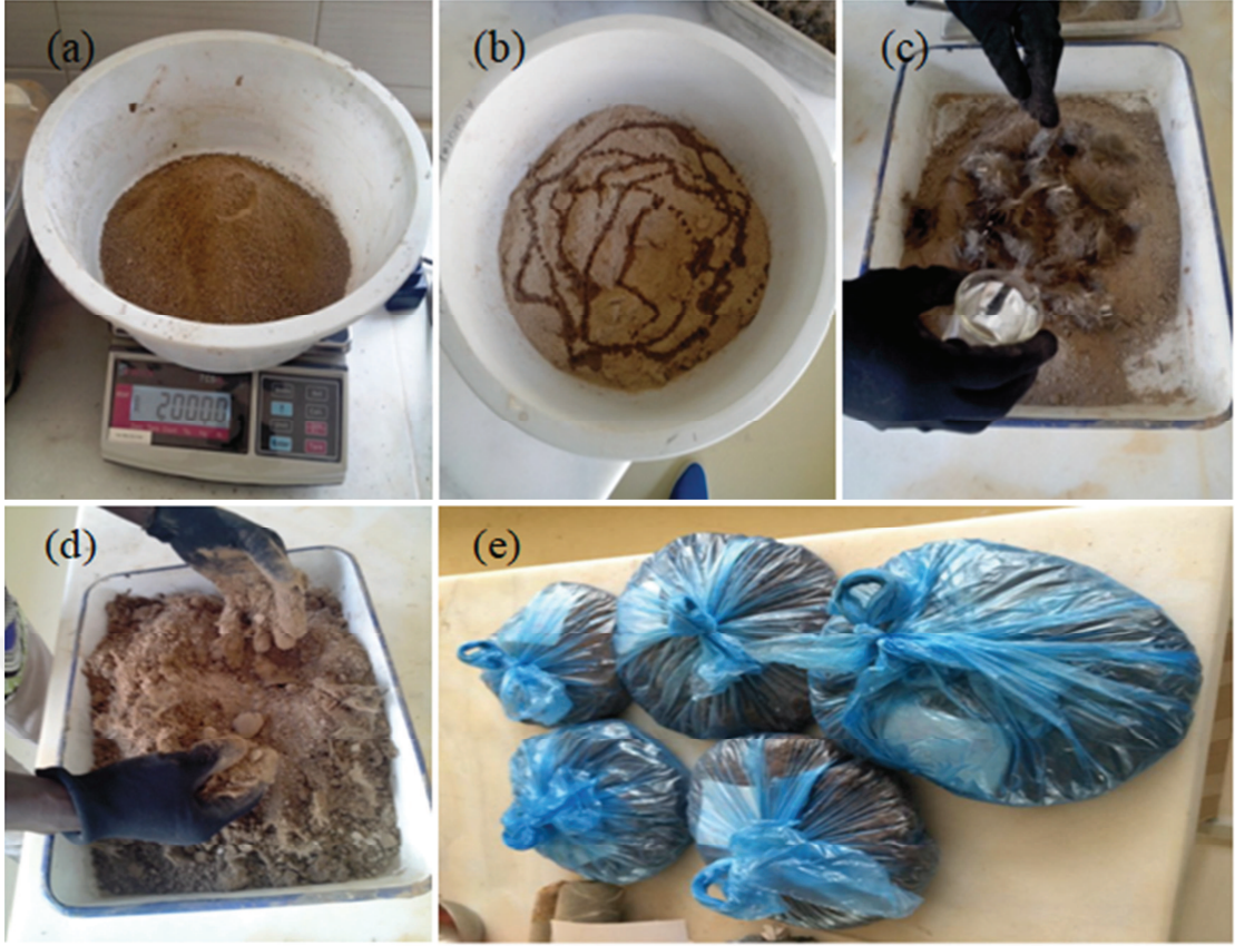
Şekil 4.13. Silt, (a) kuru numune, (b) su ilave edilmesi, (c, d) fiber ilavesi, (e) poşetleme
