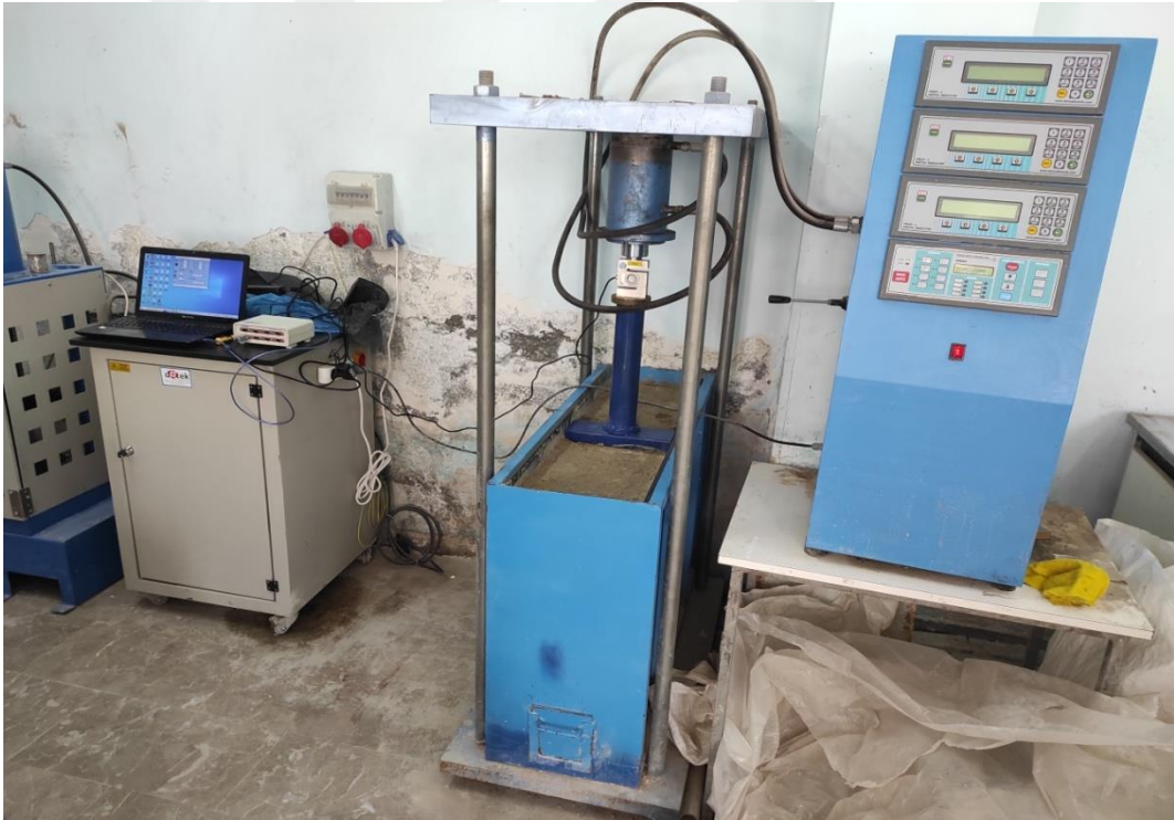
Şekil 4.31. Katkısız zemin üzerine yerleştirilen temelin yüklenmesi
