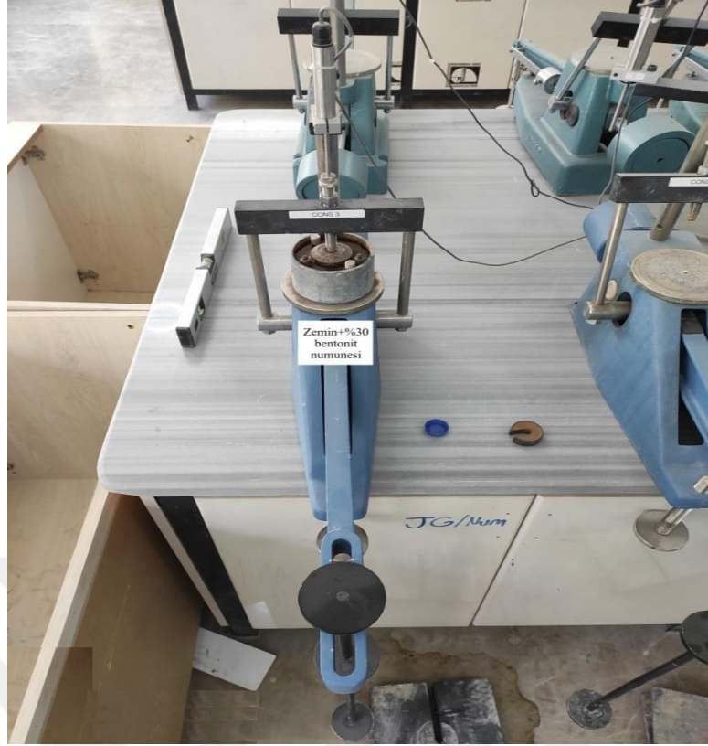
Şekil 3.6. Zemin+%30 bentonit karışım numunesi için şişme deneyinin yapılması
