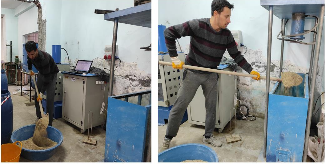
Şekil 3.38. Kum zeminin karıştırılması ve tank içerisine aktarılması
