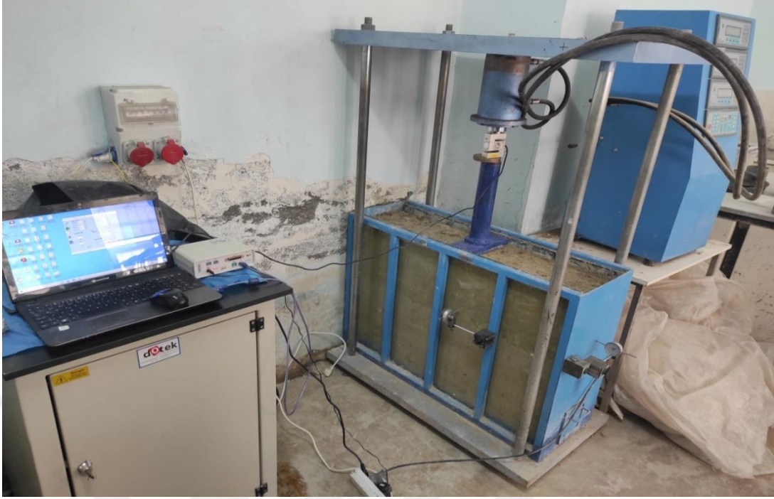
Şekil 4.32. Tankın yanal yüzeylerindeki deformasyonların ölçülmesi
