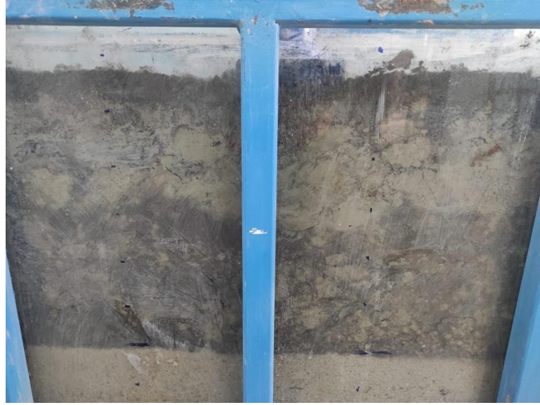
Şekil 4.38. BF+UK katkıli zeminin yükleme sonrası görünümü
