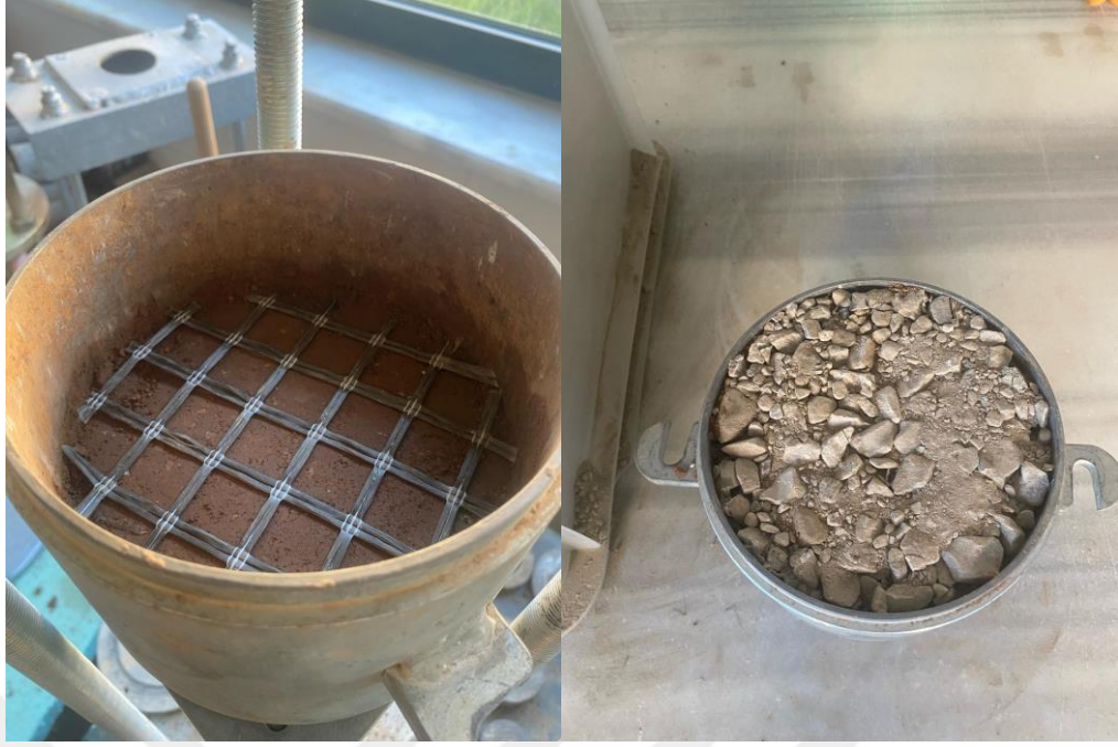
Şekil 5.28. CBR kabına yerleştirilen numune ve geogrid.
