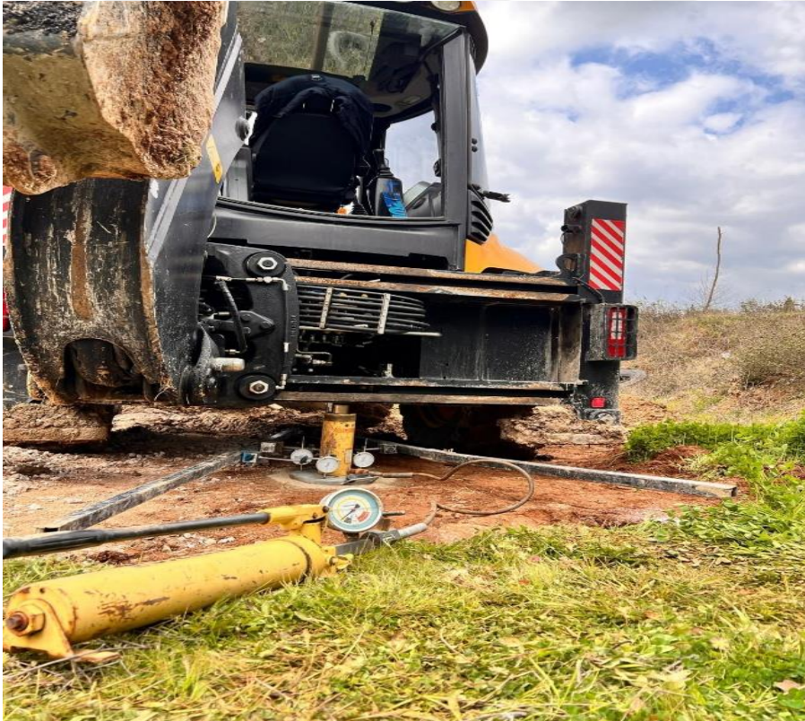
Şekil 5.9. Plaka taşıma deney ekipmanlarının kurulması.
