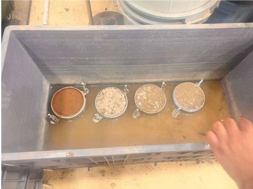
Şekil 5.29. CBR kabına yerleştirilen numunelerin suda bekletilmesi.
