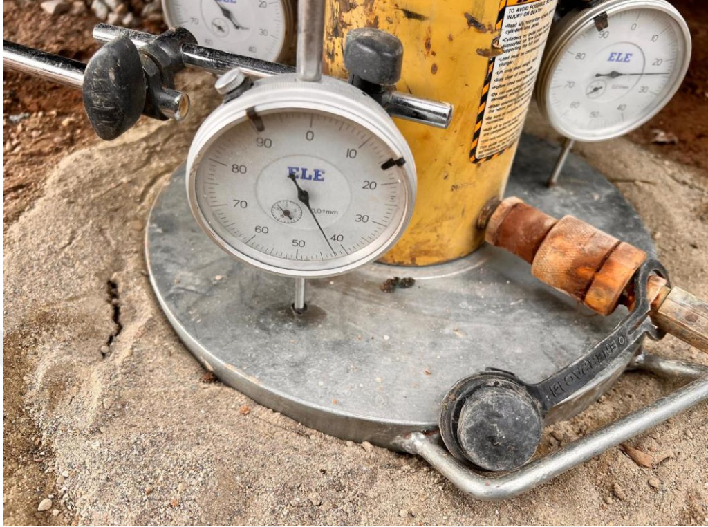
Şekil 5.10. Yüklem prosedürü ve saatlerin okunması.
