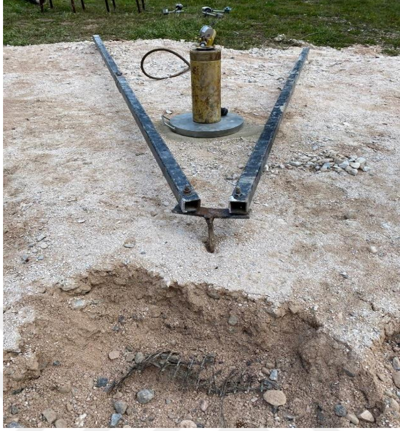
Şekil 5.13. Bazalt geogridin dolgu altında görünümüne ait görsel.
