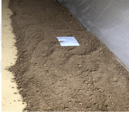
Şekil 4.2. Silt zeminin kurutulması
