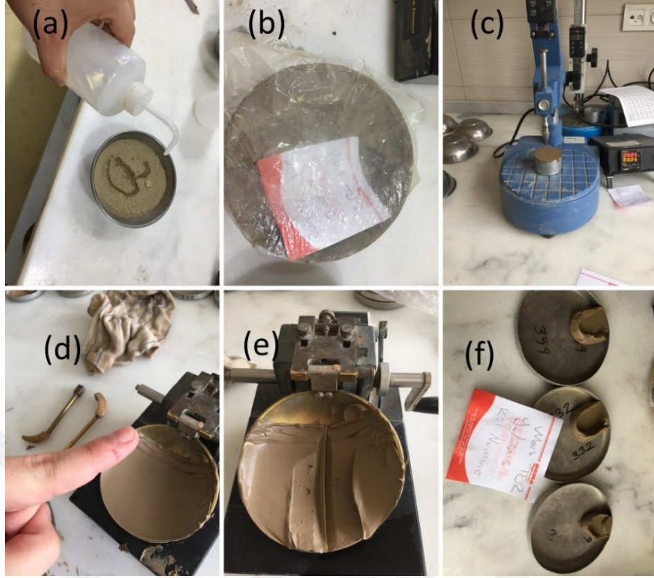
Şekil 4.8. Likit limitin tayini, (a) Zemin numunesinin hazırlanması (b) Numunenin saklanması, (c) Koni düşürme deney düzeneği, (d) Zeminin Casagrande aletine yerleştirilmesi, (e) Oluk açılmış zemin, (g) Su muhtevalarının belirlenmesi için alınan örnekler
