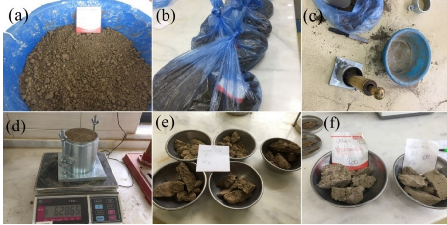
Şekil 4.18. Kompaksiyon deneyi, (a) Suyla karıştırılmış zemin, (b) Numunenin saklanması, (c) Kompaksiyon deney düzeneği, (d) Sıkıştırılmış zeminin tartılması, (e) Su muhtevası için alınmış örnekler, (f) Etüvde kurutulmuş örnekler
