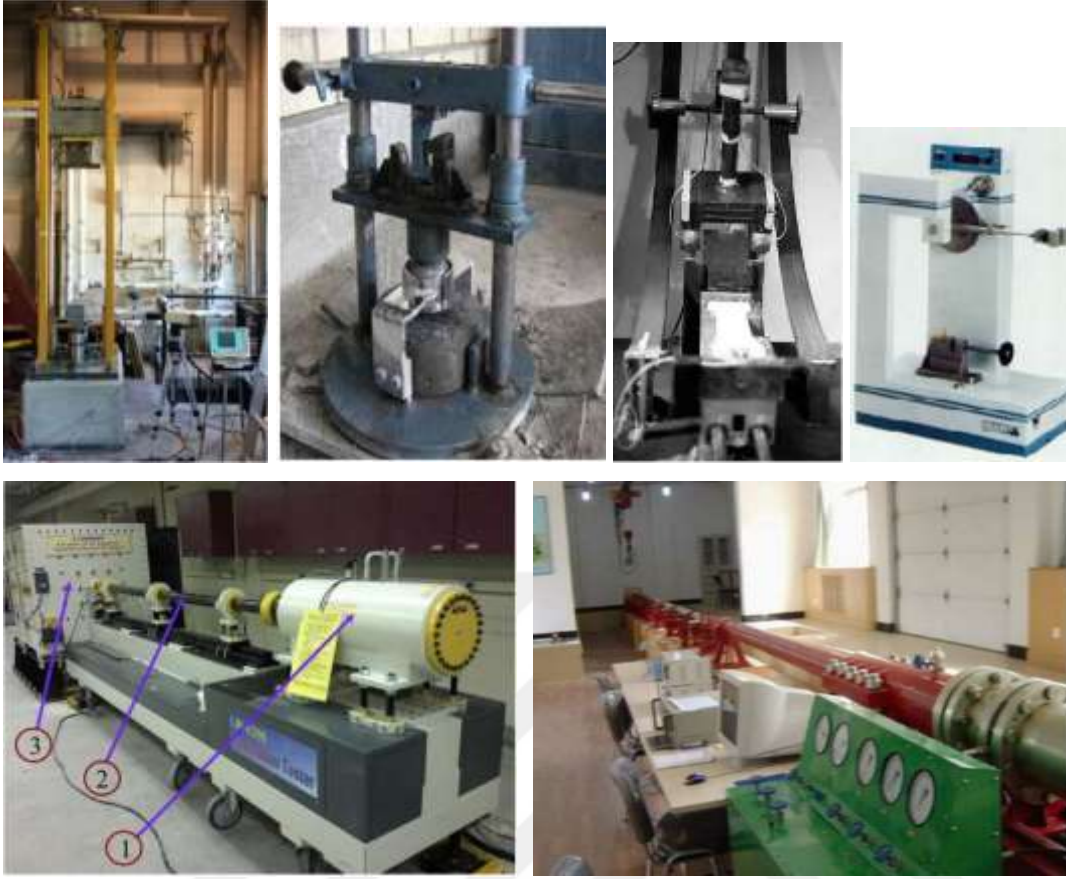
Şekil 2.6. Sırasıyla ağırlık düşürme, serbest düşen top, charpy, izod,, mermin darbe testi (1. Güç ünitesi, 2. Kılavuz namlu ve 3. Hedef çerçeve ve test bölümü) ve bölünmüş hopkinson basınç çubuğu testi (Kim vd., 2011; Yoo ve Banthia, 2019)
