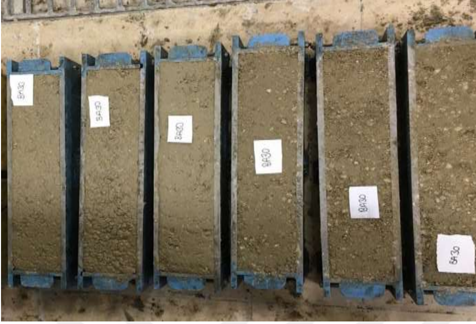
Resim 3.16. Üç noktalı eğilme testi için kullanılan 10x10x50 cm kiriş numuneler
