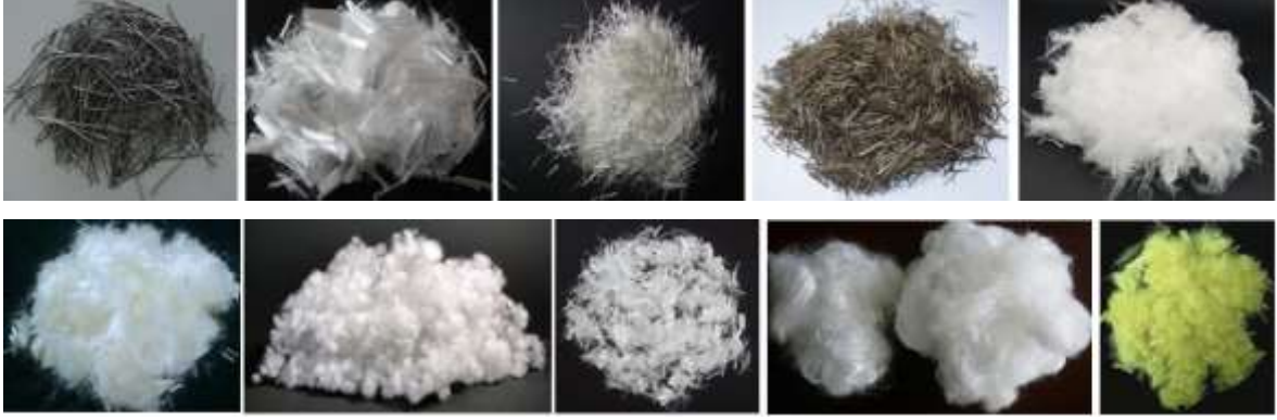
Şekil 2.5. Beton içerisine katılan lifler (sırasıyla çelik, polipropilen, cam, bazalt, poliamid, polivinil alkol, seramik, polietilen, naylon, kevlar lifi.)
