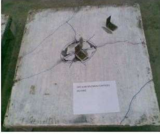
Şekil 2.7. PÇB'nin darbe altında çatlak hasarı (K vd., 2014)
