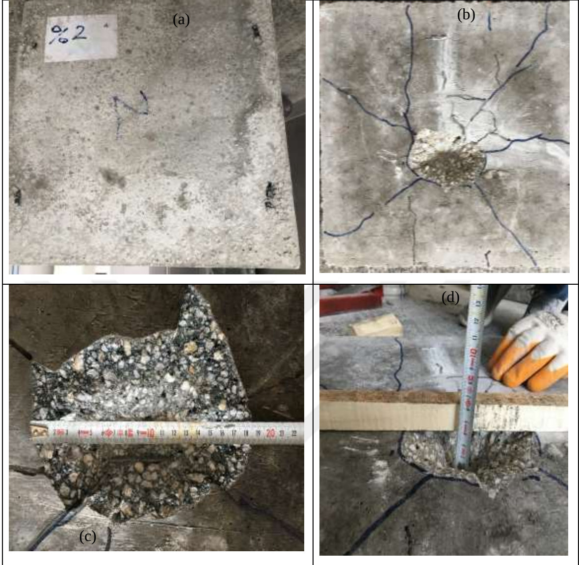
Resim 4.9. İkinci darbe sonrası %2 BLGB-2'nin ön (a) ve arka (b),(c),(d) oluşan kabuk atımları
