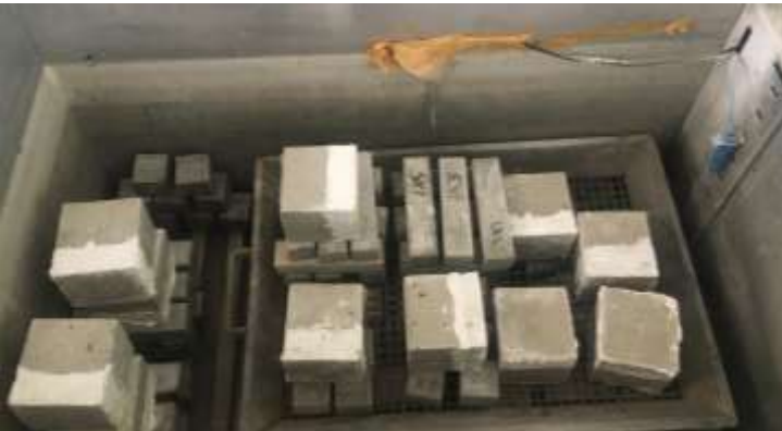
Resim 3.17. Donma-çözünmeye bırakılan numuneler
