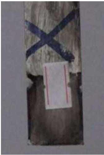
Resim 3.23. Plağın deplasmanını bulmak için SGİY ile nesne takibi yapılacak etiket
