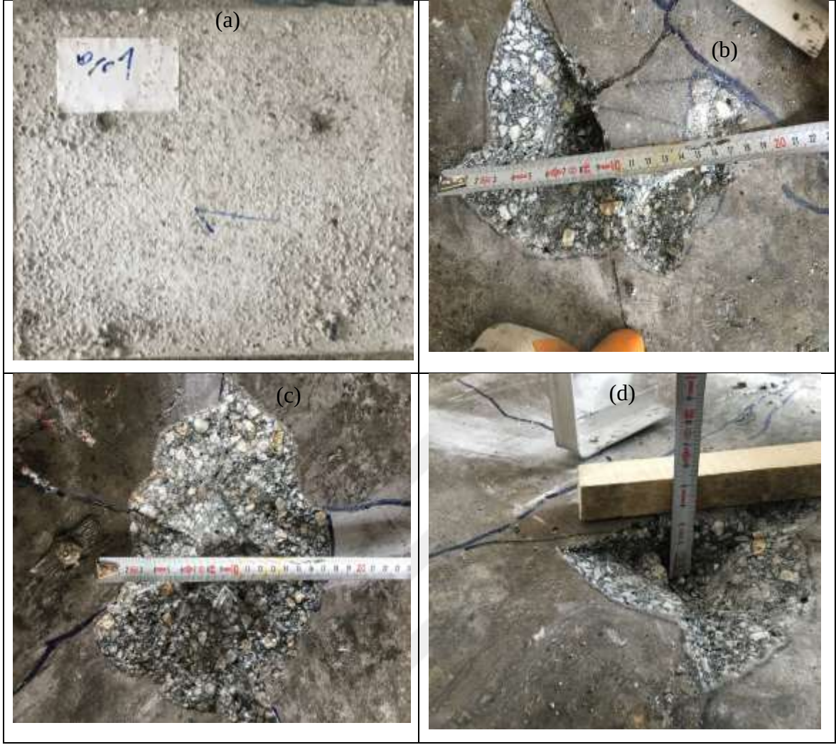
Resim 4.8. İkinci darbe sonrası %1 BLGB-2 ön (a) ve arka (b), (c), (d) yüzeyinde oluşan kabuk atımları
