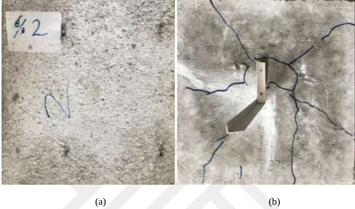
Resim 4.6. %2 BLGB-1'in darbe sonrası ön (a) ve arka (b) yüzeyinde oluşan deformasyon
