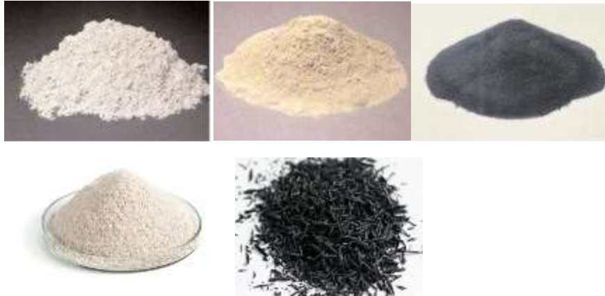
Şekil 2.2. GB içerisine katılan mineral katkılar (sırasıyla YFC, UK SD, metakaolin, pirinç kabuğu külü)(Dana, 2022; Engin, 2014)
