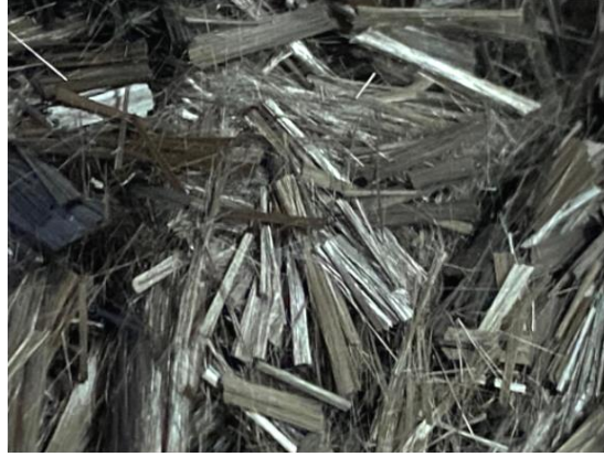
Şekil 7. Geopolimer harç karışımlarında kullanılan karbon lifler
