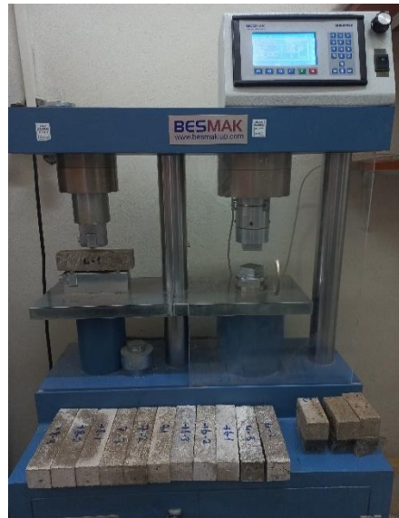
Şekil 18. Eğilme deneylerinde kullanılan çimento presi
