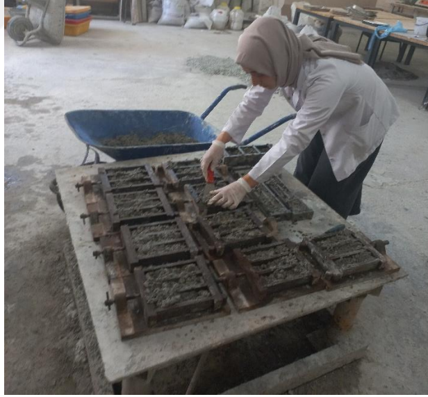
Şekil 14. Harcın kalıplara yerleştirilmesi
