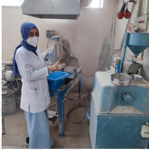
Şekil 9. İri agregaların çeneli kırıcılardan geçirilme işlemi
