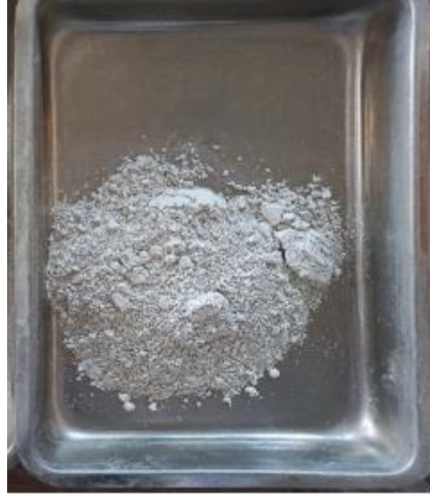
Şekil 3. Üretimlerde kullanılan yüksek fırın cürufu
