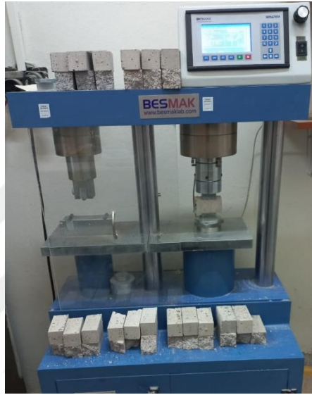
Şekil 17. Basınç dayanımı deneylerinde kullanılan çimento presi
