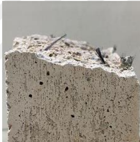
Şekil 32. Geopolimer harç içinde kümelenen lif topakları
