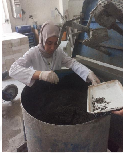
Şekil 13. Taze harç karışımına lif ilave edilmesi
