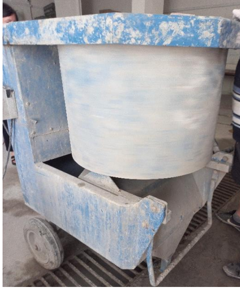
Şekil 12. Üretimde kullanılan betoniye
