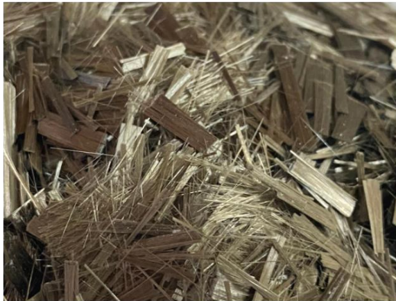
Şekil 8. Geopolimer harç karışımlarında kullanılan bazalt lifler
