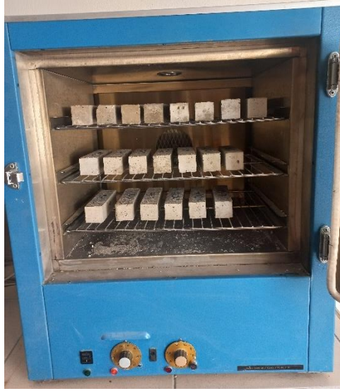
Şekil 20. Numuneleri kurutmak için kullanılan Geniar markalı etüv
