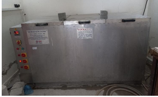
Şekil 15. Deneylerde kullanılan buhar kürü tankı
