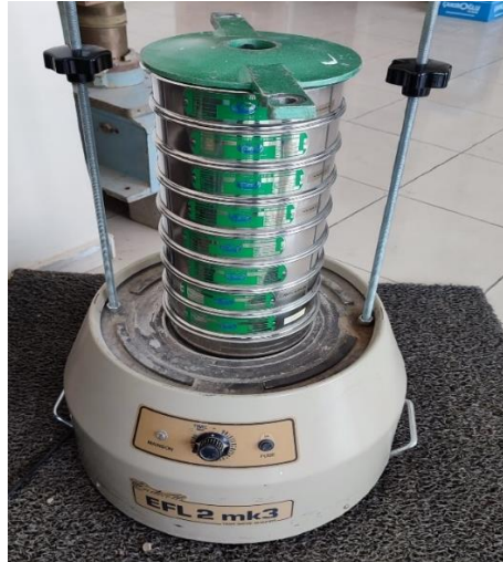
Şekil 10. Kullanılan elekler ve elek sarsma cihazı
