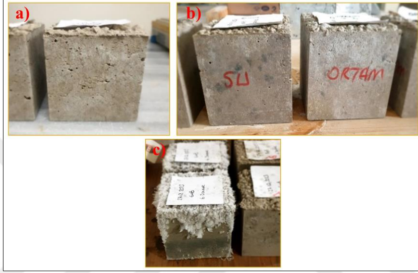
Şekil 14. a) Numune yüzeyinde çatlaklar, b) Su kürü ve ortam kürüne tabi tutulan numune yüzeyleri ve c) Numune yüzeylerinde çiçeklenme
