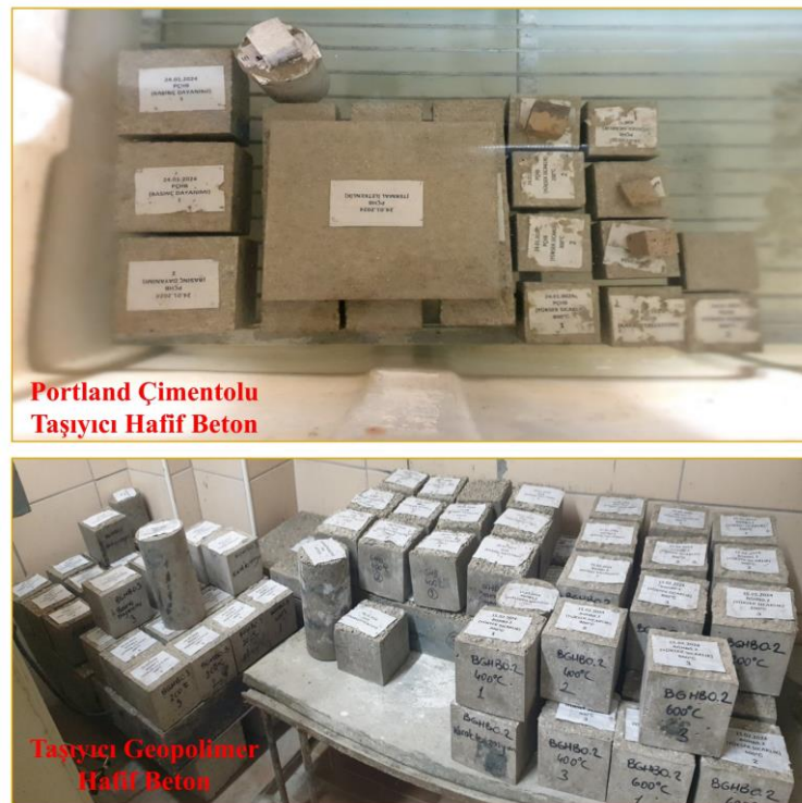
Şekil 19. Su havuzunda ve kür odasında tutulan taşıyıcı hafif beton numuneler
