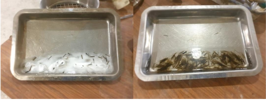
Şekil 16. 2 modül ve 3 modül sodyum silikat çözeltisi ile lif ilavesi sonrası görünüm
