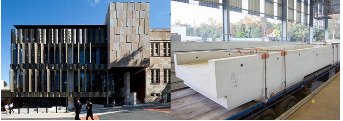
Şekil 3. Queensland Üniversitesi Küresel Değişim Enstitüsü binası ve bina inşasında kullanılan prekast döşeme paneli (Martin, 2024)
