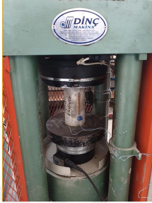
Şekil 23. Elastisite modülünün belirlenmesi
