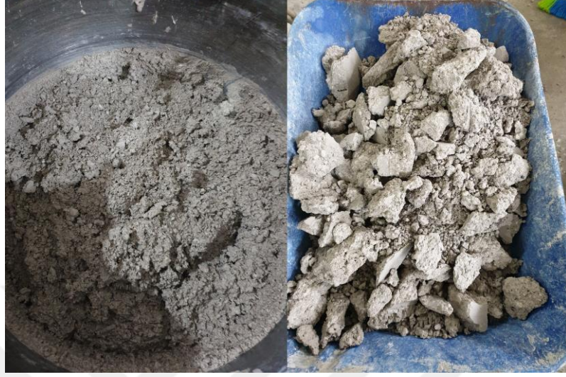
Şekil 15. Mikserde aniden katılaşıp sertleşen geopolimer karışımı
