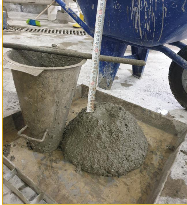
Şekil 20. Çökme deneyinin gerçekleştirilmesi
