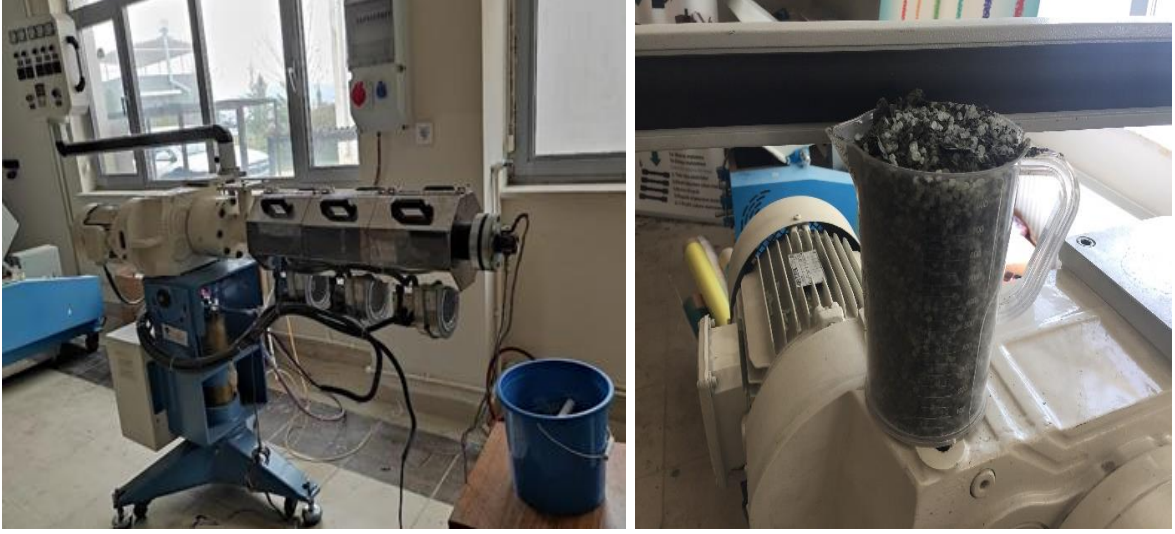
Resim 5.2. BES35 LD-tek vida ekstrüder makinası ve ekstrüde işlemi için hazırlanmış saf PP, geri dönüşümden elde edilen PP ve bazalt elyaf tozu içeren karışım
