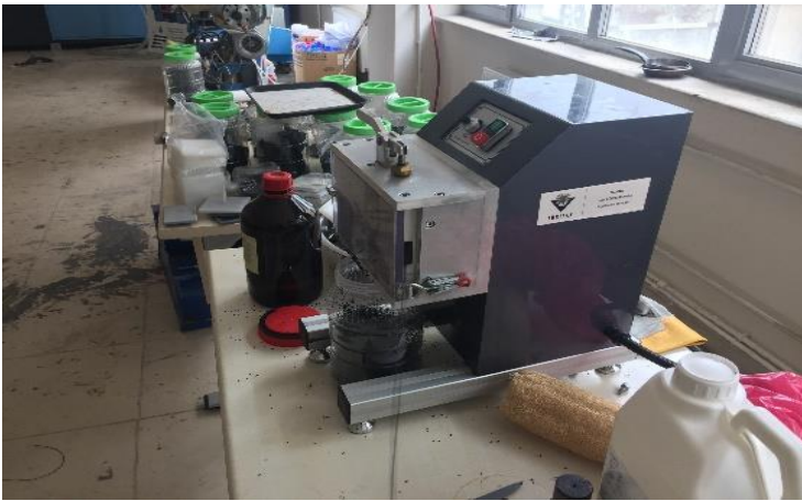
Resim 5.3. Granül eldesi için kullanılan kırıcı
