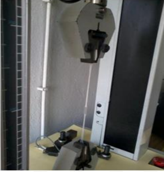
Resim 3.2. Çekme test cihazı (Şişmanoğlu, 2020)
