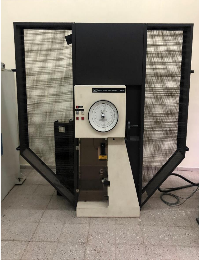
Resim 5.7. Darbe Test Cihazı
