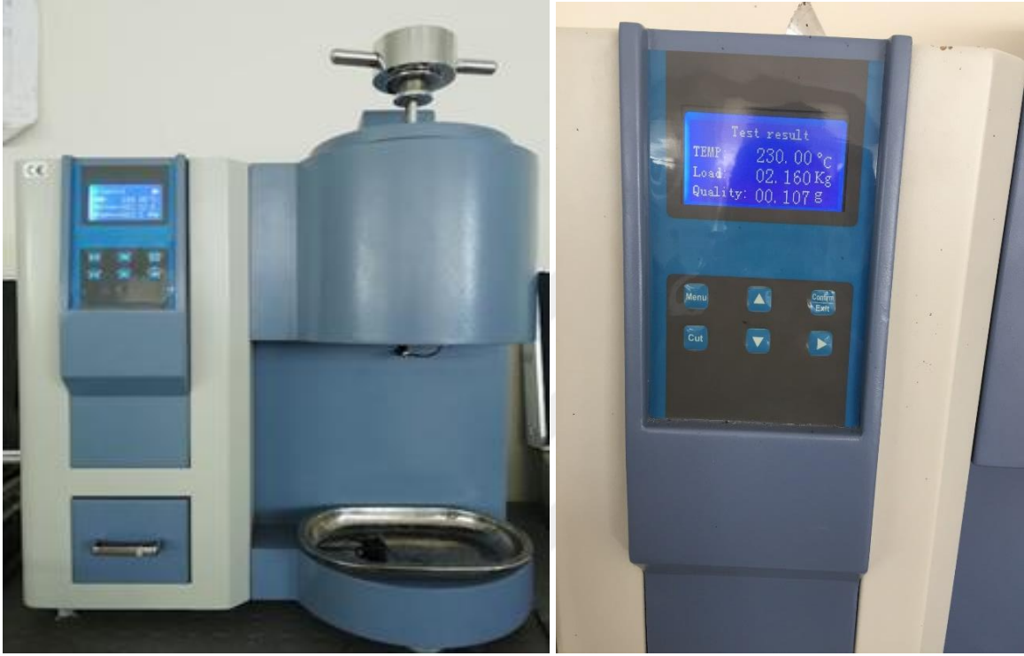
Resim 5.1. JPT EQUIPMANT XRL-400A Markasına ait Melt Flow Index eriyik akış tespit cihazı
