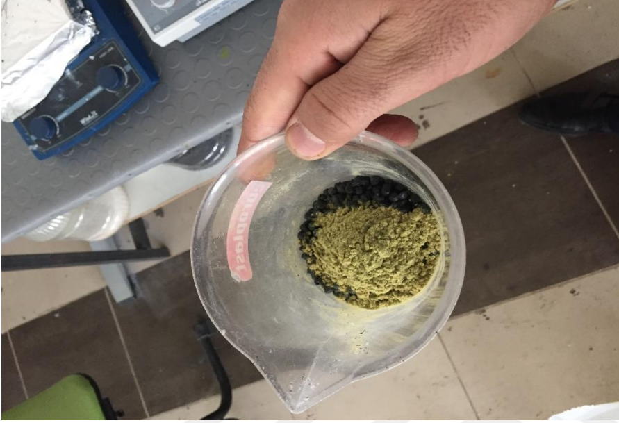
Resim 3.1. Bazalt elyaf tozu ve geri dönüşümden elde edilen polipropilen karışımı
