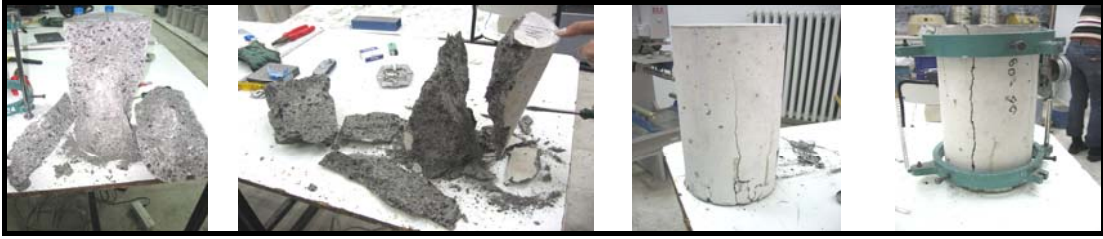
Resim 4.1. Basınç gerilimi sonucunda numunelerde görülen hasar biçimleri
