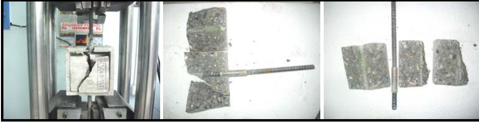
Resim 4.2. Deneyler esnasında tahripkâr bir biçimde patlayarak kırılan KS060-37,5 nolu numunelere ilişkin görüntüler
