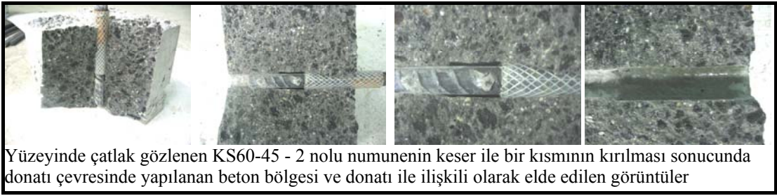
Resim 4.3. Beton – donatı aderans bölgesine ait görüntüler
