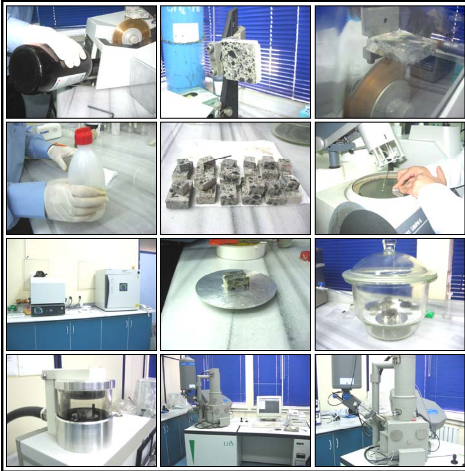
Resim 3.1. Tem analizleri ile ilgili olarak numune hazırlama sürecine ilişkin görüntüler
