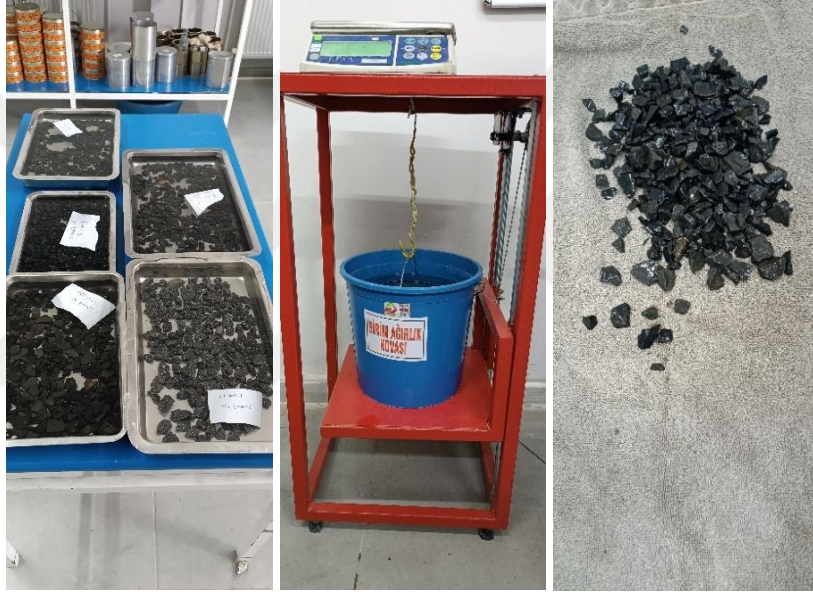
Şekil 111. Kaba agregâ özgül ağırlık ve su emme deney aşamaları
