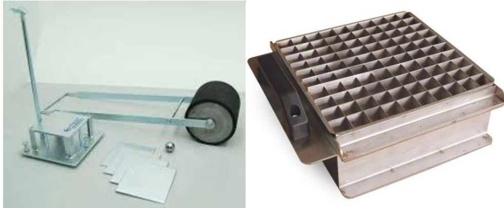
Şekil 56. Vialit deneyi ekipmanı (URL-19, 2025)
