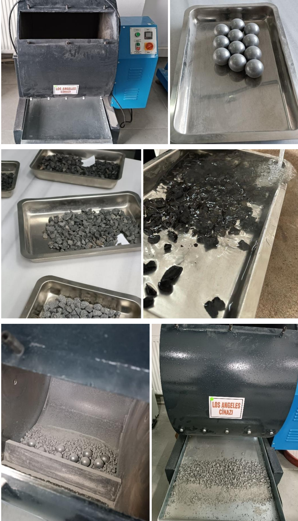
Şekil 106. Los Angeles deney aşamaları
