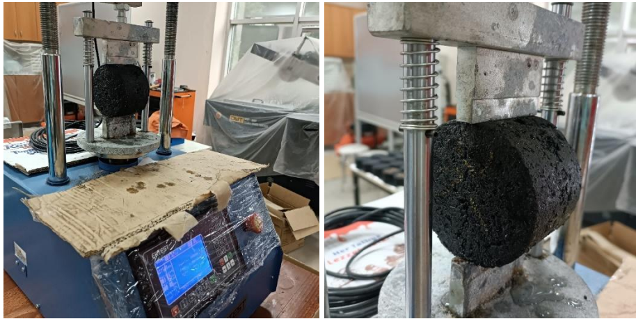
Şekil 118. Su hasarı (modifiye Lottman) deneyi aşamaları
