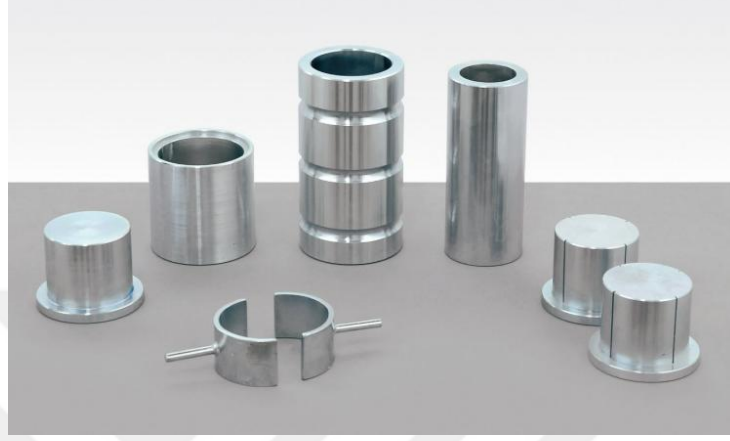
Şekil 73. Duriez basınç deney setleri (URL-25, 2025)
