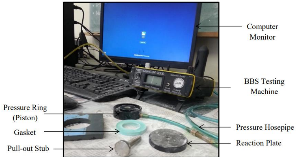
Şekil 54. BBS deney aparatının ana bileşenlerinin gösterimi (Twagirimana, 2014)
