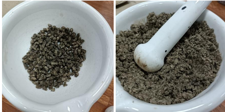
Şekil 95. Çalışmada kullanılan elyaf (Viatop Premium)
