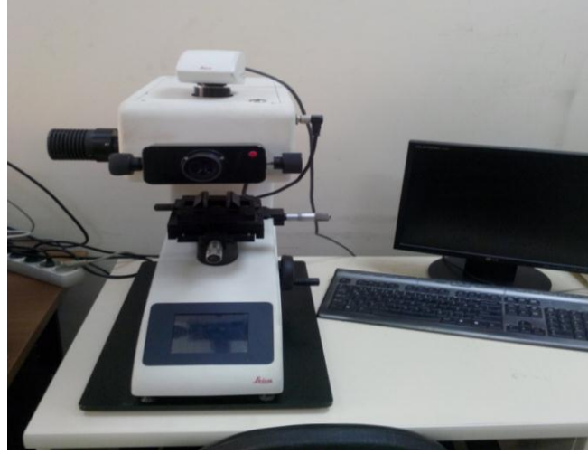
Şekil 5.11. Sertlik ve kırılma tokluğu ölçümlerinin yapıldığı mikrosertlik cihazı.
