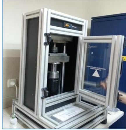
Şekil 5.6. Silindirik numunelerin üretiminde kullanılan pres.
