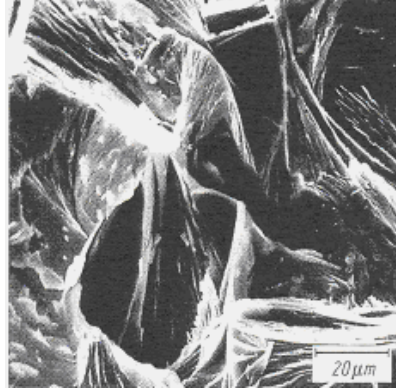
Şekil 4.9. \text{Na}_2\text{O-MgO-Al}_2\text{O}_3\text{-SiO}_2\text{-F} ana cam fazında oluşan büyük sodyum flogopit kristalleri [34].
