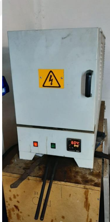
Şekil 4.8. Elektrikli ısıt işlem fırını
