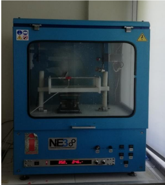
Şekil 3.1. Lif üretimi için kullanılan NE3 laboratuvar tipi elektro lif çekim cihazı
