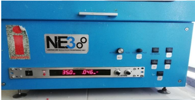
Şekil 3.2. Elektro lif çekim cihazı yüksek gerilim güç kaynağı
