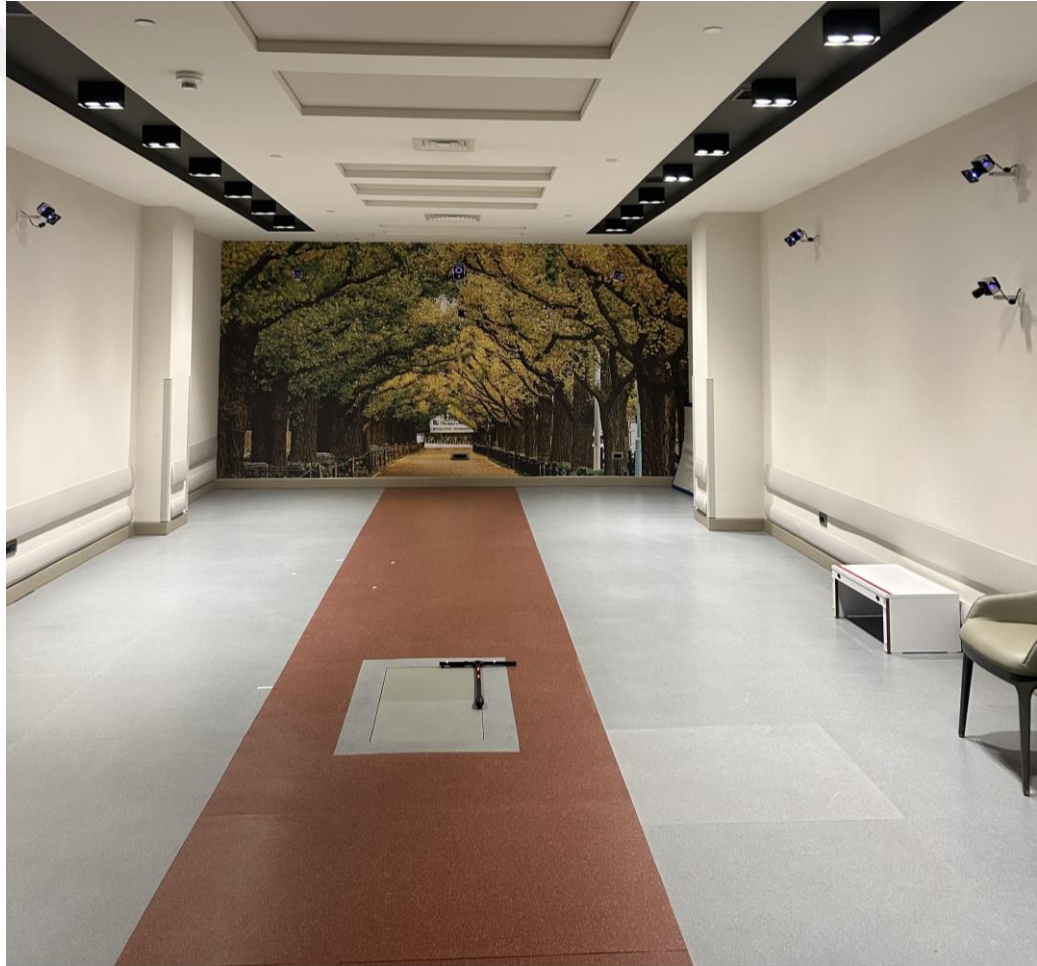
Şekil 3.8 : Yürüme analizi laboratuvarı, VICON hareket analiz sistemi, kuvvet platformu (Kistler 9082E, 100 Hz), reflektör marker takibi yapan kamera sistemleri.
