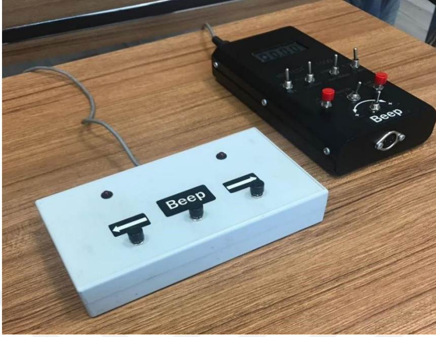
Şekil 3.10. Newtest Reaksiyon Zamanı Ölçüm Cihazı
