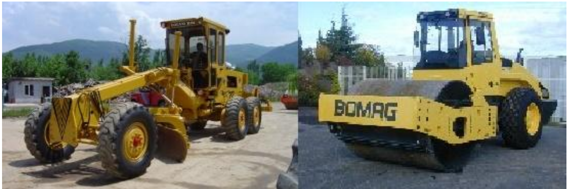
Şekil 3.16. Serimde Kullanılan Greyder ve Silindir
