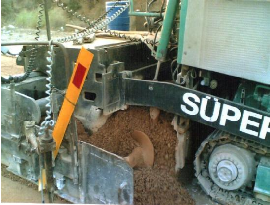
Şekil 3.22. Finişer İle PMT Serimi
