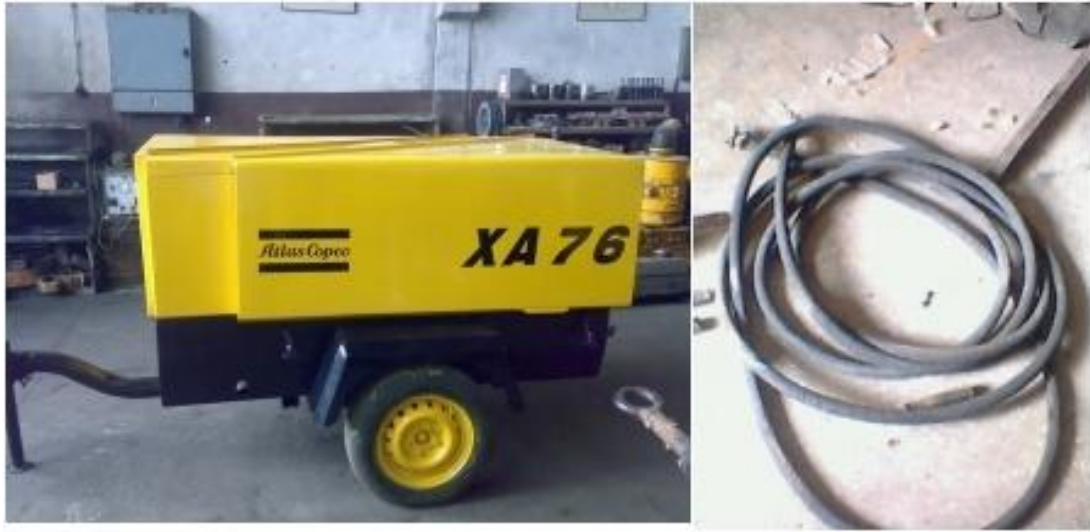
Şekil 3.28. Alt Tabakanın Basınçlı Hava İle Temizlenmesinde Kullanılan Kompresör
