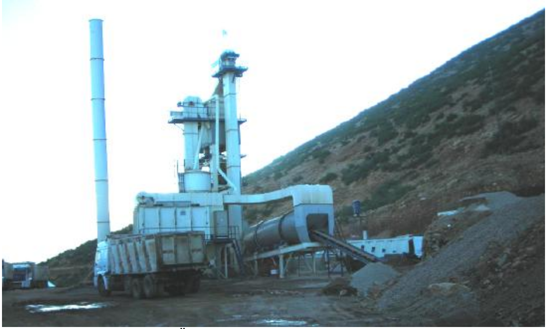
Şekil 3.15. Toplama Bandı Üzerindeki Malzemenin Dryer'e Akışı
