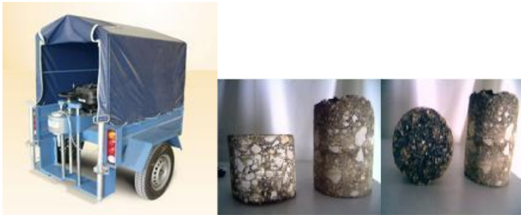
Şekil 3.34. Römorklu Karot Alma Makinesi ve Aldığı Karotlar (d=10cm)
