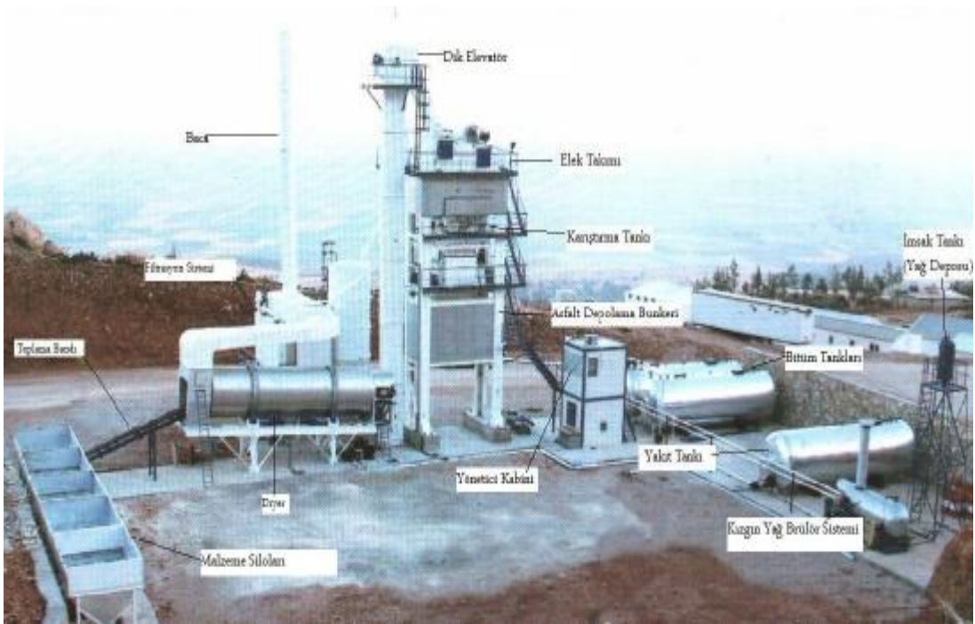
Şekil 3.14. Saatte 160 Ton Kapasiteli ÇESAN Marka Yerli Asfalt Plenti
