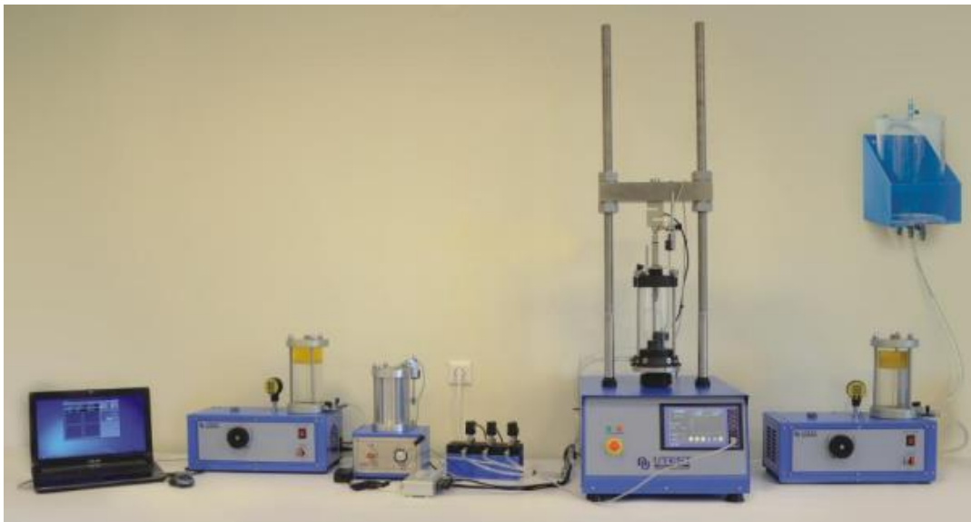
Şekil 2.7. UU-CU-CD Deneyleri için tipik üç eksenli deney sistemi konfigürasyonu.
