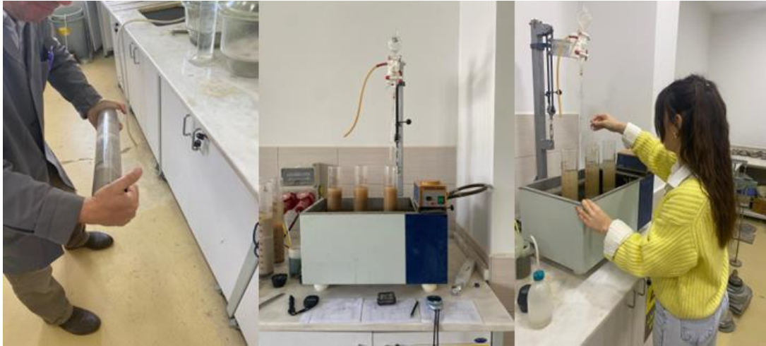
Şekil 3.4. Hidrometre deneyi hazırlık ve okuma aşamaları.
