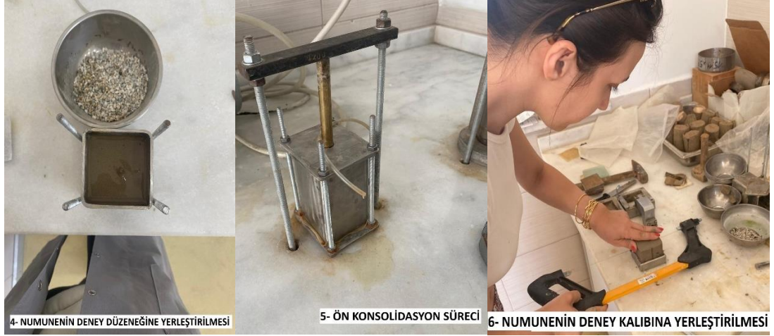
Şekil 4.4. Numune ön konsolidasyon ve deneye hazırlık süreci.
