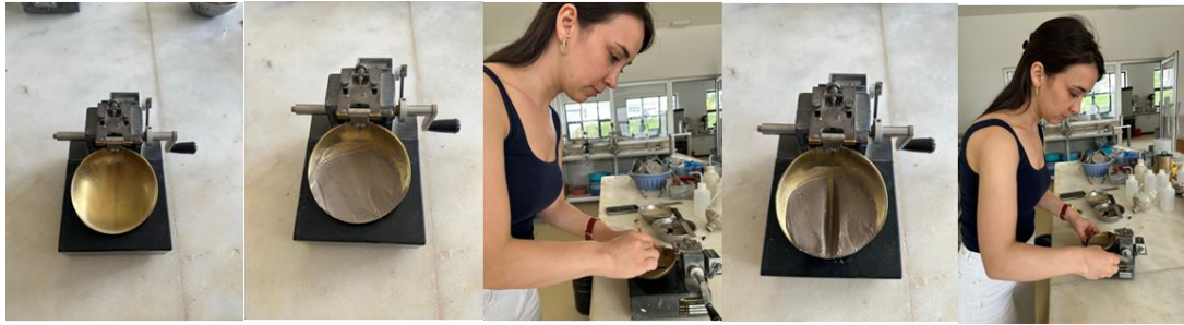
Şekil 3.1. Casagrande yöntemi ile likit limit tayini aşamaları.
