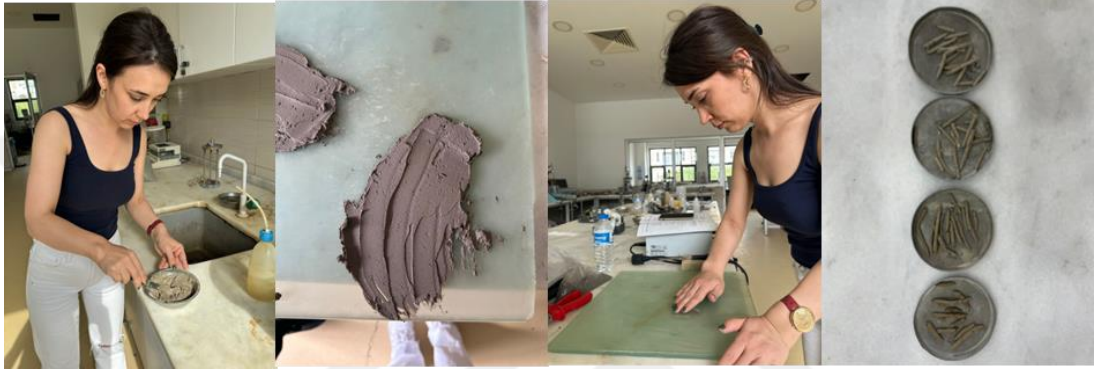
Şekil 3.2. Plastik limit deney aşamaları.
