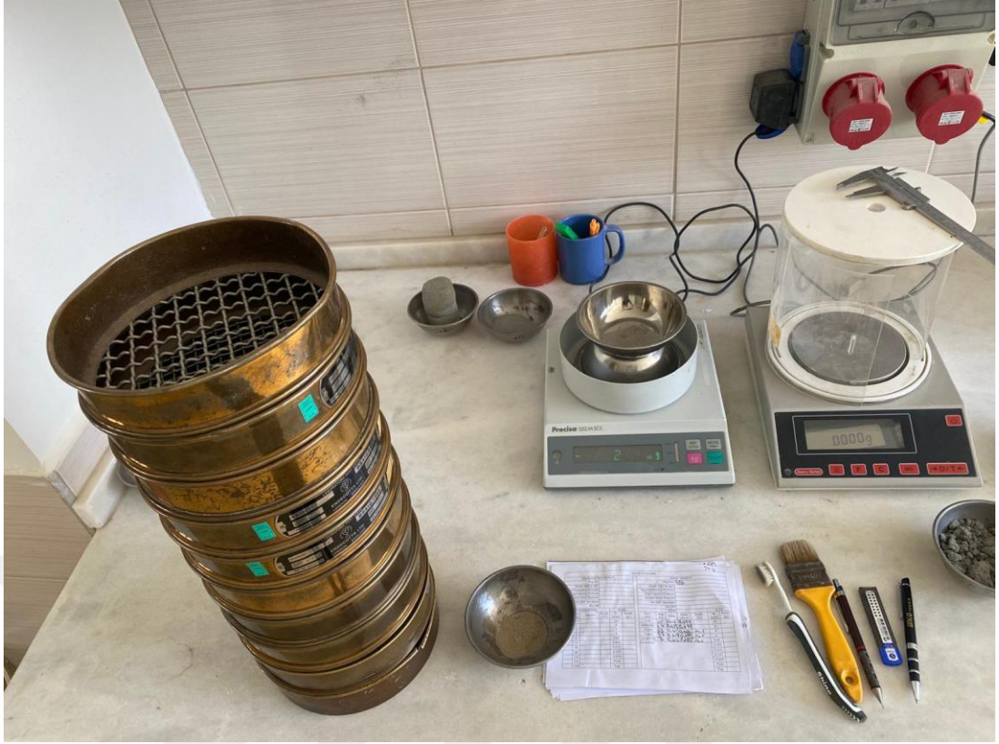
Şekil 3.11. Hidrometre sonrası yıkamalı elek analizi.
