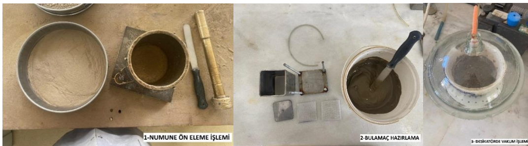
Şekil 4.3. Numune ön eleme, bulamaç ve vakum süreci.
