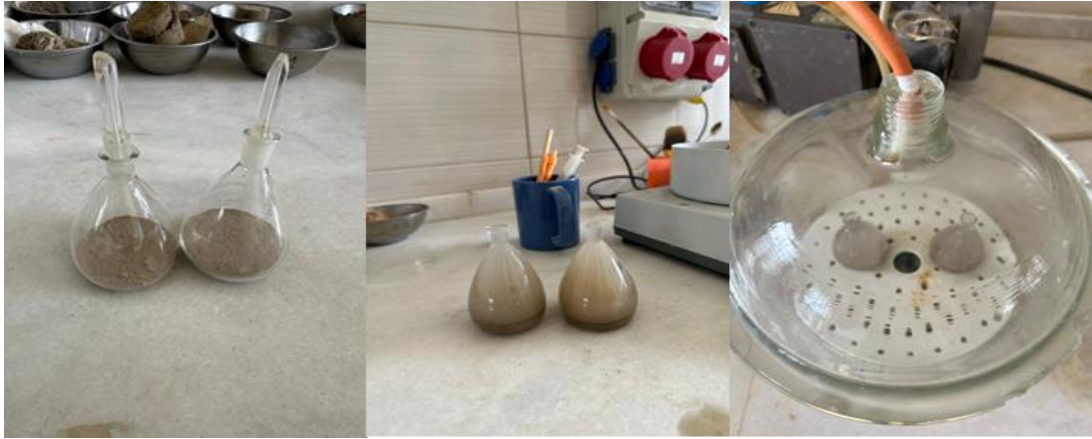
Şekil 3.5. Piknometre deney aşamaları-1.
