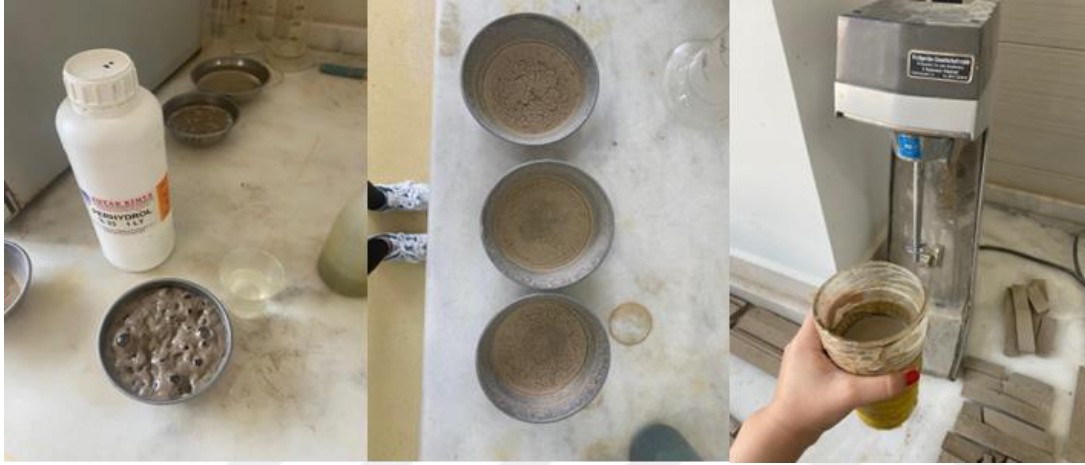
Şekil 3.3. Numunelerin organik maddelerden arındırılma işlemi.
