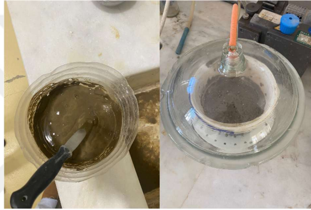
Şekil 4.2. Bulamaç (slurry) yöntemi ile numune hazırlama
