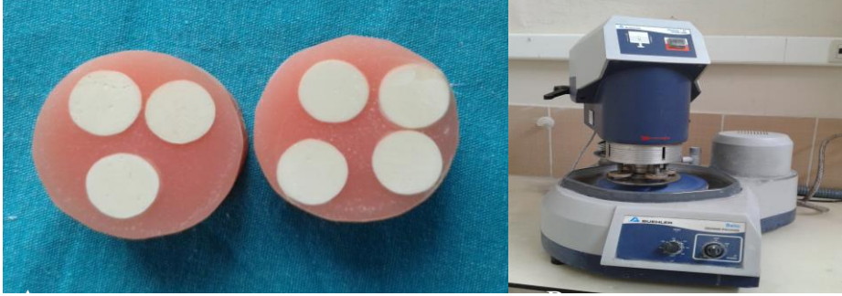
Resim 6. A) Akriik blok ierisine gmlmř CİS diskleri B) Otomatik zımpara makinesi (Buehler, Illionois, Amerika Birleřik Devletleri)
