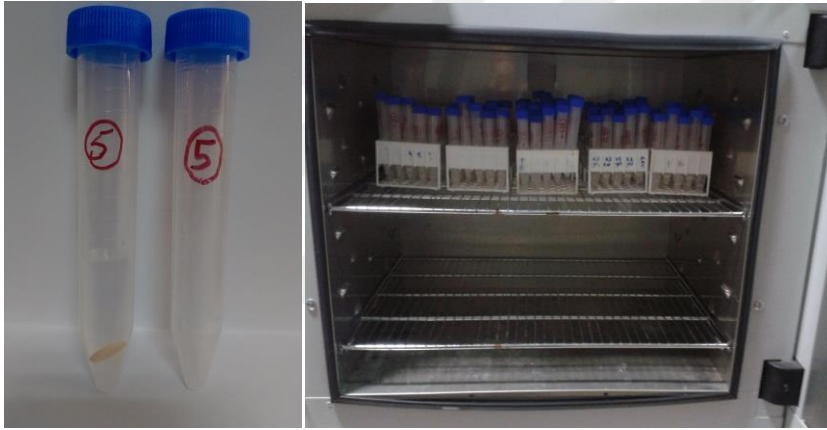
Resim 10. A) Plastik tüp içerisinde distile su ve distile su içerisinde yerleştirilmiş CİS örneği B) Etüv içerisinde yerleştirilmiş CİS diskleri
