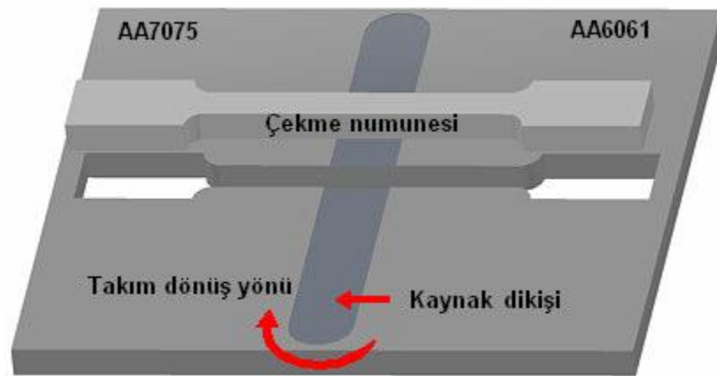
Şekil 6. 8 Numunenin plakadan çıkarılışı (SolidWorks Tasarımı)
