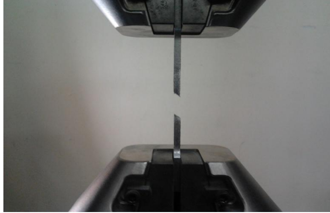
Şekil 7.16 Çekme testi sonucu kırılan numune
