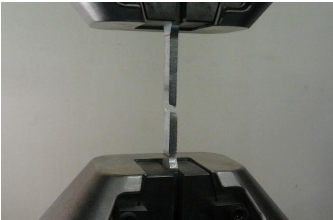
Şekil 7.18 Çekme testi sonucu kırılan numune
