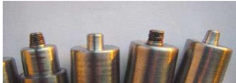
Şekil 4. 7 Farklı geometrilere sahip karıştırıcı uçlar (Zhao ve diğ., 2005).
