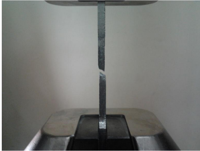
Şekil 7.17 Çekme testi sonucu kırılan numune
