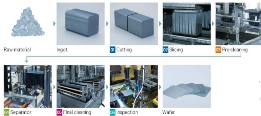
Şekil 35 Wafer Üretim Süreci
