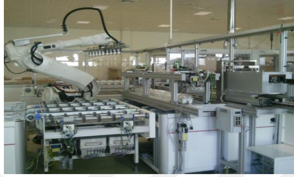
Şekil 63 İç Bağlantı İstasyonu
