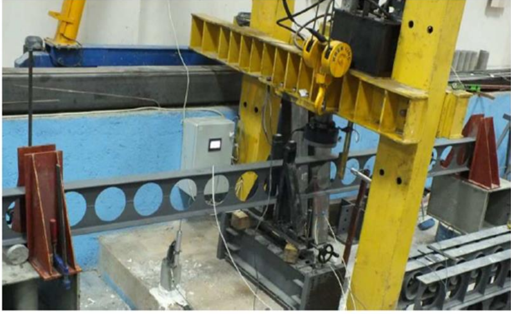
Şekil 4.1. Yükleme çerçevesinde dairesel boşluklu petek kiriş
