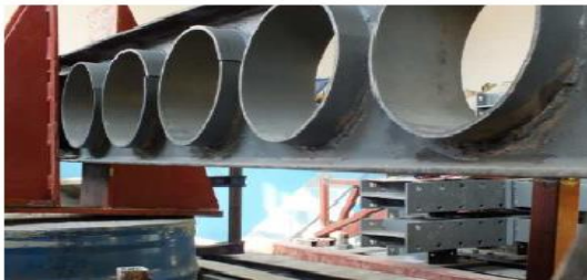
Şekil 4.7. IPN_DBPK_200 Dairesel berkitmeli kirişin yükleme durumu ve göçme halleri
