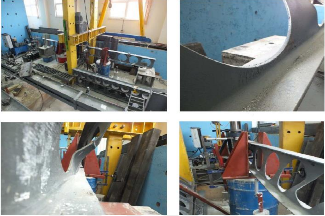
řekil 4.13. IPN_DBPK_240 Berkitmesiz kiriřin ykleme durumu ve gçme halleri
