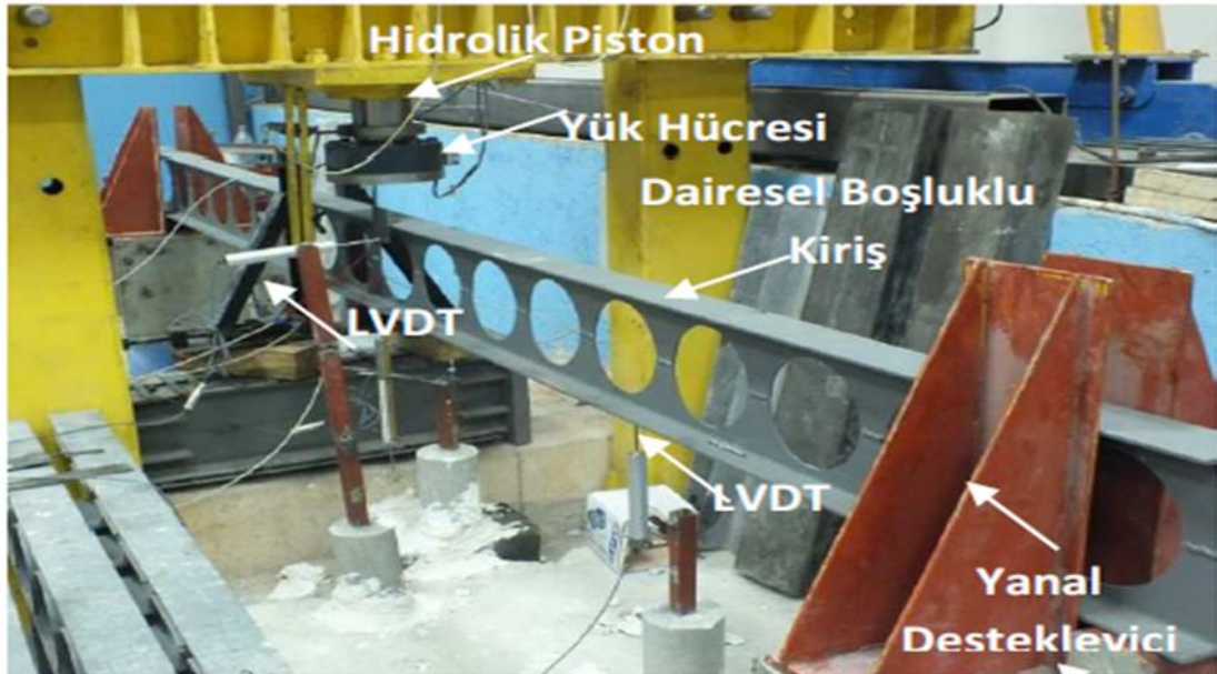
Şekil 4.2. Test ekipmanlarının yükleme çerçevesinde gösterimi
