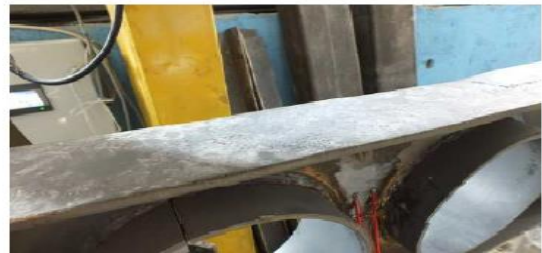
Şekil 4.7. IPN_DBPK_200 Dairesel berkitmeli kirişin yükleme durumu ve göçme halleri
