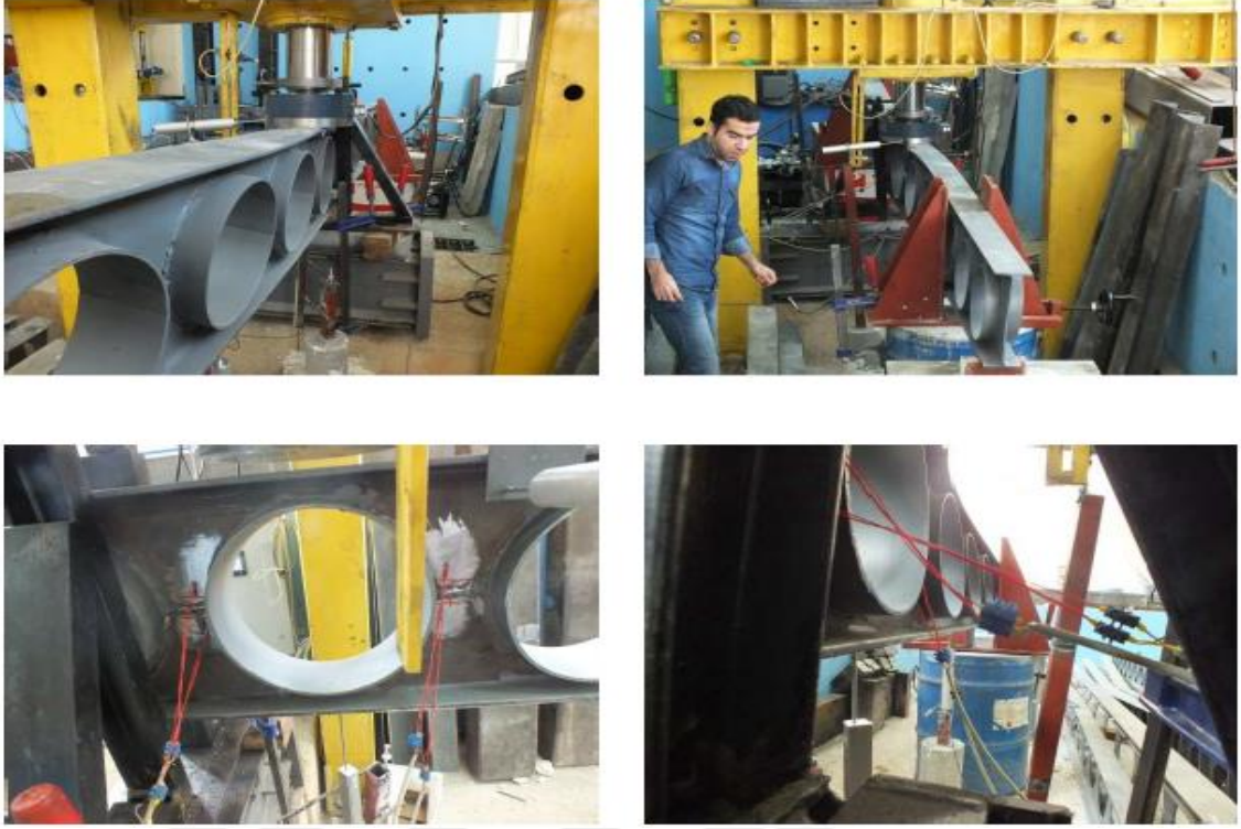
Şekil 4.16. IPN_DBPK_240 Dairesel berkitmeli kirişin yükleme durumu ve göçme halleri
