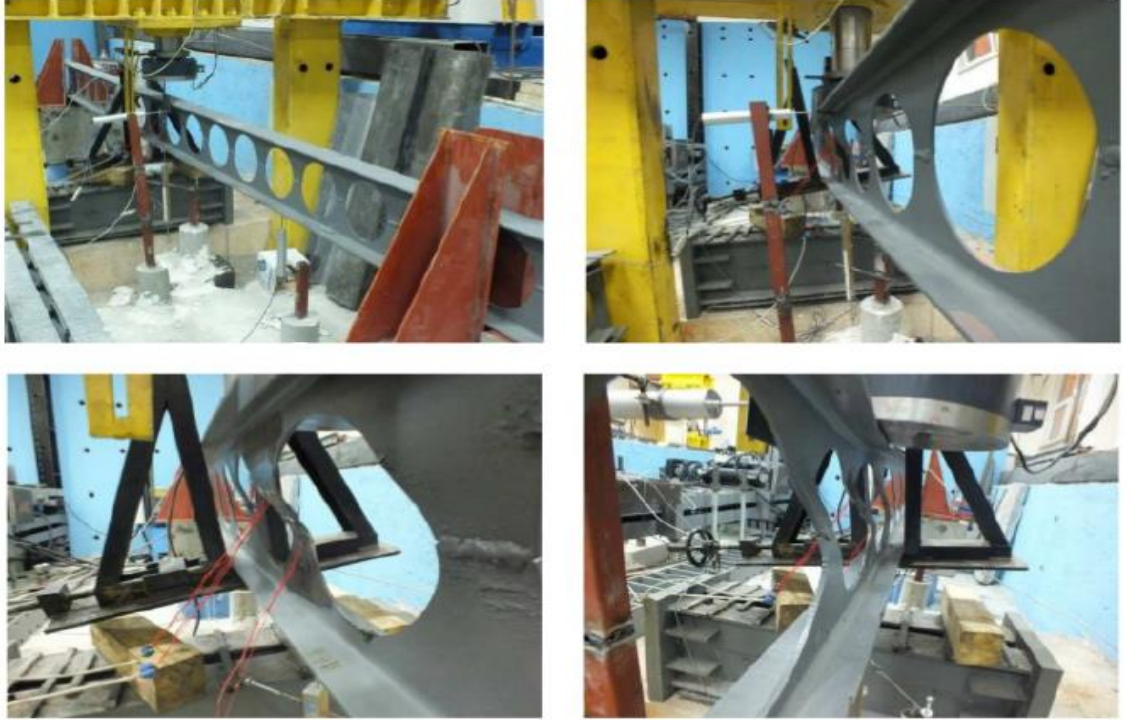
Şekil 4.4. IPN_DBPK_200 Berkitmesiz kirişin yükleme durumu ve göçme halleri
