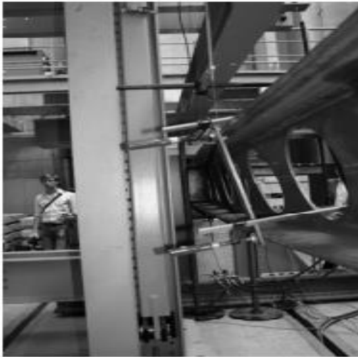
Şekil 2.15. Yanal burkulma durumu (Nseir et al. 2012).
