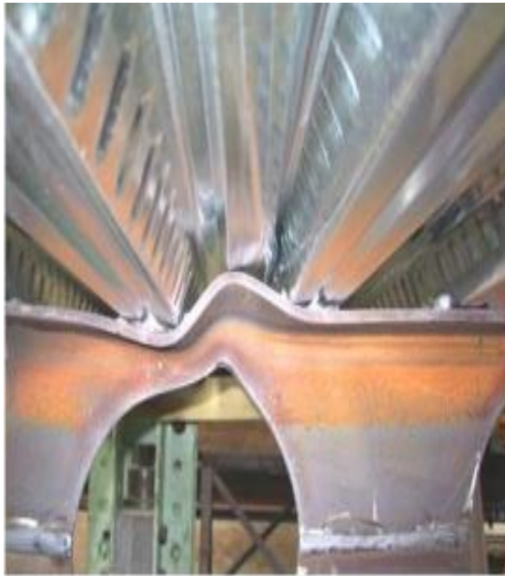
Şekil 2.13. Kirişte oluşan plastik mafsalları (Durif, Bouchaïr, and Vassart 2013)
