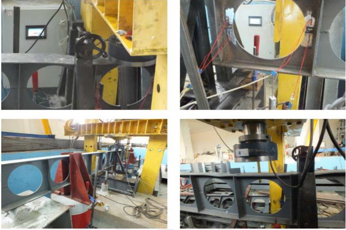
Şekil 4.18. IPN_DBPK_240 Düşey berkitmeli kirişin yükleme durumu ve göçme halleri
