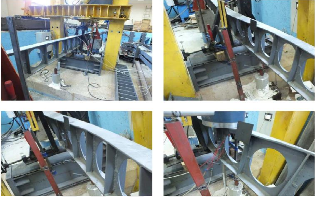
Şekil 4.9. IPN_DBPK_200 Düşey berkitmeli kirişin yükleme durumu ve göçme halleri
