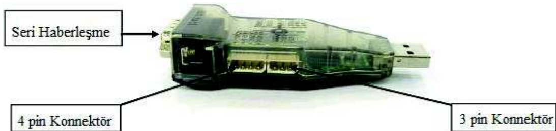
Şekil 3.12. Usb2Dynamixel haberleşme portları [36].
