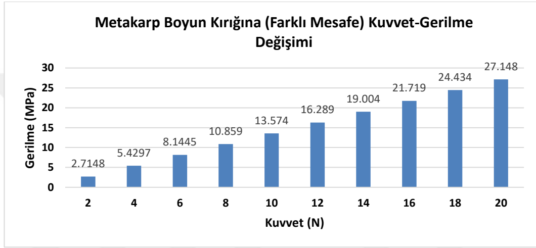
Şekil 5.10. Metakarp boyun kırığına eşit mesafelerden uygulanan kuvvet değişimine bağlı maksimum gerilme değerleri değişim grafiği.
