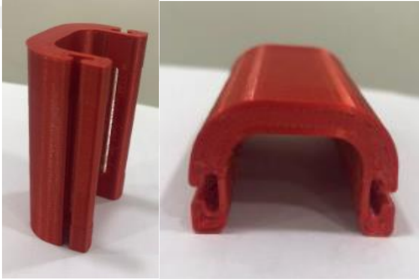
Şekil 3.11. Tasarlanan splintin 3D yazıcı kullanılarak elde edilmiş modeli.
