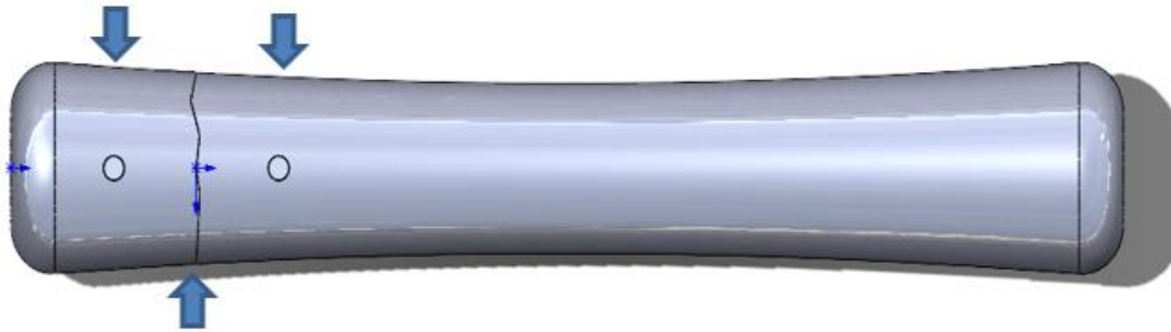
Şekil 3.7. Metakarpal boyun kırığının modellenmesi (eşit mesafe).
