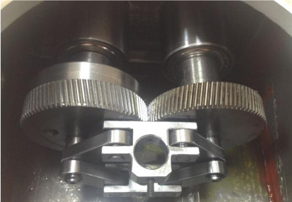
Resim 4.7 Rhombic dişlilerinin montaj hali
