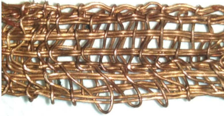
Resim 4.9 Rejeneratör malzemesi bakır tel örgüsü
