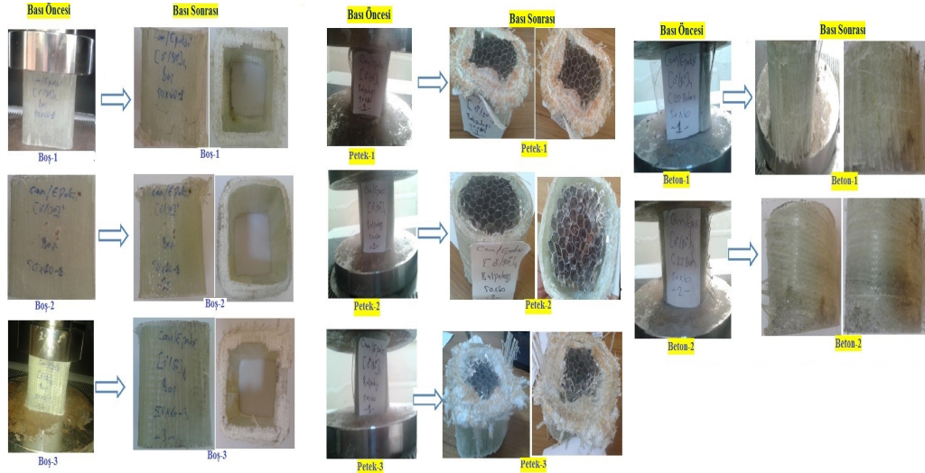
Şekil 4.9. 50 mm x 50 mm x 60 mm boyutlu cam/epoksi kare tüpte deformasyon aşamaları
