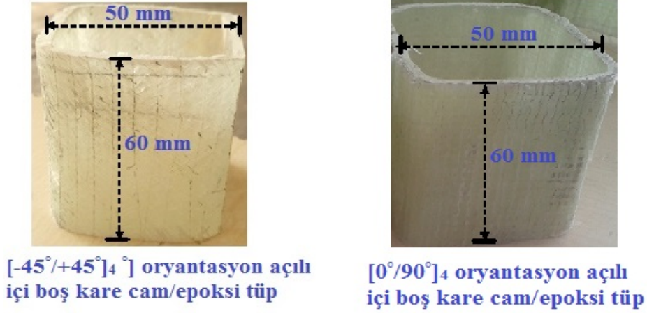
Şekil 3.4. 50 mm x 50 mm x 60 mm boyutlu [-45^\circ/+45^\circ]_4 ve [0^\circ/90^\circ]_4 oryantasyon açılarına sahip içi boş cam/epoksi kare tüplerin boyutları
