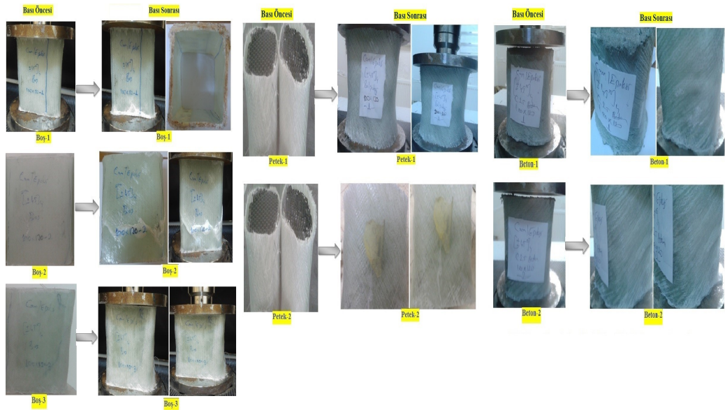
Şekil 4.4. 100 mm x 100 mm x 120 mm boyutlu cam/epoksi kare tüpte deformasyon aşamaları
