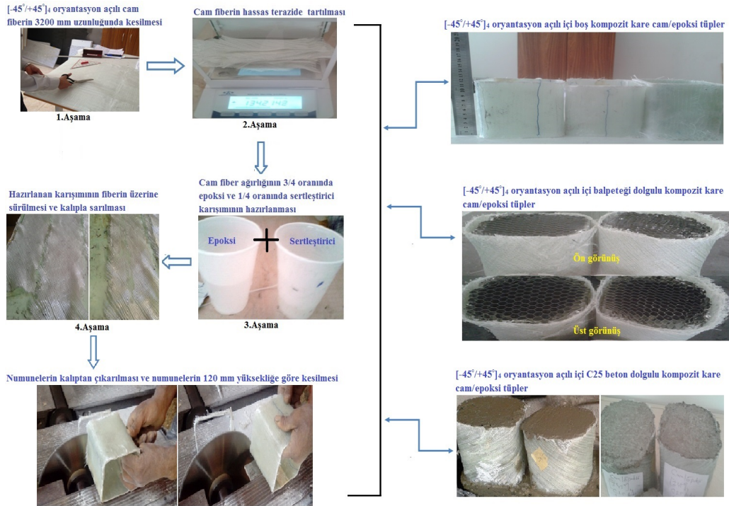
Şekil 3.8. 100 mm x 100 mm x 120 mm boyutlu [-45^\circ/+45^\circ]_4 oryantasyon açılı cam/epoksi kare tüpün üretim aşamaları
