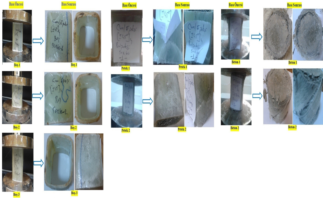
Şekil 4.3. 50 mm x 50 mm x 60 mm boyutlu cam/epoksi kare tüpte deformasyon aşamaları
