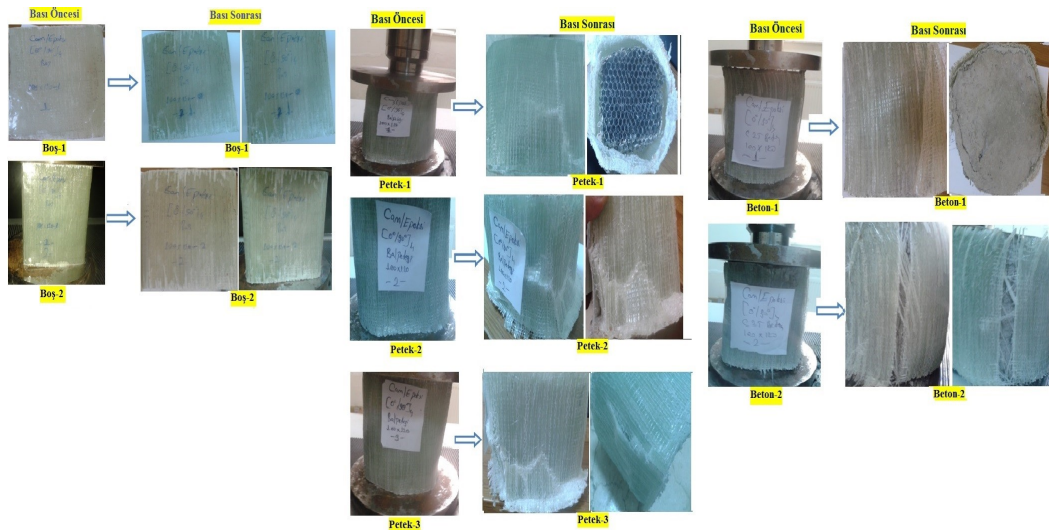
Şekil 4.10. 100 mm x 100 mm x 120 mm boyutlu cam/epoksi kare tüpte deformasyon aşamaları
