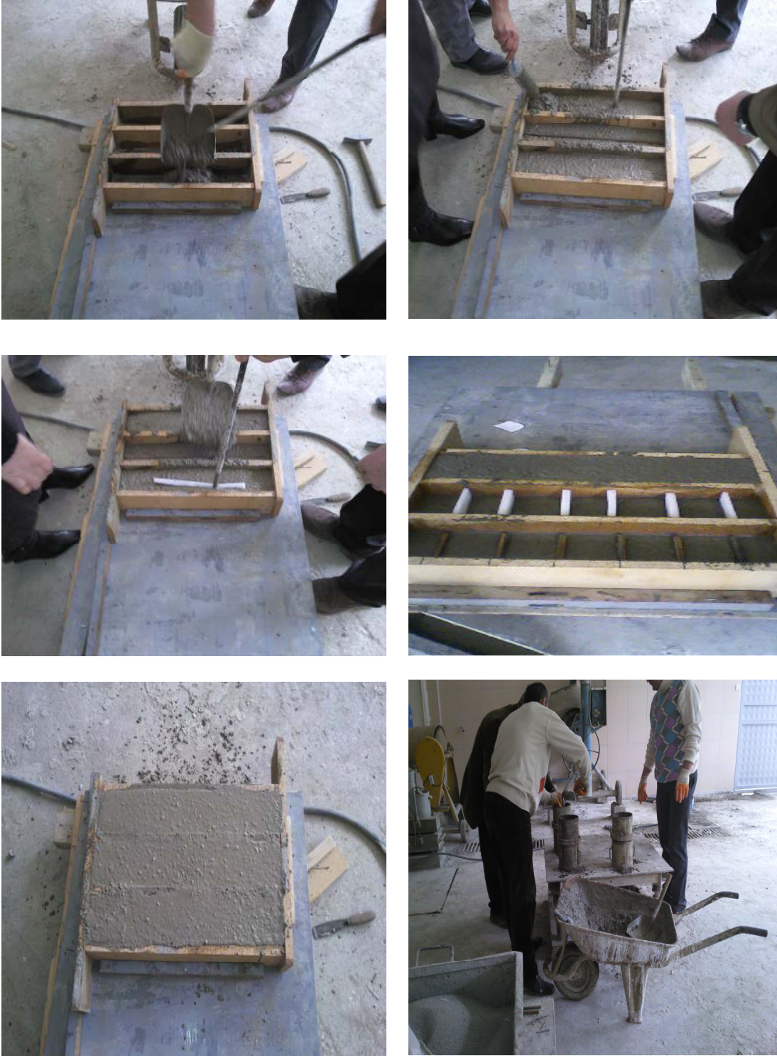
Şekil 4. Deney numunelerinin hazırlanma aşamaları
