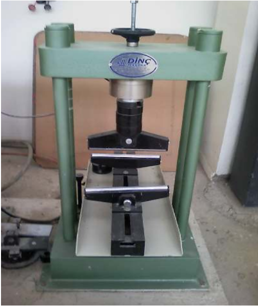
Şekil 27. Eğilme Dayanım deneyi için kullanılan ekipman
