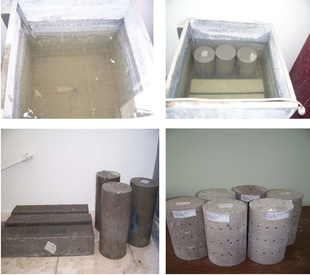
Şekil 5. Beton kür aşaması ve kür sonrası kuruma
