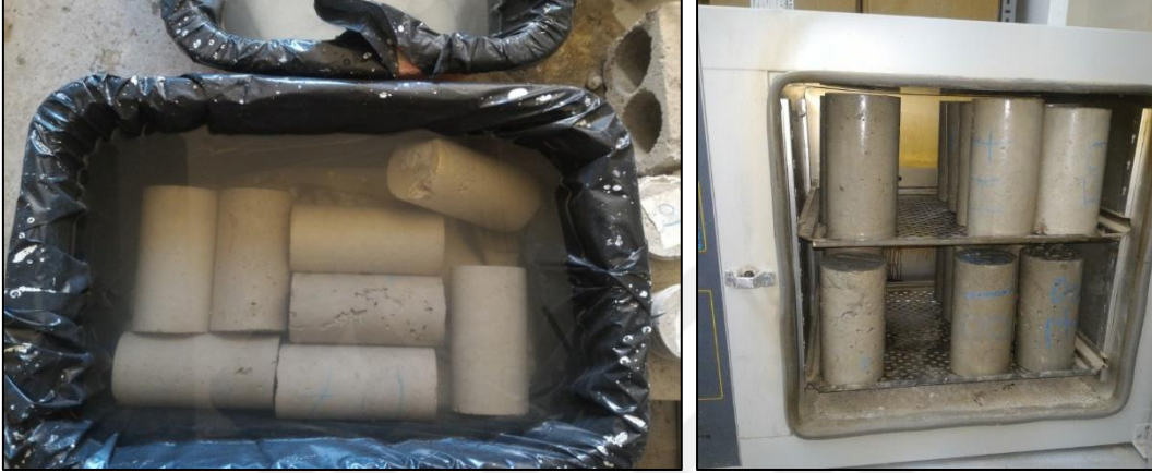
Şekil 2.6. Sülfat testi ıslanma - kuruma döngüsü
