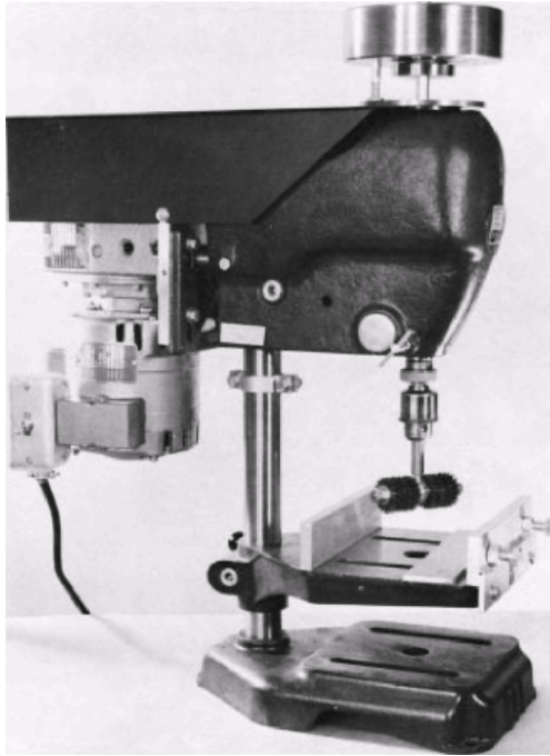
Resim 3.5. Aşındırma makinesi prensibi
