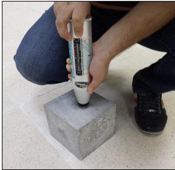
Şekil 5.11. Sertleşmiş betonda Schmidt çekici ile beton yüzey sertliği ölçümü
