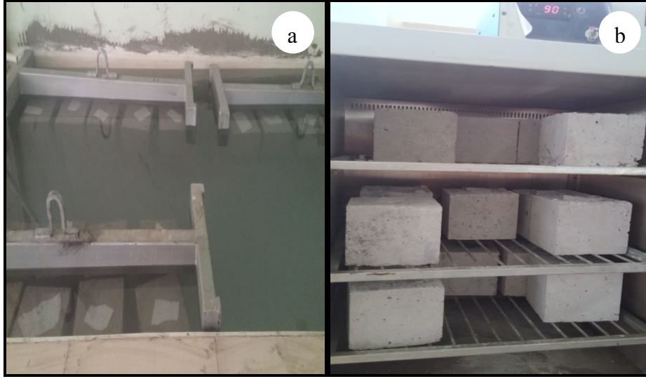
Şekil 5.9. Beton örneklerin a) Kür İşlemi, b) Etüv İşlemi
