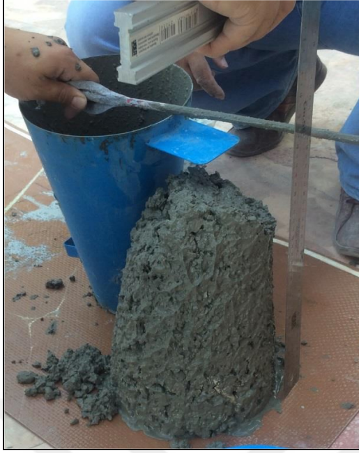
Şekil 5.5. Taze beton kıvam ölçümü
