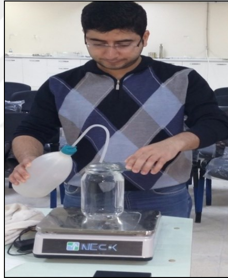
Şekil 5.3. Karışım agregalarının özgül ağırlıklarının bulunması
