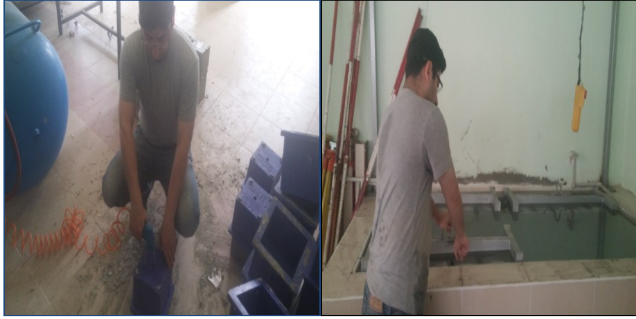
Şekil 5.7. Beton numunenin kalıptan çıkarılması ve kür havuzuna konması
