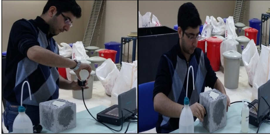
Şekil 5.10. Sertleşmiş betonda ultrases hız ölçümü
