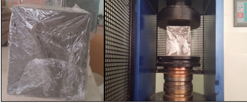
Şekil 5.12. Numunelerin strele sarılması ve kırılması
