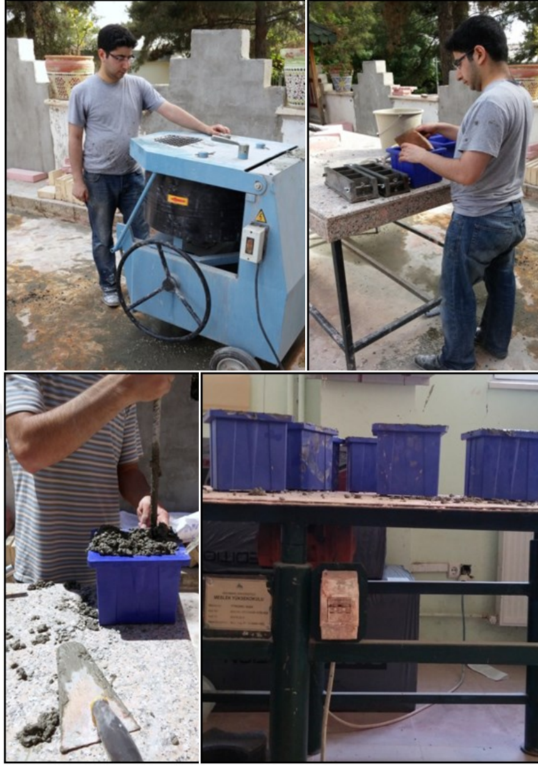
Şekil 5.4. Beton döküm aşamaları
