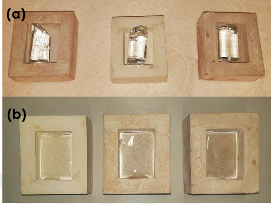
Görsel 3.30. (a) ısıt işlem öncesi AC-GP karışımıyla hazırlanan kalıp içerisindeki rod cam görüntüsü, (b) ısıt işlem sonrası AC-GP karışımıyla hazırlanan kalıp içerisindeki rod cam görüntüsü (Filiz, 2020)
