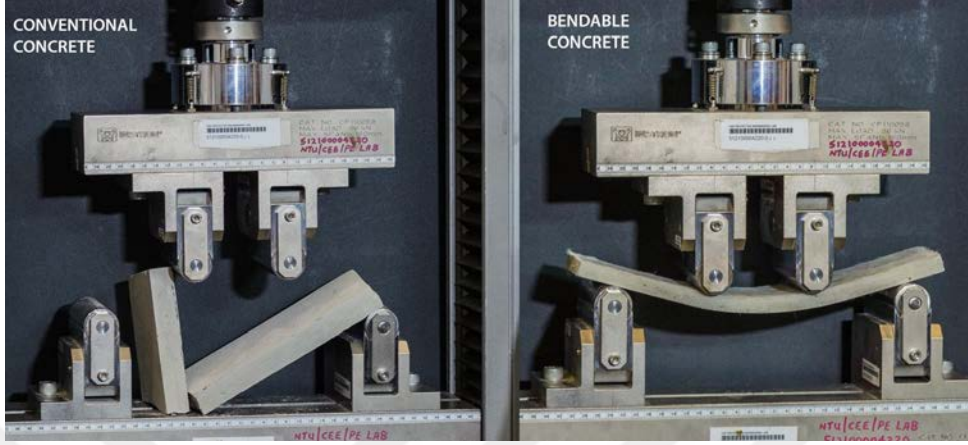
Görsel 2.8 NTU'da geliştirilen konvansiyonel beton ve bükülebilir beton 19
