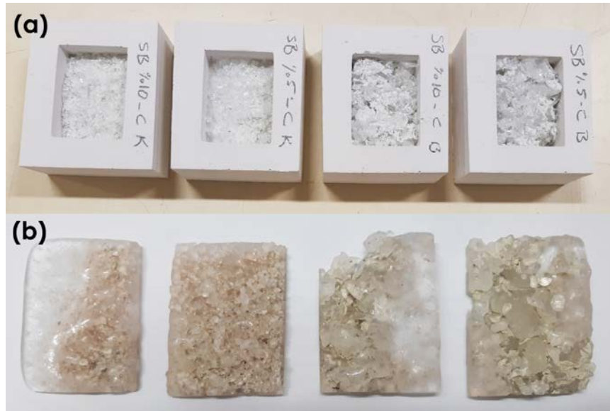
Görsel 3.35. (a) Fırlama işlemi öncesi, (b) Fırlama işlemi sonrası görüntüsü (Filiz, 2022)
