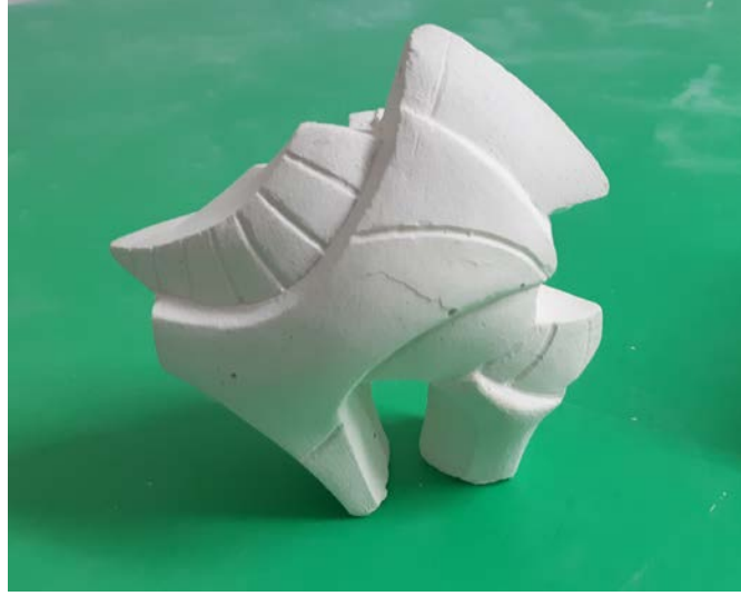
Görsel 3.8. Isıl işlem sonrası SB-GP karışımıyla oluşturulmuş formlar (Filiz, 2022)
