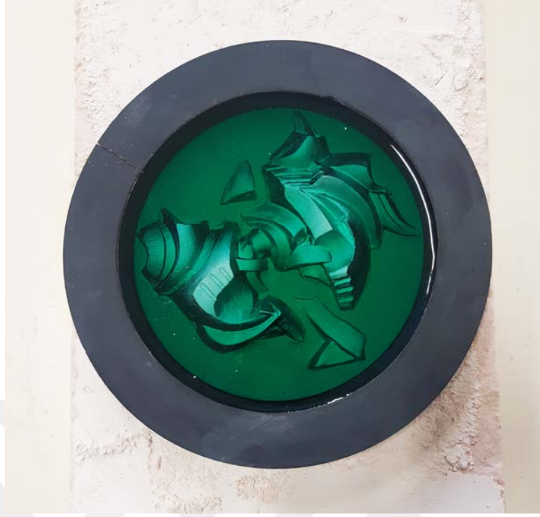
Görsel 3.33. Isıl işlem sonrası kalıp ve cam görüntüsü (Filiz, 2022)
