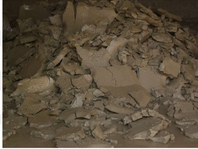
Şekil 3.4. Filtre pres ile elde edilmiş susuzlaştırılmış çamur
