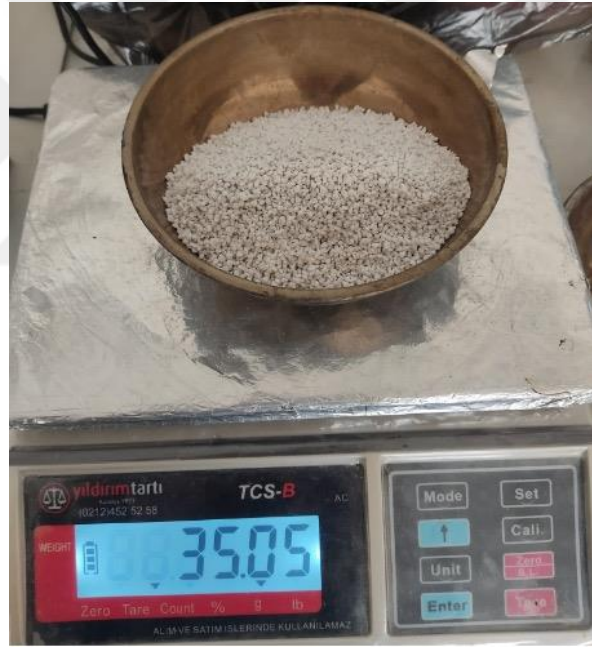
Şekil 19. Hassas terazi ile elekte kalan GP agregaların tartılması
