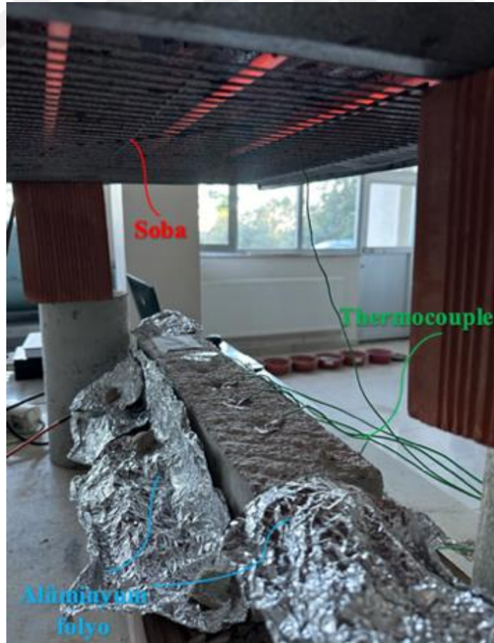
Şekil 66. Thermocouple ile sıcaklık ölçümü düzeneği
