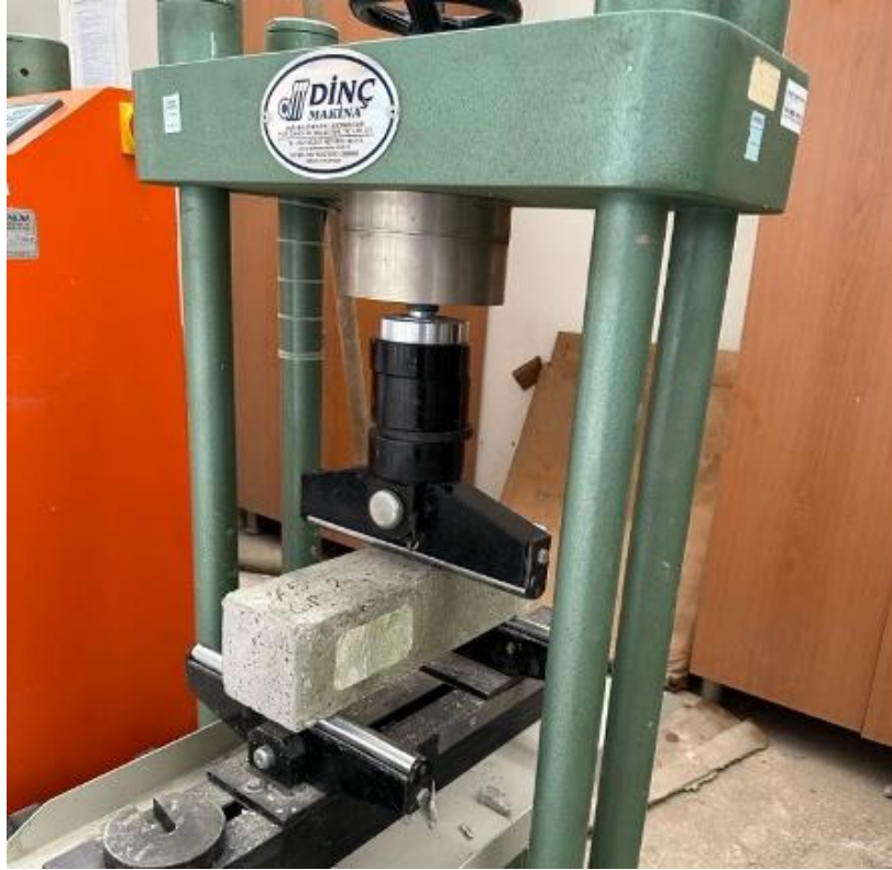
Şekil 52. Eęilme test düzeneęine yerleştirilen kiriş numune
