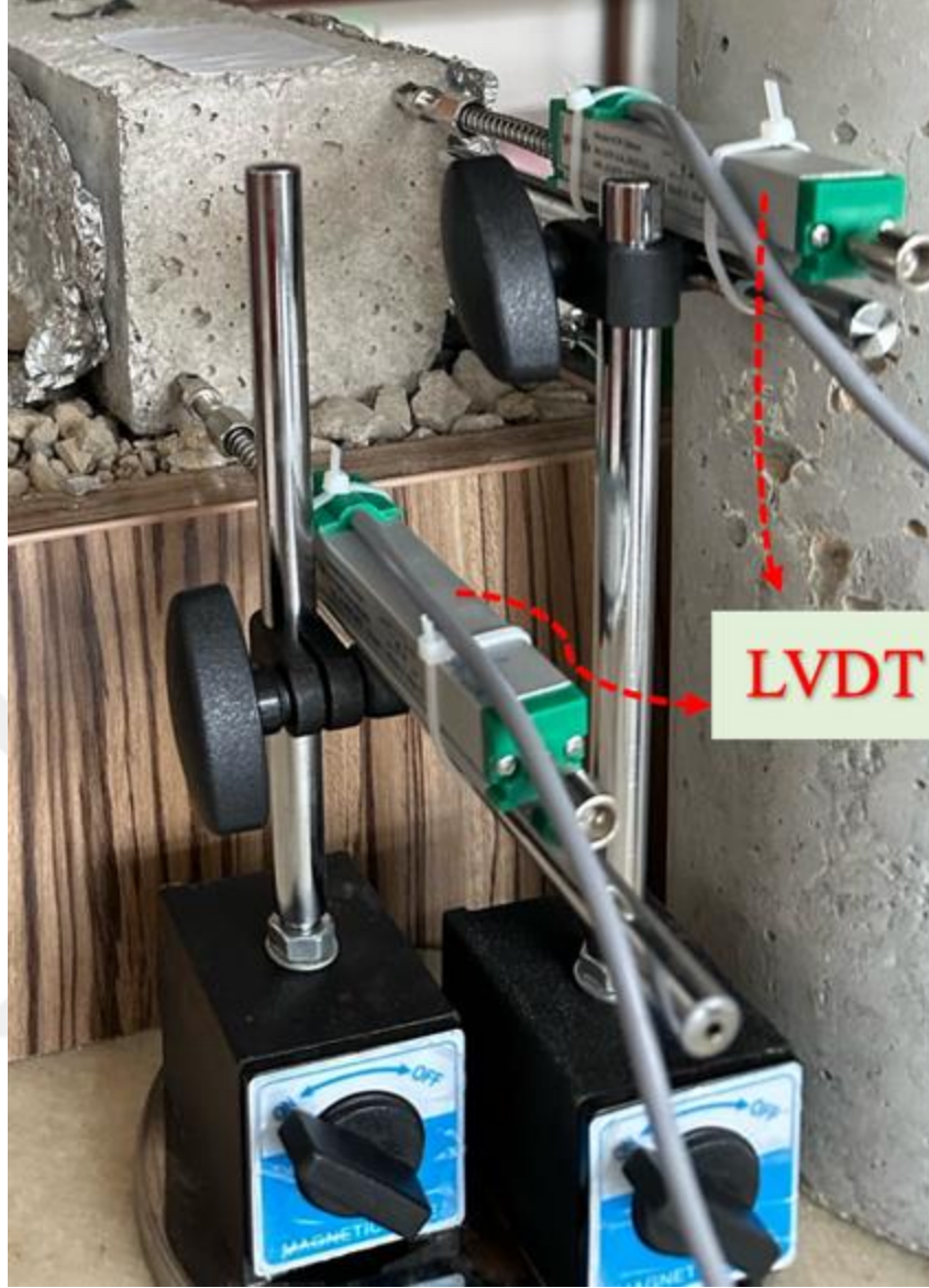
Şekil 75. LVDT sensörlerin sabitlenmesi
