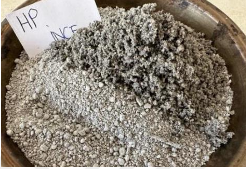
Şekil 31. HP2 ince ham perlit agregası
