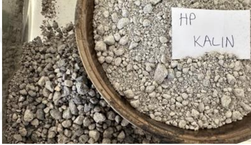
Şekil 36. Doymun kuru yüzey ve kuru haldeki ham perlit agregası HP1
