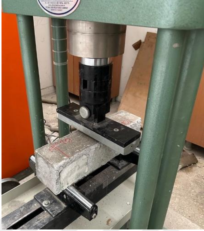
Şekil 56. Eğilmede çekme test düzeneğine yerleştirilen HP numune
