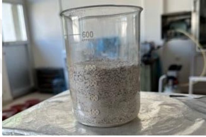
Şekil 35. Hacmi belli kaptaki gevşek halde HP2 agregasının tartılması
