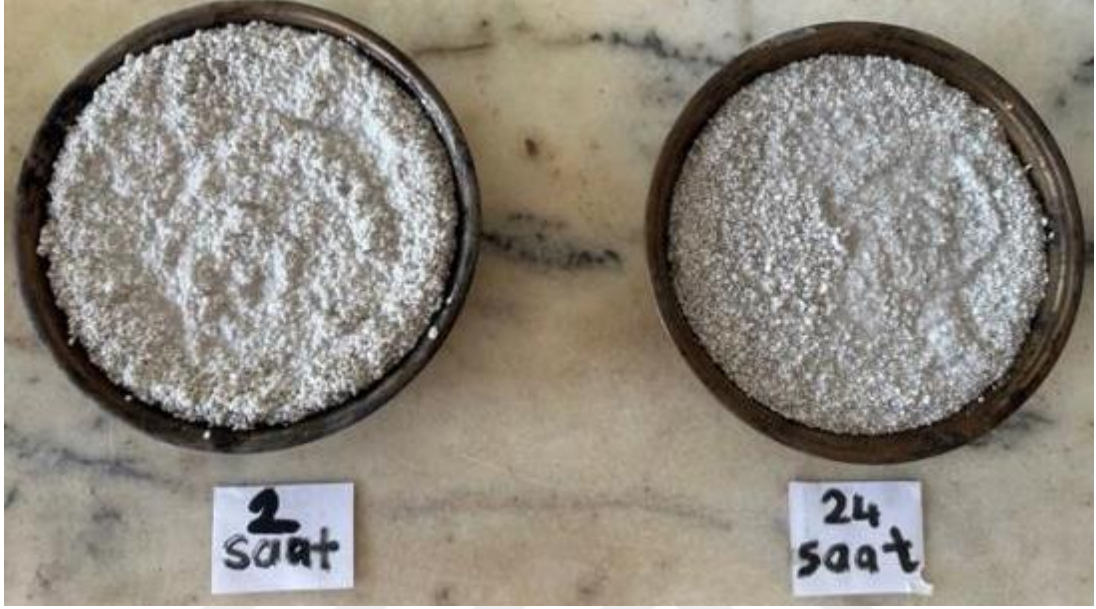
řekil 26. Su emme deneyi için suda bırakılan GP agregası (2 ve 24 saat)
