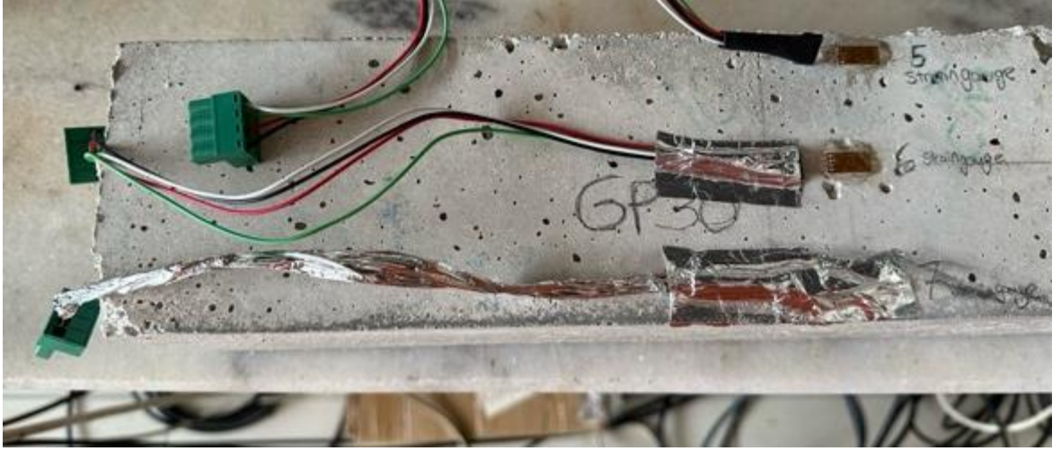
Şekil 79. Straingauge sensörlerin yapıştırılması ve ısıdan korunması
