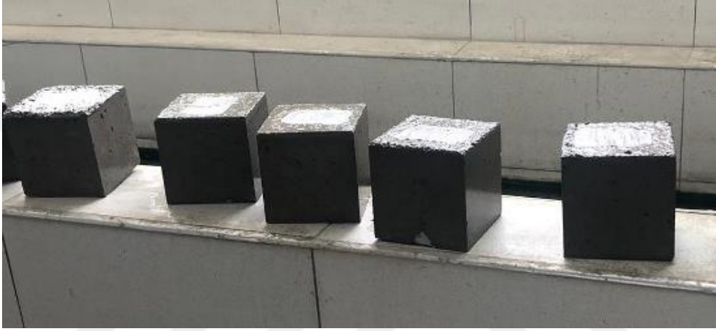
Şekil 55. Kür süresi dolan numunelerin havuzdan çıkarılması
