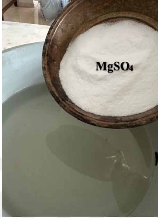
Şekil 83. Magnezyum sülfat çözeltisinin hazırlanması
