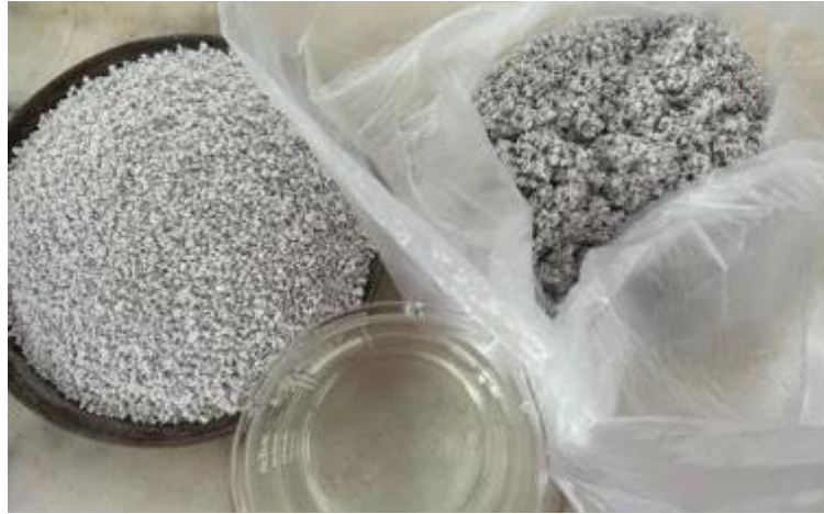
Şekil 39. GP agreganın suya doymun hale getirilmesi
