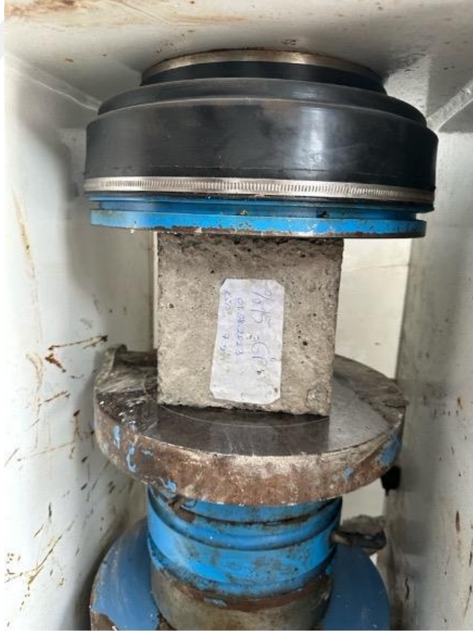
Şekil 51. Basınç düzeneğine yerleştirilen GP küp numune
