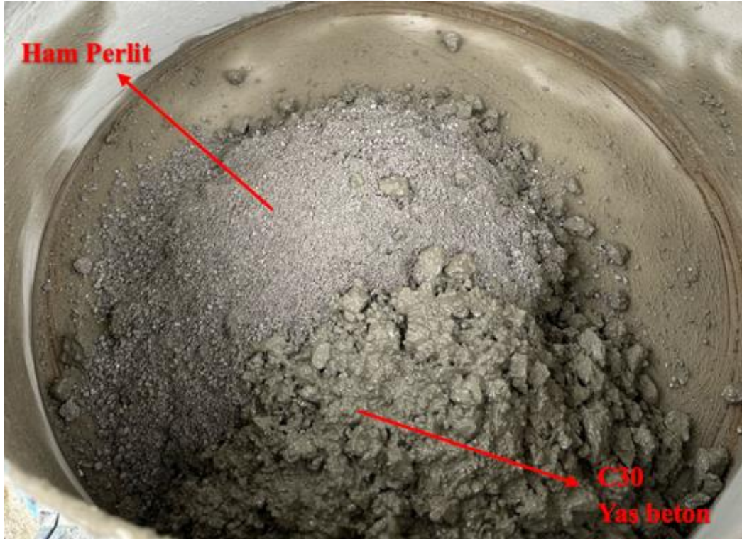
Şekil 48. HP agregasının karışıma aşamalı olarak eklenmesi
