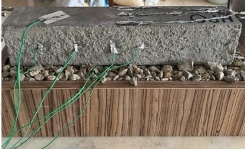
Şekil 71. Yatayda sıcaklık ölçümü
