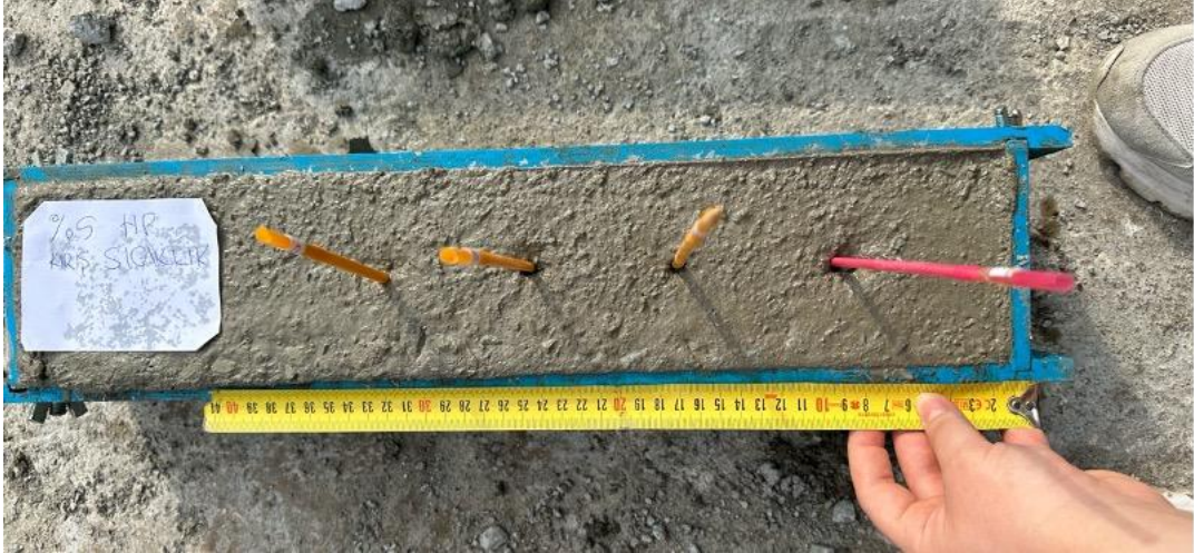
Şekil 50. HP kiriş numunesinde pipet yerleşimi
