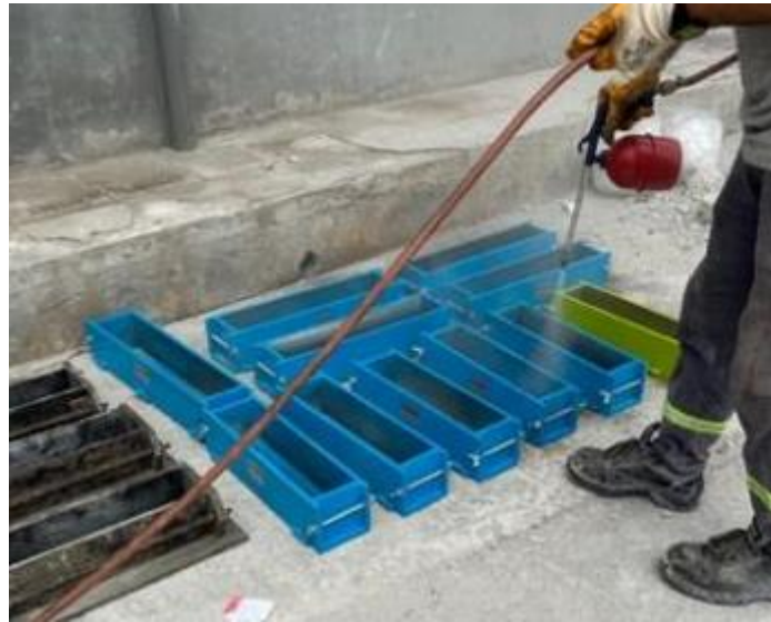
řekil 41. Beton numune kalıplarının yaėlanması
