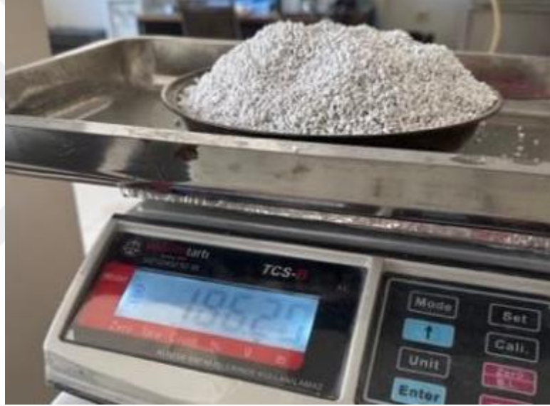
Şekil 38. Beton numune için gerekli GP agregasının tartılması
