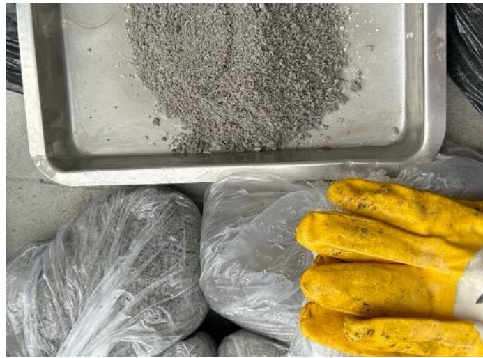
Şekil 46. HP karışımlarında kullanılacak miktarda hazır edilen perlit agregaları
