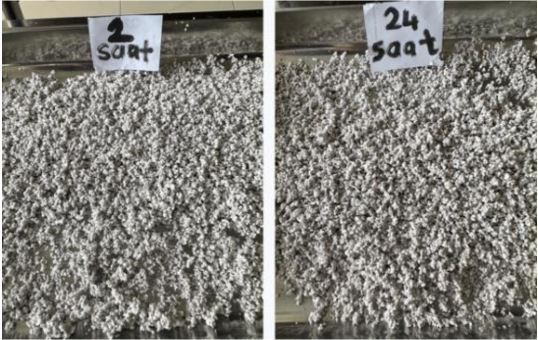
řekil 27. Suda bekletilip süzüldükten sonra GP3 agregası (2 ve 24 saat)
