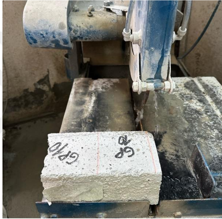
Şekil 58. Beton spiral ile numune kesilmesi
