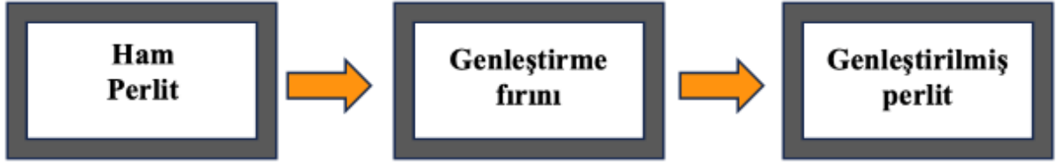
Şekil 9. Perlit agregasının ham halden genleştirilmiş hale geçiş şeması
