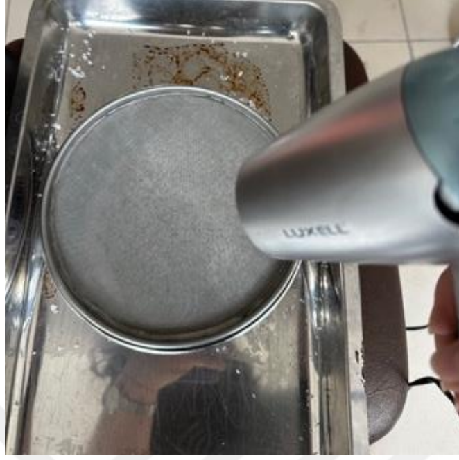
Şekil 28. GP agregası yüzeyindeki suyun uzaklaştırılması
