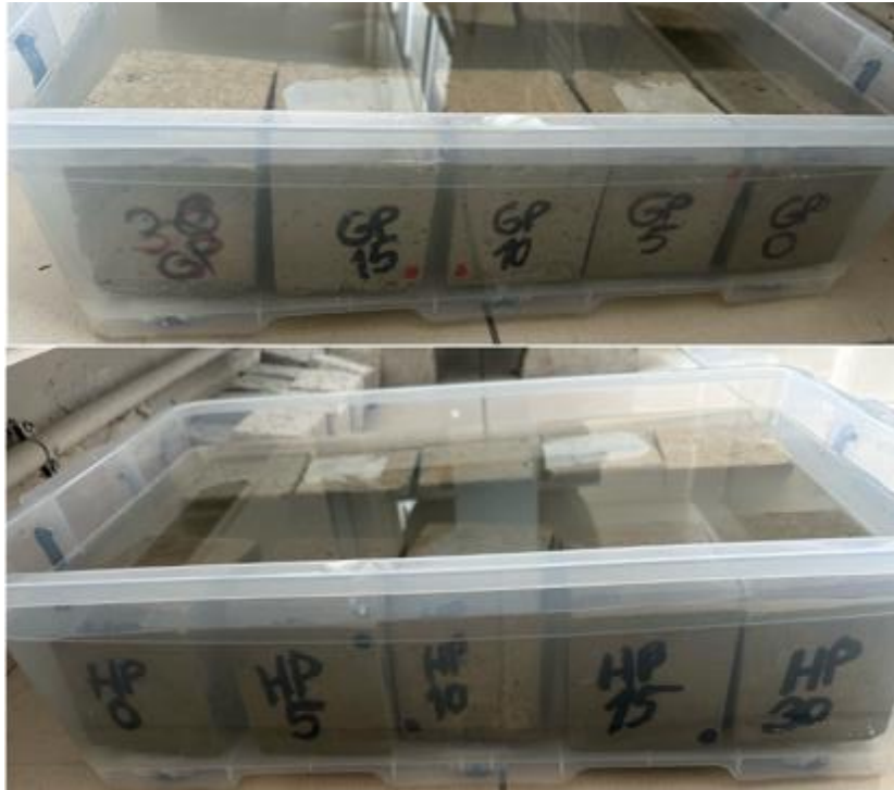
Şekil 84. MgSO_4 çözeltisine bırakılan GP ve HP numuneler
