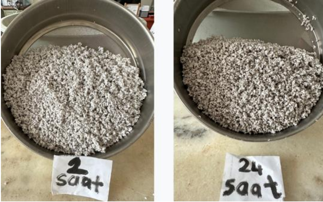
Şekil 29. Doygun kuru yüzey haline gelen GP3 agregası (2 ve 24 saat)
