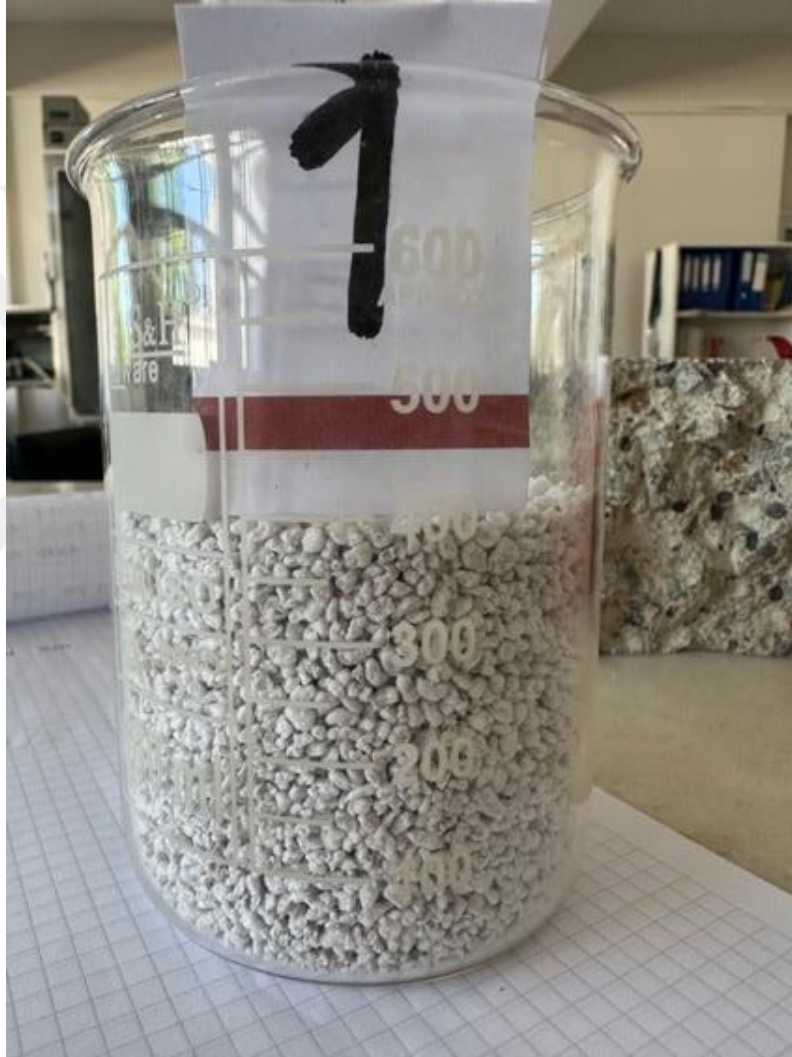
Şekil 25. Hacmi belli kapta genişletilmiş perlit agregası
