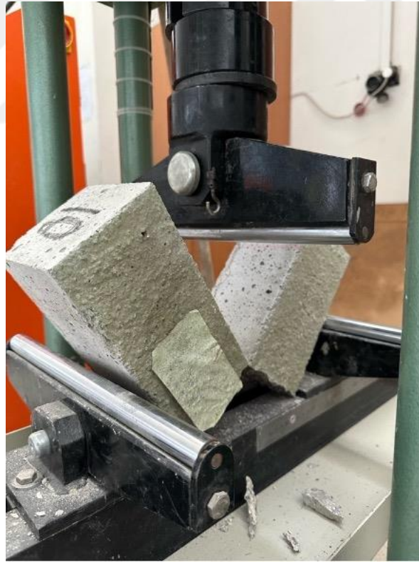
Şekil 54. Eğilme testi sonucu gevrek kırılan GP kiriş numunesi
