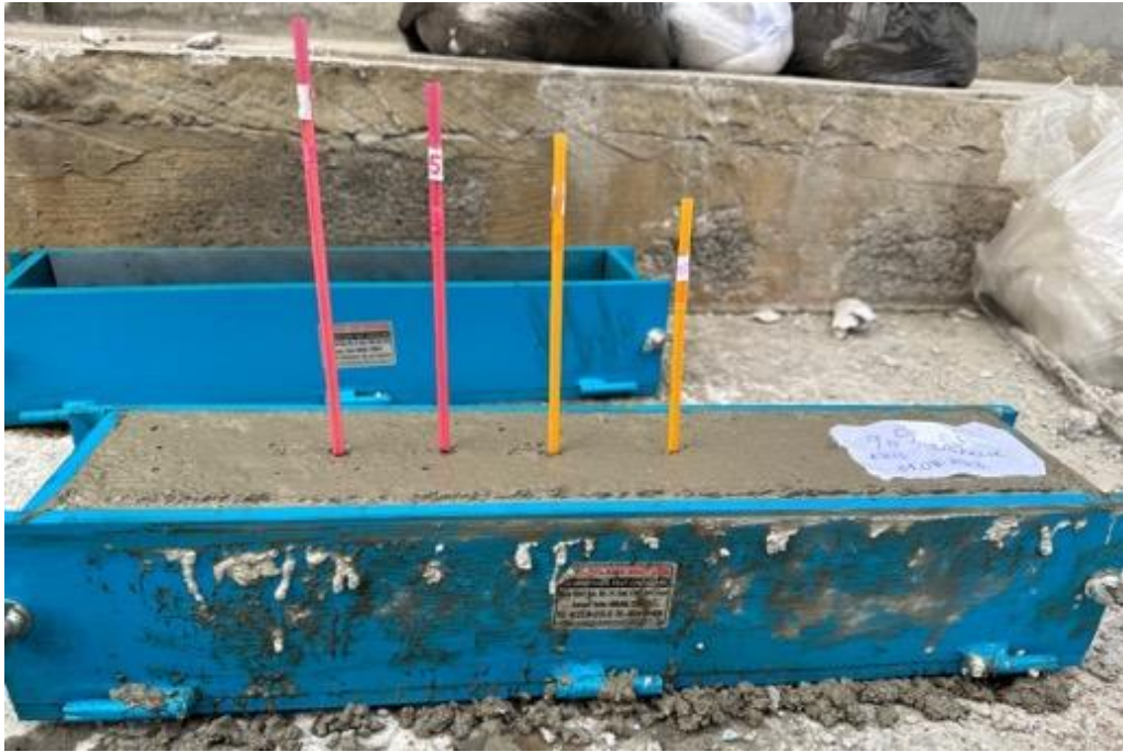
Şekil 43. Sıcaklık ölçümü için pipetle delik oluşturulması
