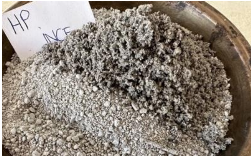
Şekil 37. Doymun kuru yüzey ve kuru haldeki ham perlit agregası HP2
