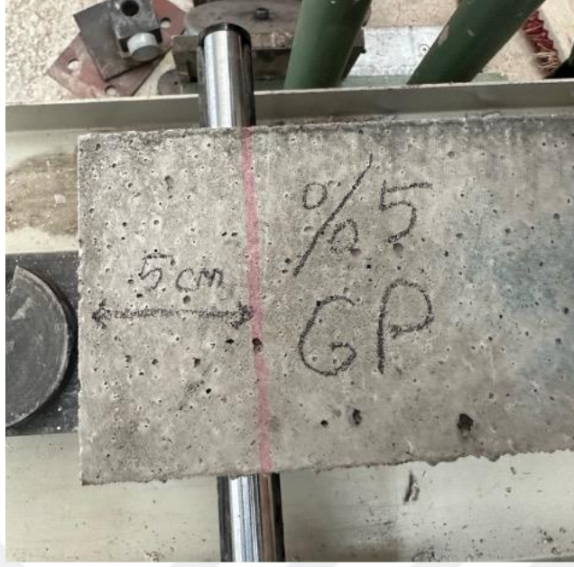
Şekil 53. Kiriş numunenin mesnetlere yerleştirilmesinin üstten görünüşü
