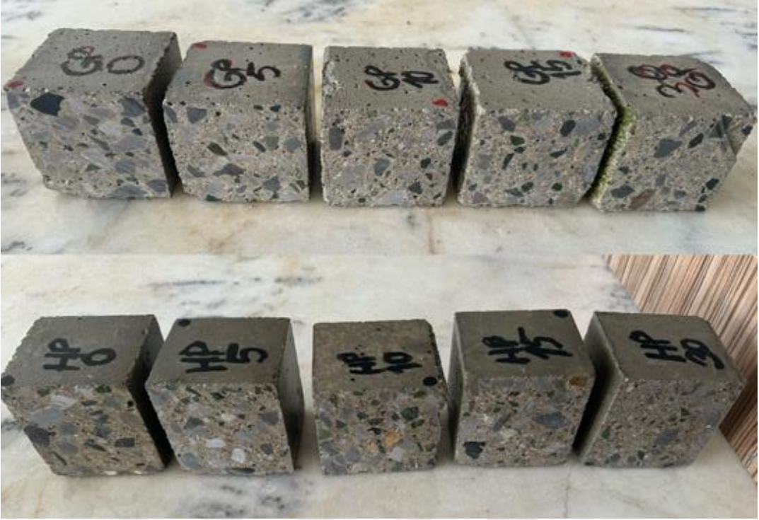
Şekil 85. 180 günlük MgSO_4 kürü sonunda GP ve HP numuneler
