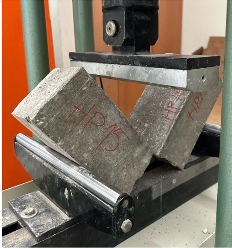
Şekil 57. Eğilme testi sonunda kırılan HP kiriş numune
