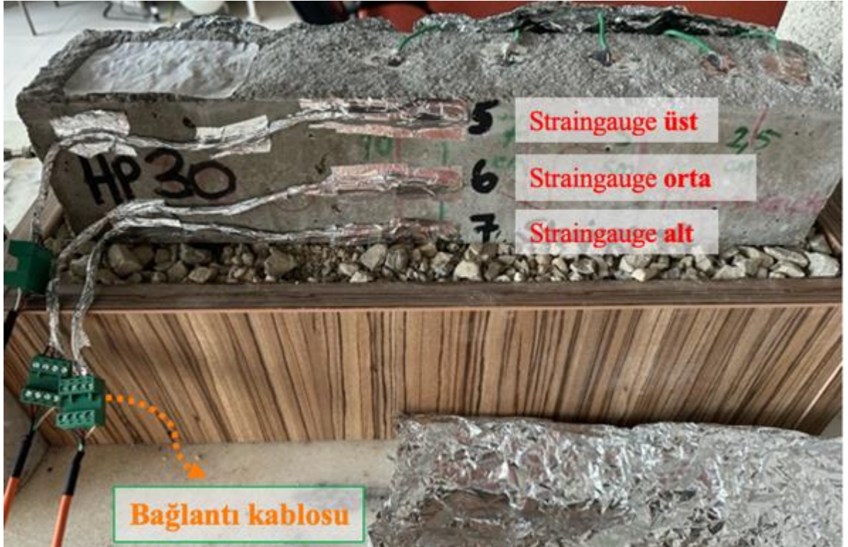
Şekil 80. Sıcaklık deneyinde straingauge sensörleri ile ölçüm
