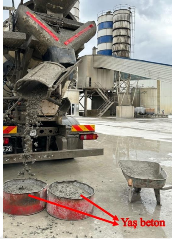
Şekil 47. Hazır beton mikserinden C30 yaş betonun alınması
