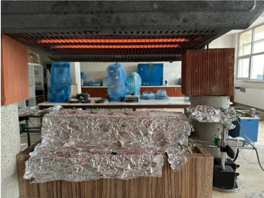
Şekil 74. LVDT sensörlerle sıcaklık deneyinde uzama ölçümü yapılması
