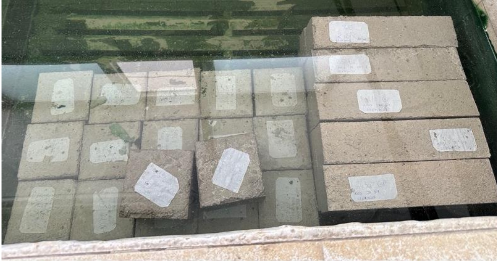
Şekil 45. Kür havuzunda 7, 28 ve 90 gün bekletilen GP numuneler
