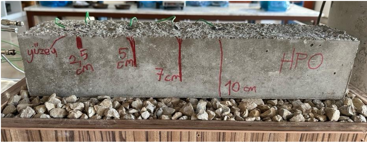
Şekil 69. Ham perlit kiriş numunesinde thermocouple yerleşimi
