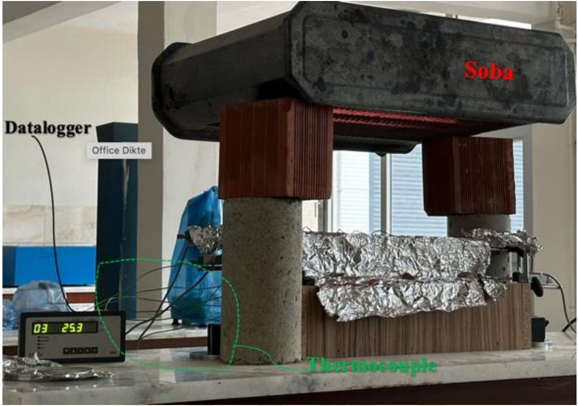
Şekil 68. Thermocouple ile sıcaklık ölçümü
