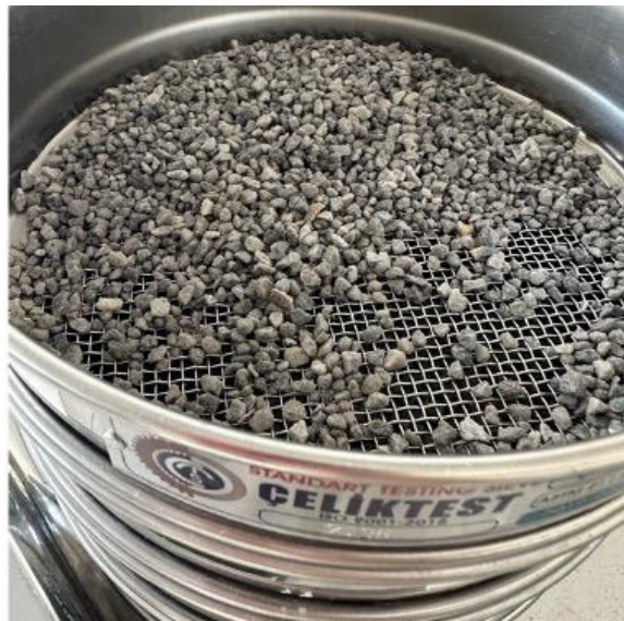
Şekil 32. Ham perlit elek analizi deneyi
