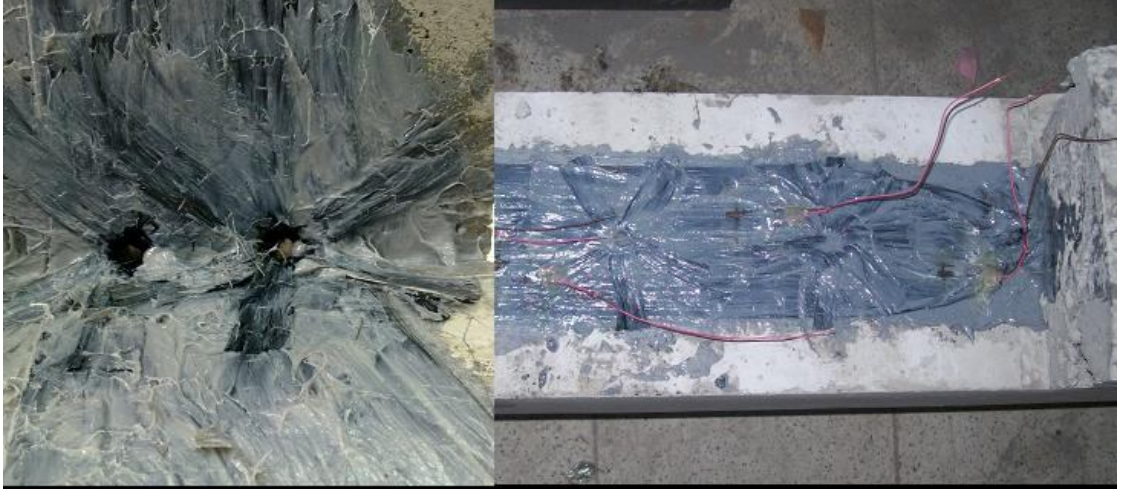
Resim 2.9. LP levha uçlarındaki fan ankraj ve LP bulon.
