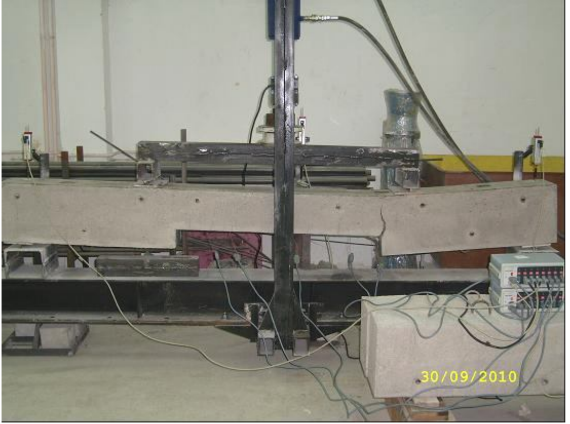
Resim 4.5. Deney Elemanının göçme şekli (Deney Elemanı-2)
