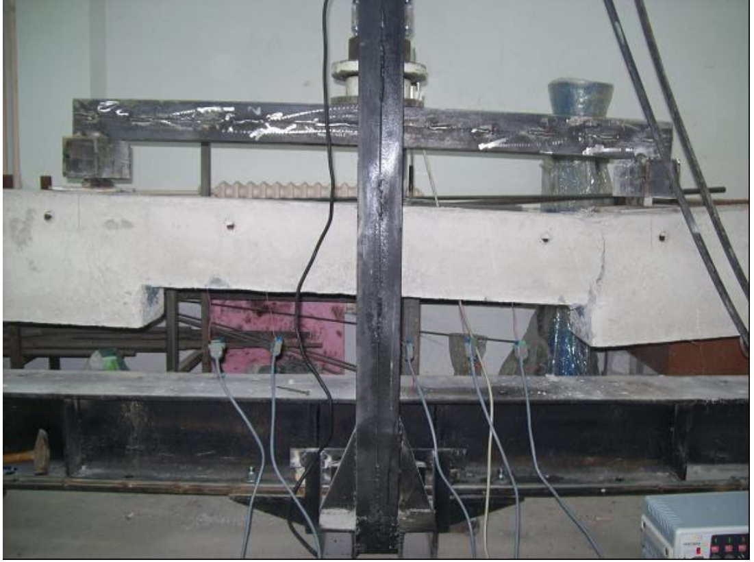
Resim 4.11. Deney Elemanının göçme şekli. (Deney Elemanı-4)
