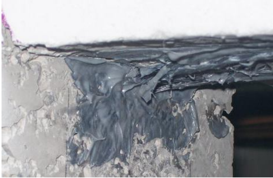
Resim 4.9. Ankrajın göçme şekli (Deney Elemanı-3)
