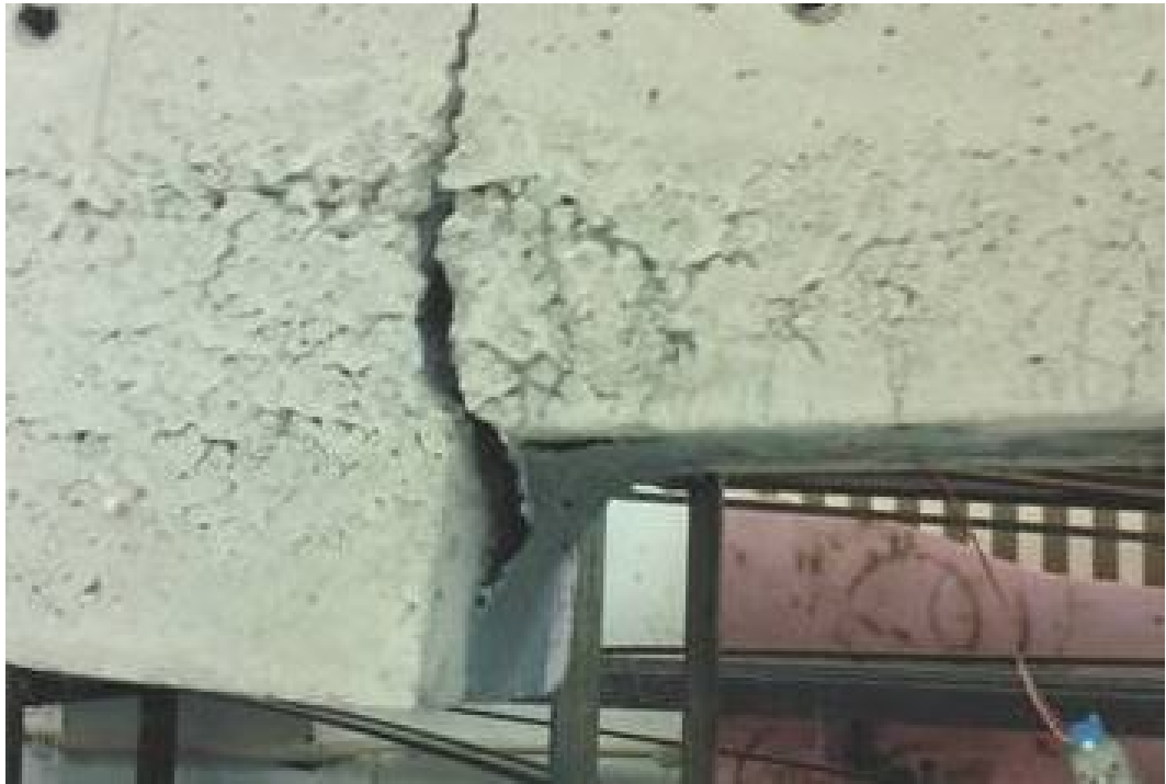
Resim 4.3. Ankrajın göçme şekli (Deney Elemanı-1)
