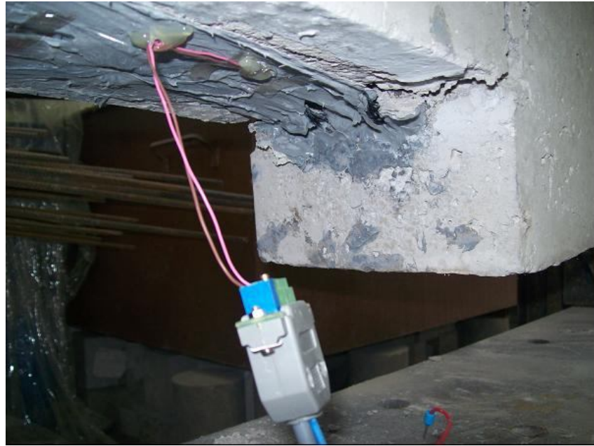
Resim 4.12. Ankrajın göçme şekli (Deney Elemanı-4)
