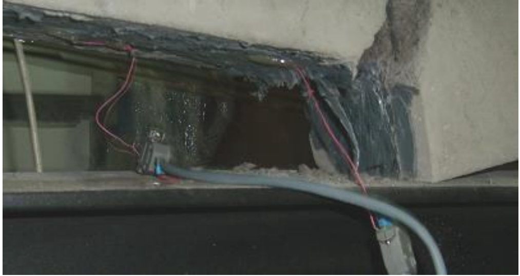
Resim 4.6. Ankrajın göçme şekli (Deney Elemanı-2)
