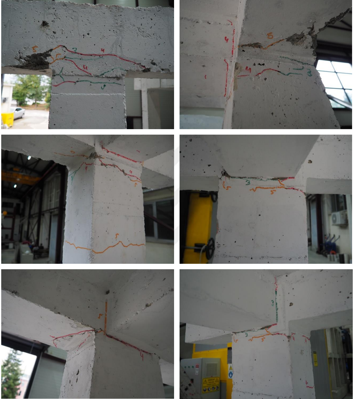
b. Sarsma masası deneyleri sonrasında 2.kat kolon üst ucunda ve birleşim bölgelerinde işaretlenen diğer hasarlar
