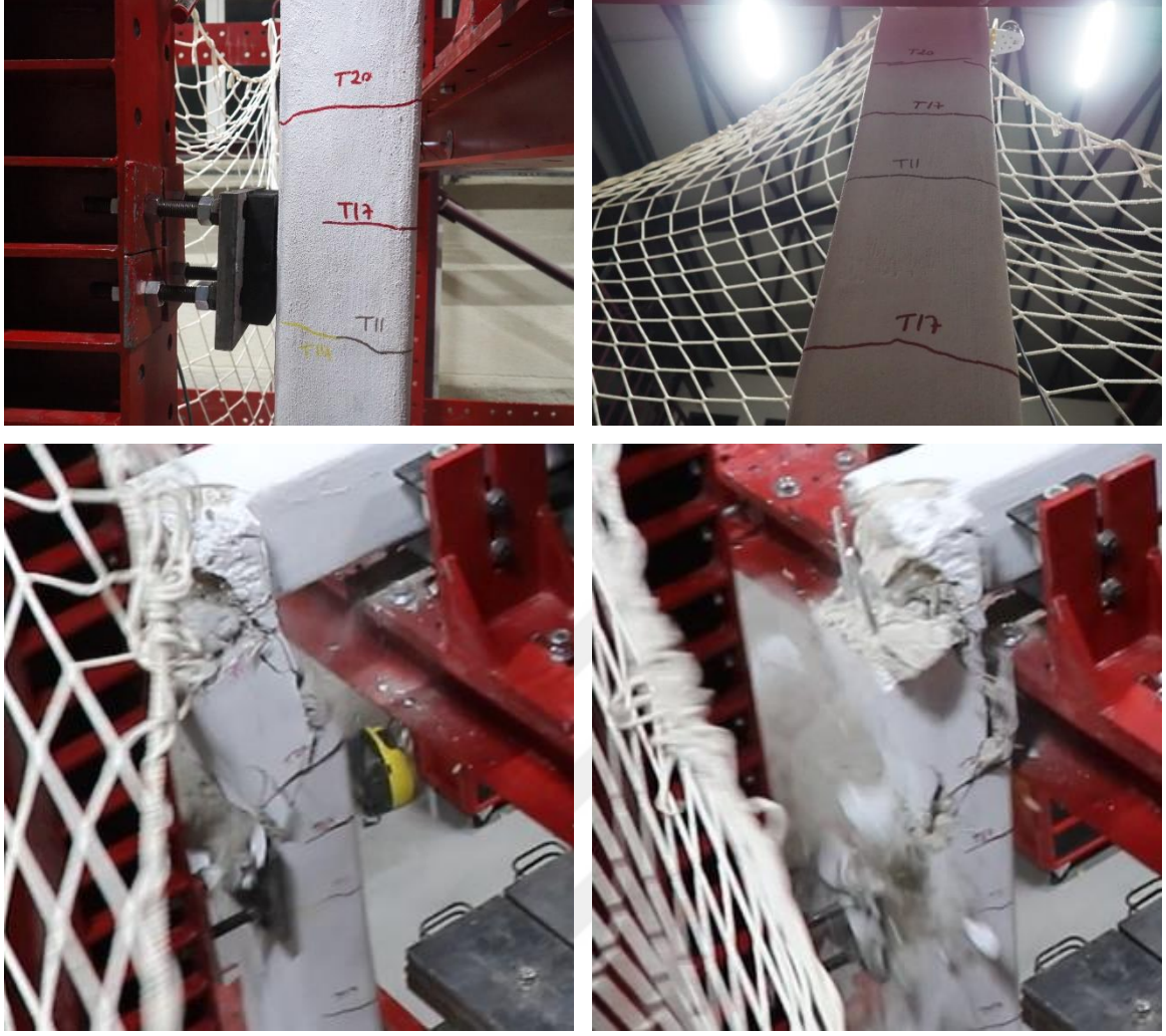
Şekil 2.57. Pilot deneylerde güçlendirilmemiş numunenin çarpışma bölgesinde meydana gelen hasarlar
