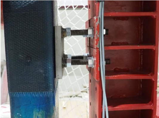
c. Ayarlanabilir çarpışma elemanları
