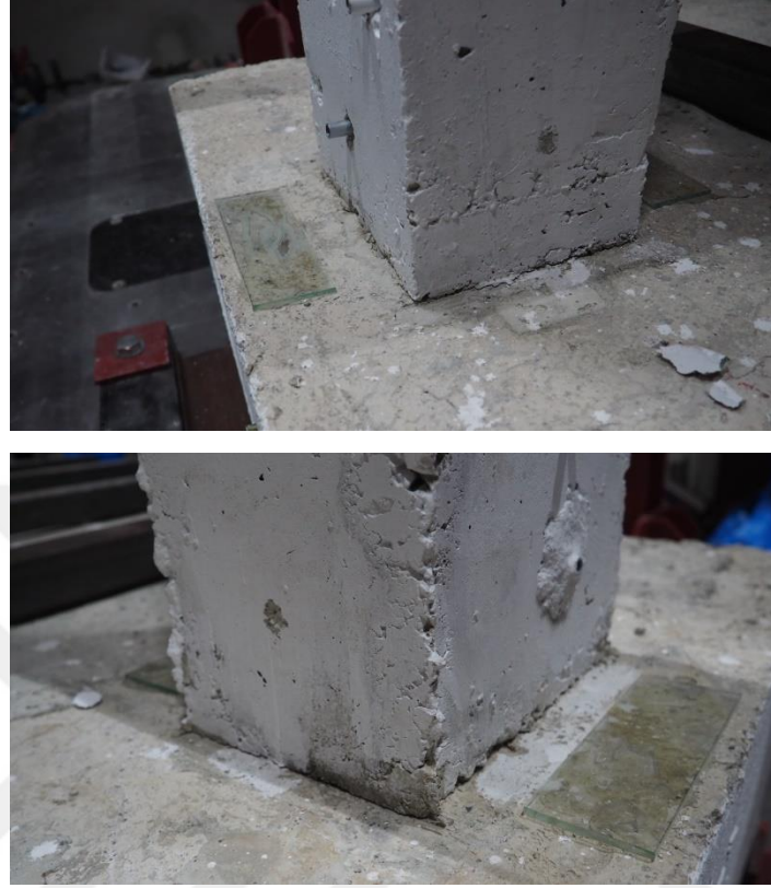
e. Sarsma masası deneyleri sonrasında temel-kolon arayüzünde meydana gelen ayrılımlar
