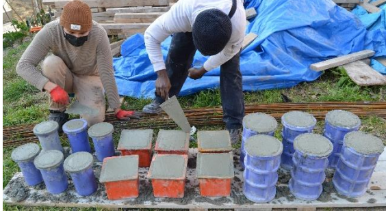
a. Temelden alınan numuneler
