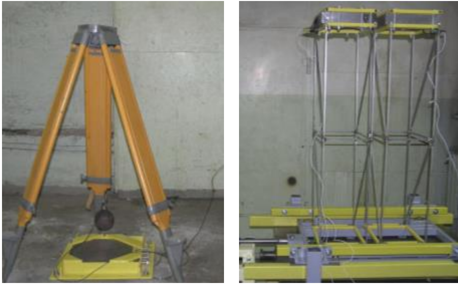
Şekil 1.3. Jankoski (2010) tarafından gerçekleştirilen serbest düşme ve sarsma masası deneylerine ait görseller
