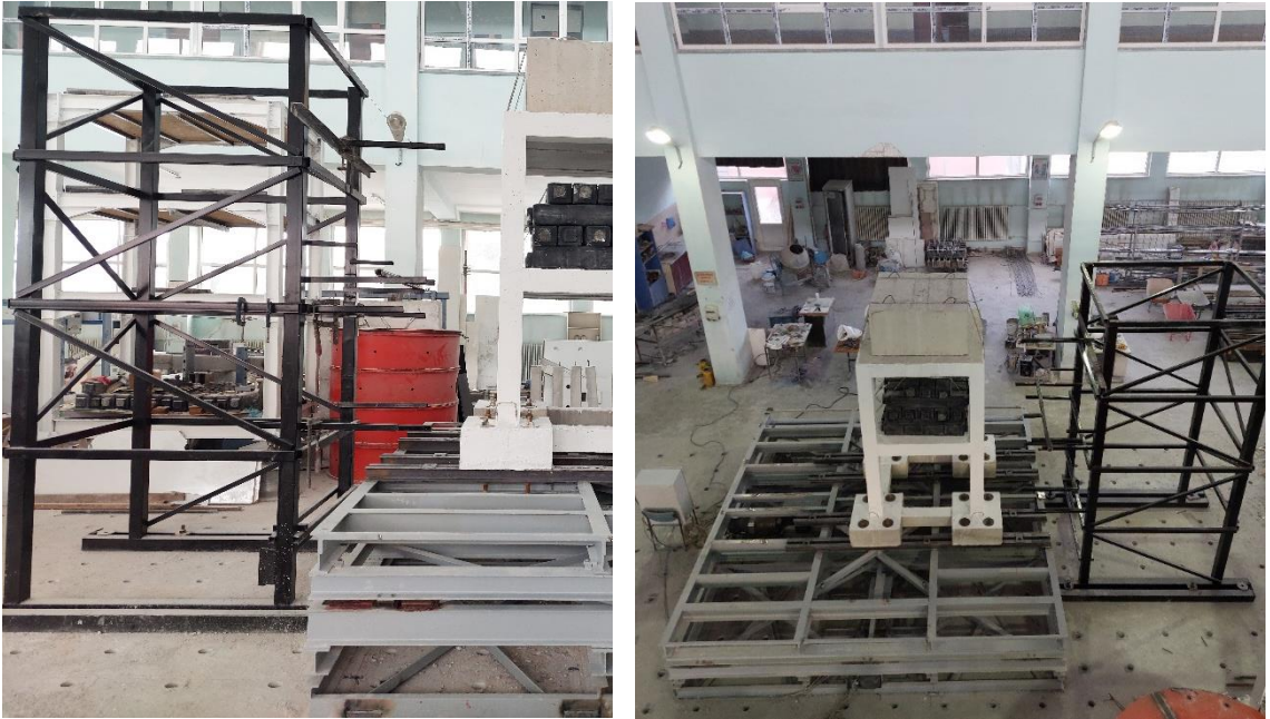
Şekil 3.32. Potansiyometrik cetvellerin bağlantısı için oluşturulan çelik karkas sistem
