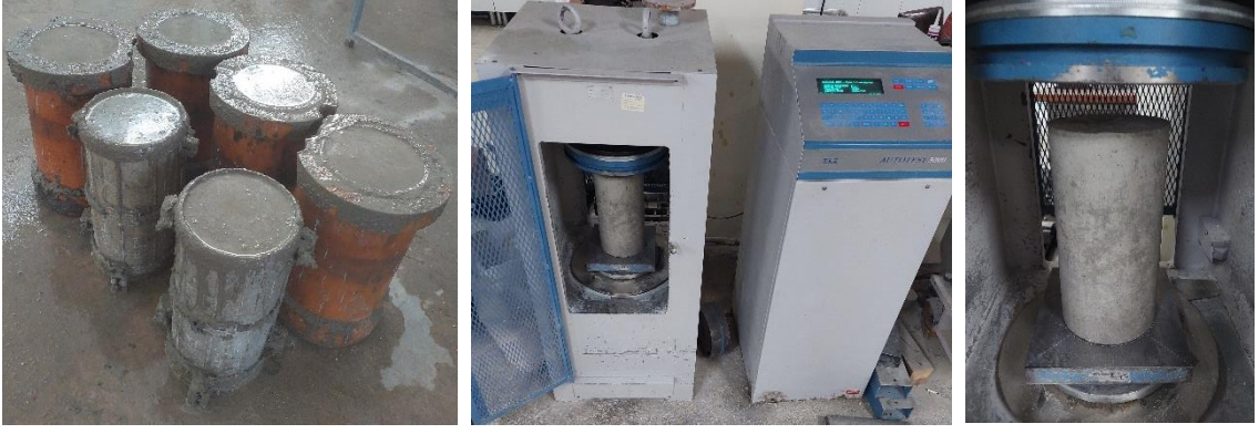
Şekil 3.64. Güçlendirme perdelerinde kullanılan betonun basınç dayanımı tayini
