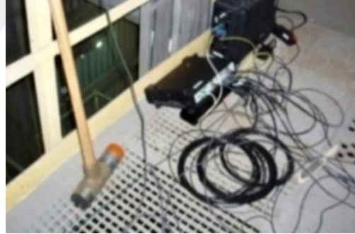
Şekil 2.63. 1. sistemin geleneksel modal analiz test ekipmanları (Grosel ve diğ., 2014)
