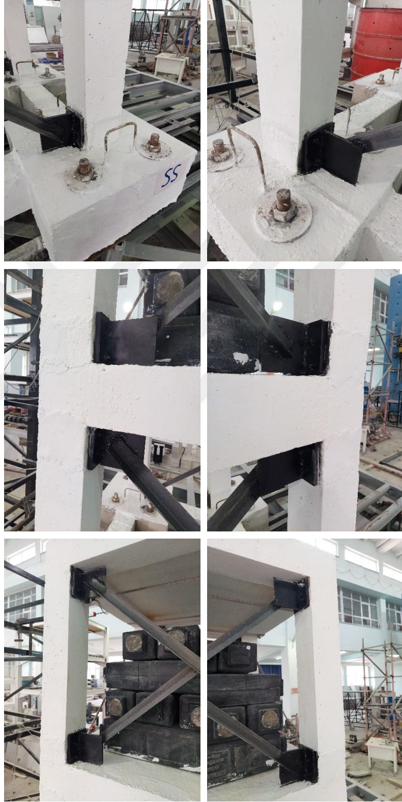
Şekil 4.8. SS numunesinin çelik çaprazlarla güçlendirilmiş durumu deneyleri sonrası detay görüşleri
