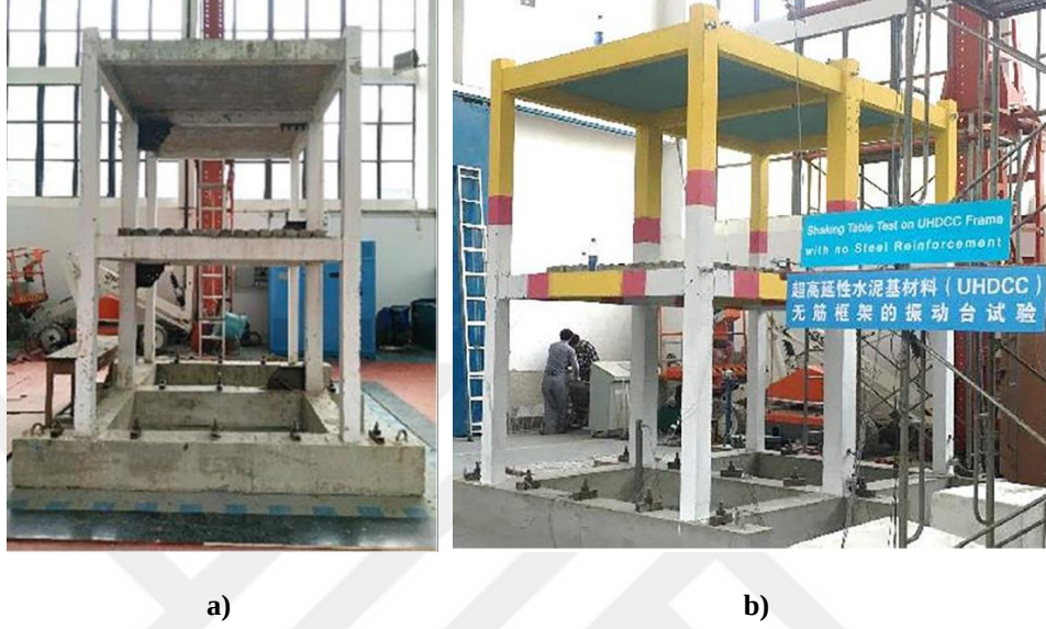
Şekil 2.15. Deney numuneleri; a) Geleneksel betonarme çerçeve, b) UHDFCC malzemesi ile üretilen betondan imal edilmiş çelik donatısız çerçeve (Yu ve diğ., 2018)
