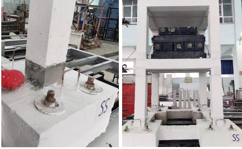
Şekil 3.54. SS numunesinde tijlerin epoksi ile kimyasal ankrajlanması
