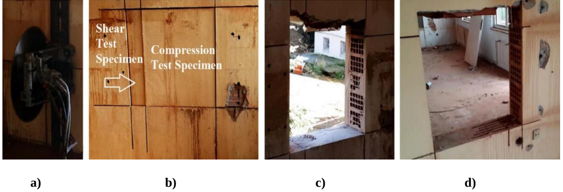
Şekil 2.44. Duvarlardan alınan örnekler; a) Duvar kesme makinesi, b) Kayma ve basınç testi numuneleri, c) Dış duvardan alınan örnek, d) İç duvardan alınan örnek (Aras, 2017)
