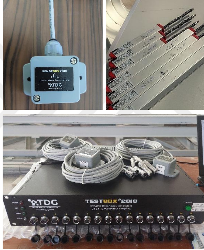
Şekil 3.30. Zorlanmış titreşim deneylerinde kullanılan dinamik ölçüm ekipmanları; 3 eksenli ivmeölçer (üst solda), Potansiyometrik cetveller (üst sağda), 16 kanallı dinamik veri toplama ünitesi (altta)
