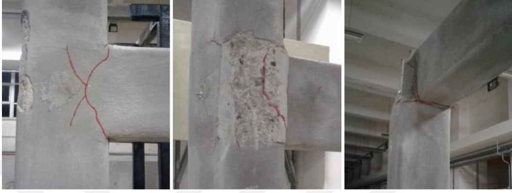
Şekil 2.49. Çerçeveye verilen bazı hasarlar (Altunışık ve diğ., 2018)
