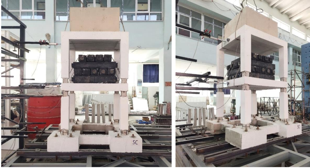
Şekil 3.59. SC numunesinin hasarlı durumunun deneyi
