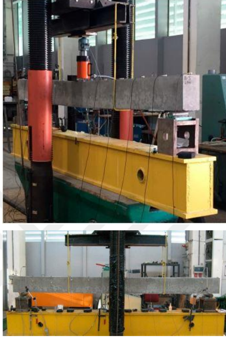
Şekil 2.59. Deney düzenekleri; Statik (üstte), Dinamik (altta)
