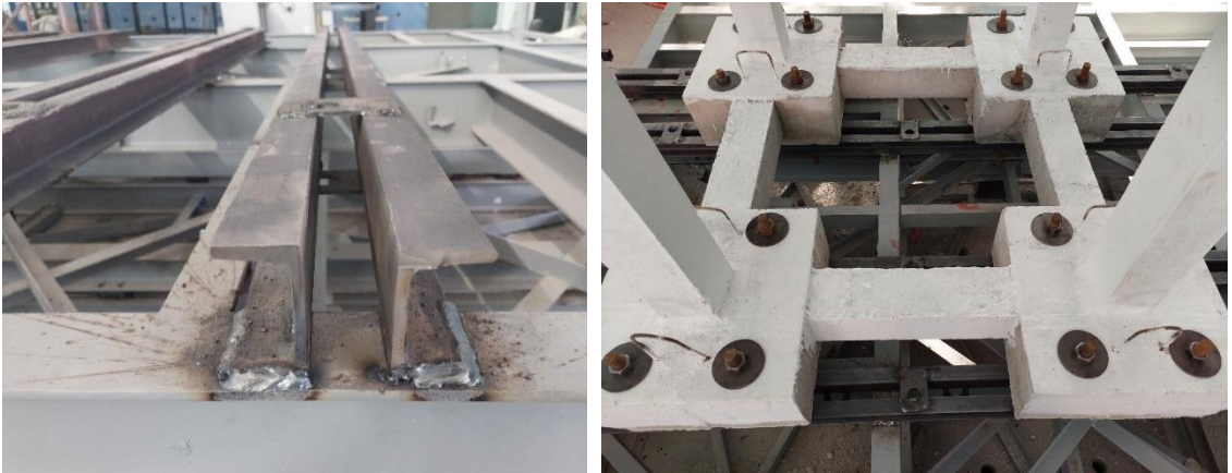
Şekil 3.29. Çerçevelerin sarsma tablasına sabitlendiği ankastre mesnet sistemi
