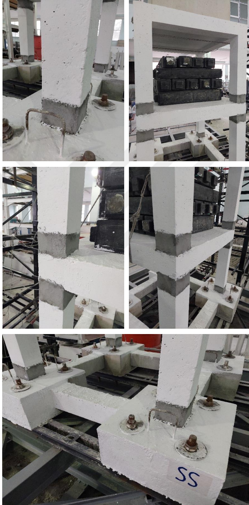
Şekil 4.7. SS numunesinin onarılmış durum deneyleri sonrasında detay görünüşleri
