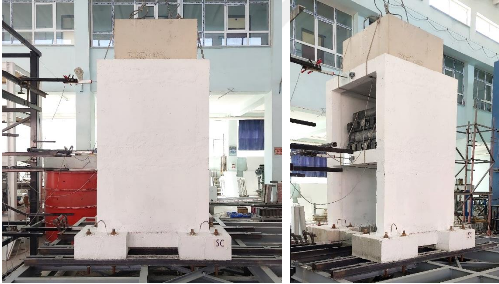
Şekil 3.65. SC numunesinin betonarme perdelerle güçlendirilmiş durumunun deneyi
