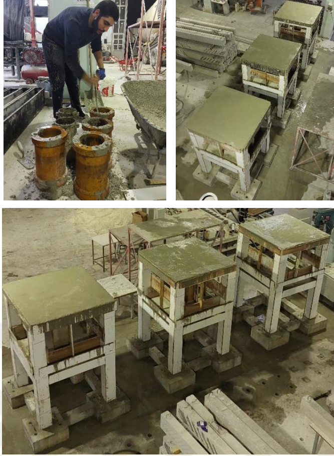
Şekil 3.24. 2. kat beton dökümü (devamı)
