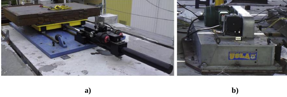
Şekil 2.9. Sarsıcılar; a) Hidrolik lineer sarsıcı, b) Eksantrik kütle sarsıcı (Shin ve diğ., 2016)
