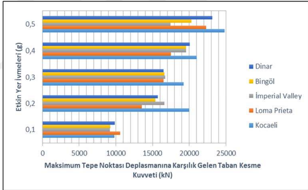
Şekil 4.64. X yönünde farklı ivmelere göre ölçeklendirilen deprem kayıtları için maksimum deplasmana karşılık gelen taban kesme kuvvetleri
