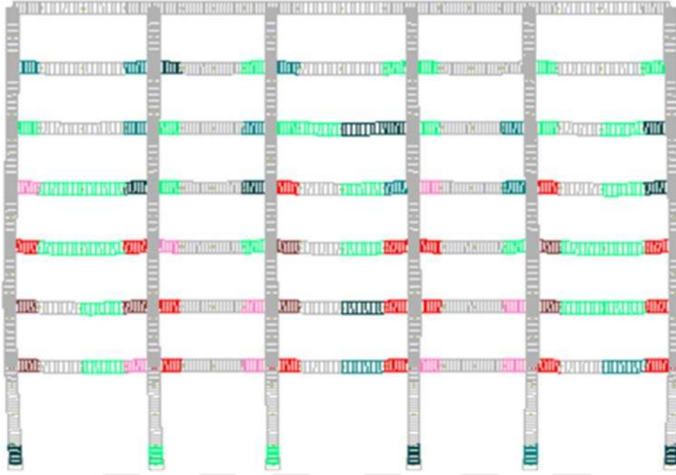
Şekil 4.50. 0.3g'ye göre ölçeklenen Kocaeli deprem kaydından elde edilen hasarlar
