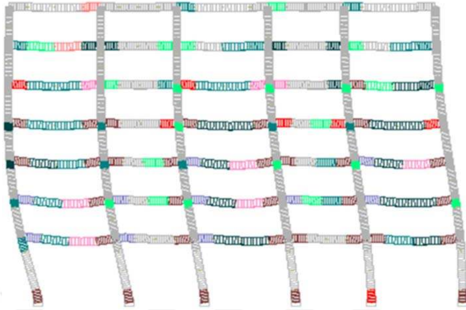
Şekil 4.42. 0.5 g'ye göre ölçeklenen Imperial Valley deprem kaydından elde edilen hasarlar
