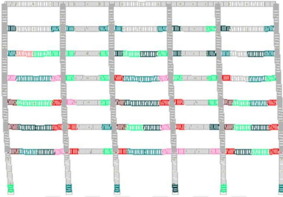
Şekil 4.40. 0.3 g'ye göre ölçeklenen Imperial Valley deprem kaydından elde edilen hasarlar
