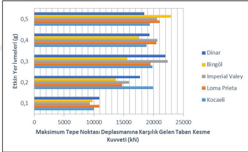
Şekil 4.70. Y yönünde farklı ivmelere göre ölçeklendirilen deprem kayıtları için maksimum deplasmana karşılık gelen taban kesme kuvvetleri
